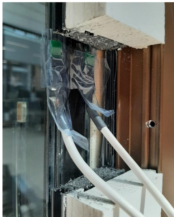
Slika 32. Sonde pričvršćene na rubove stakla
