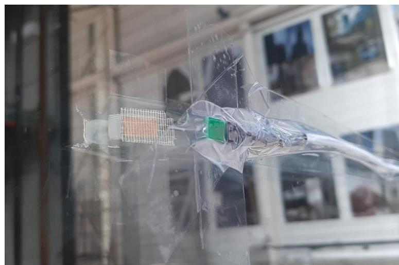
Slika 31. Sonde pričvršćene na plohu stakla i lima
