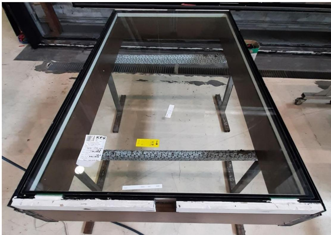
Slika 18. Izolacijsko staklo unutar okvira
