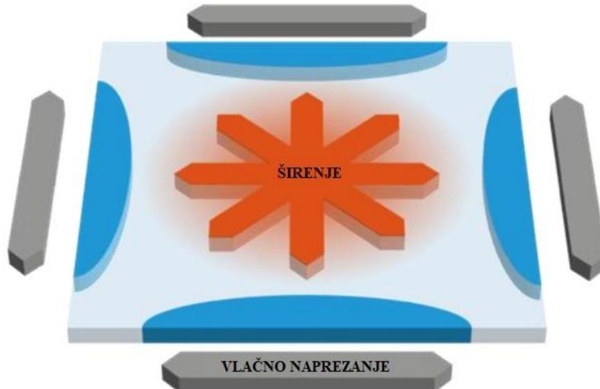
Slika 11. Nastajanje toplinskog naprezanja [14][11]
