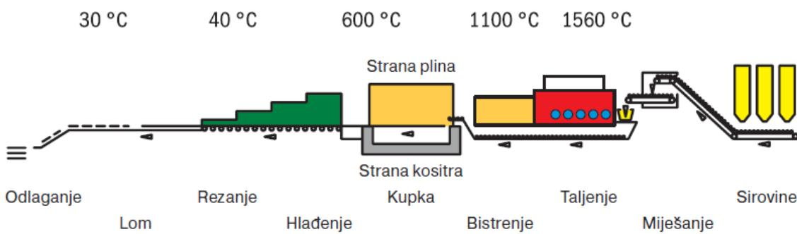
Slika 1. Prikaz proizvodnje stakla *float* postupkom [5]
