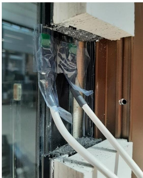
Slika 32. Sonde pričvršćene na rubove stakla
