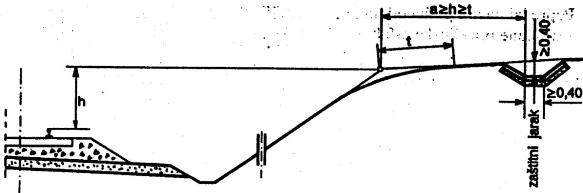
Slika 29. Zaštitni jarak na padini iznad usjeka [8]
