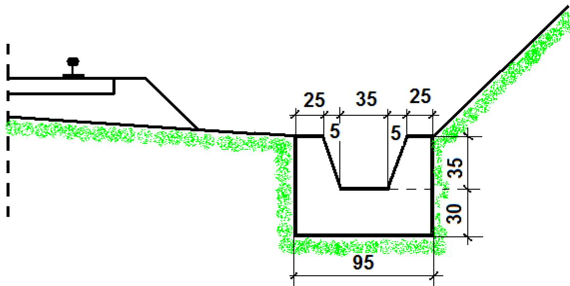
Slika 16. Betonirani zaštitni jarak [2]
