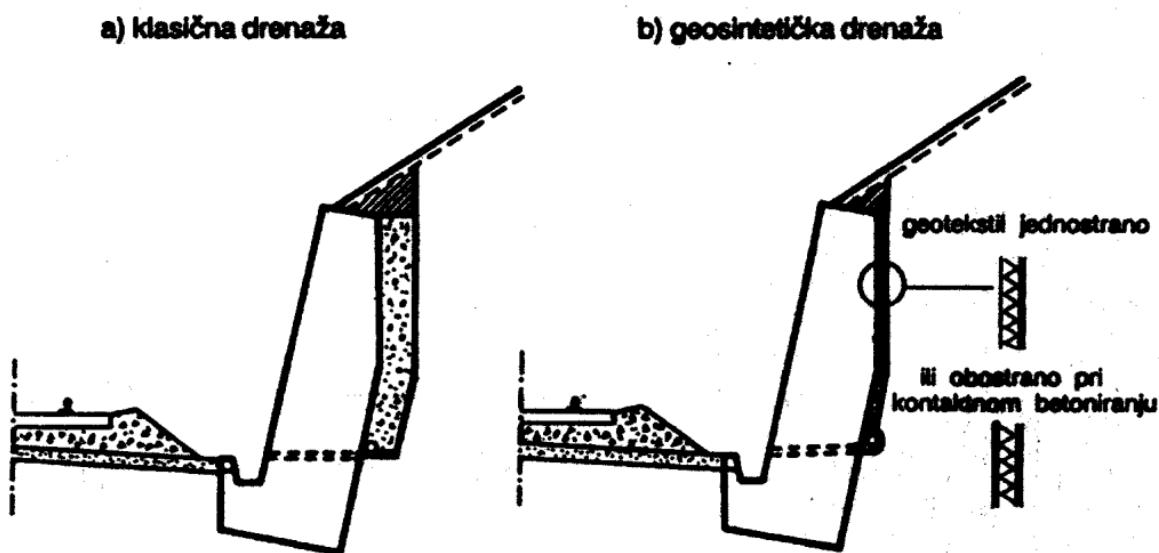
Slika 30. Usporedba klasične i geosintetičke drenaže iz zidova [8]
