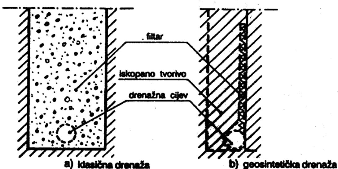
**Slika 31. Usporedba klasične i geosintetičke drenaže [8]**
