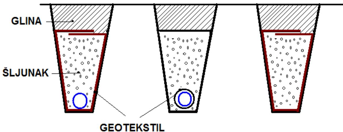
**Slika 35. Načini izvedbe dubokih drenažnih kanala [2]**
