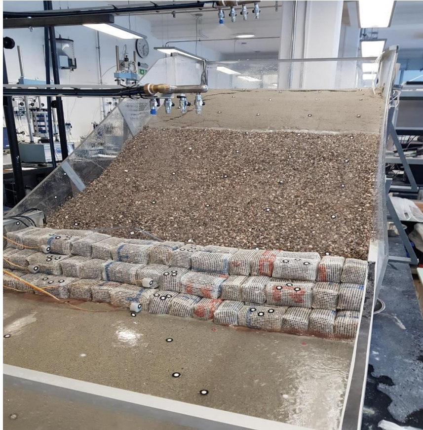
Slika 37: Potpuno potapanje nožice (t=135 min)
