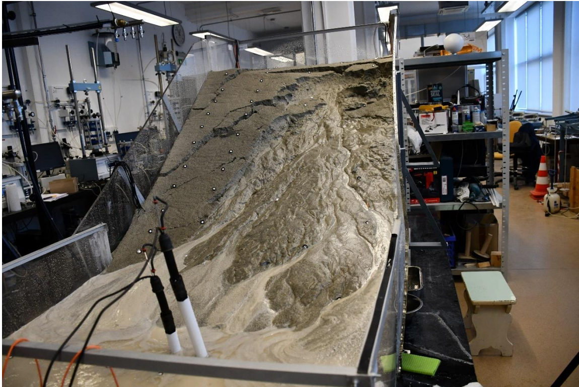
Slika 24: Klizno tijelo i potopljena noica modela bez mjera sanacije
