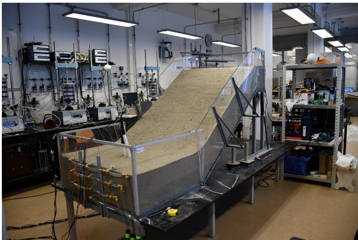
Slika 19: Model bez mjera sanacije prije početka pokusa
