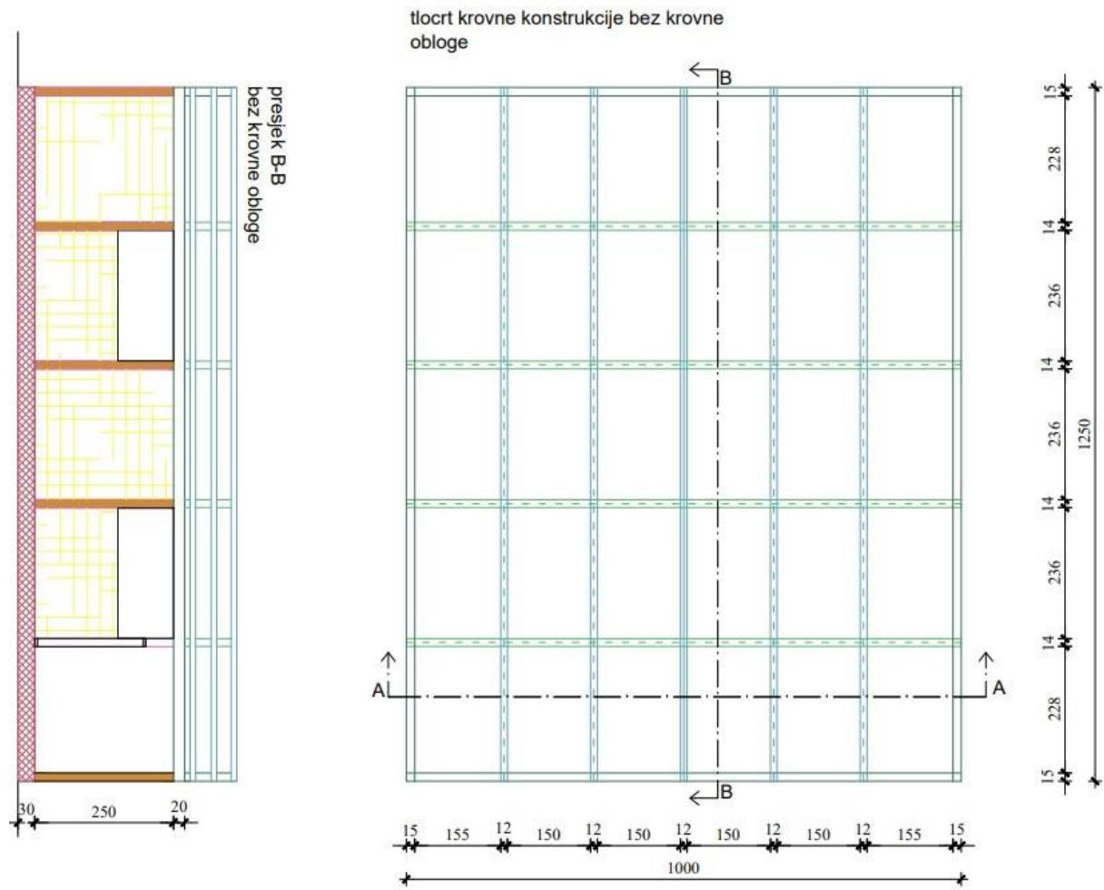
Slika 25: Tlocrt krovišta i uzdužni presjek (izradila autorica)
