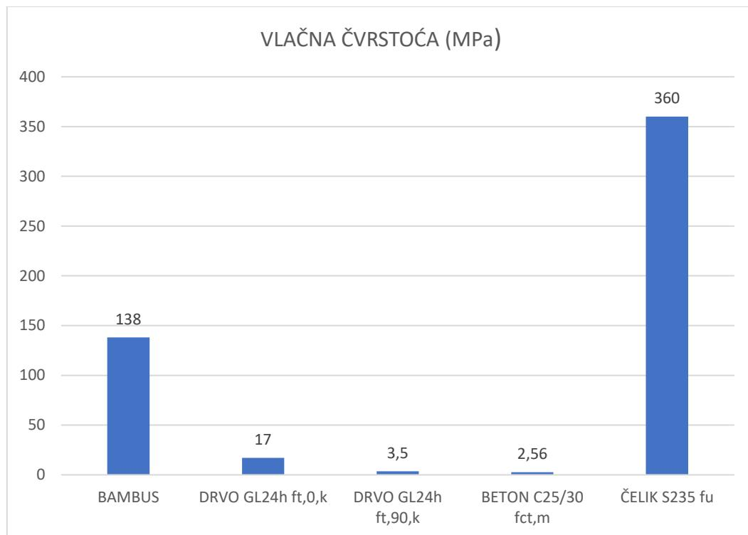
Slika 12: Usporedba vlačnih čvrstoća materijala (izradila autorica)
