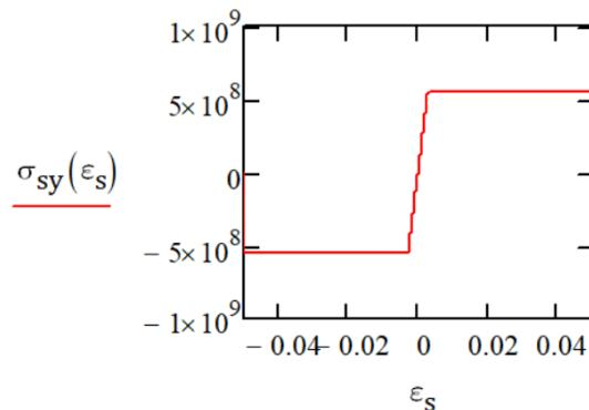
Slika 22. Bilinearni dijagram čelika B500B sa horizontalnom granom
