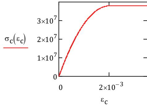
Slika 28. Dijagram neovijenog betona parabola + pravac
