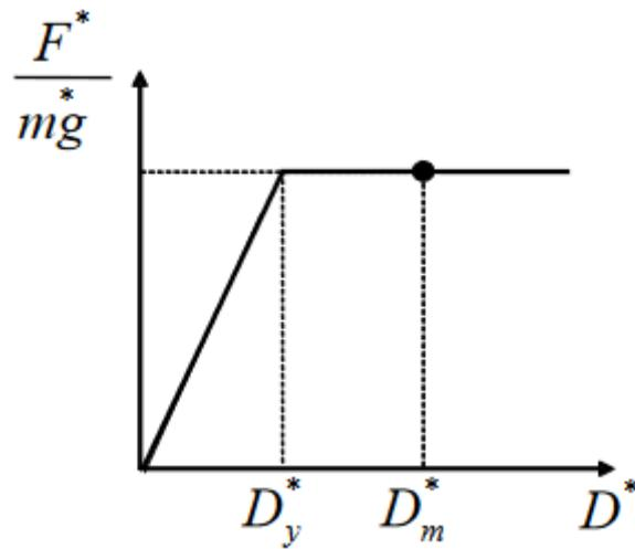
Slika 12. Spektar kapaciteta sustava s jednim stupnjem slobode [5]
