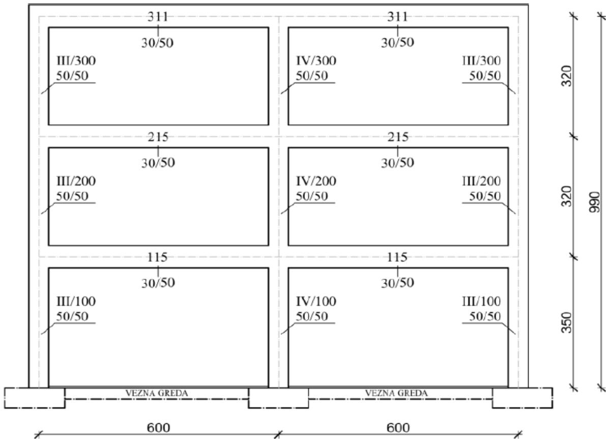
Slika 17. Okvirna armiranobetonska konstrukcija [7]
