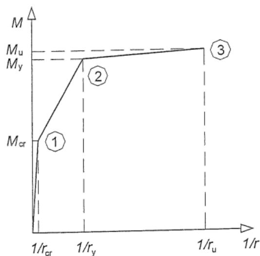
Slika 19. Dijagram moment savijanja – zakrivljenost [8]
