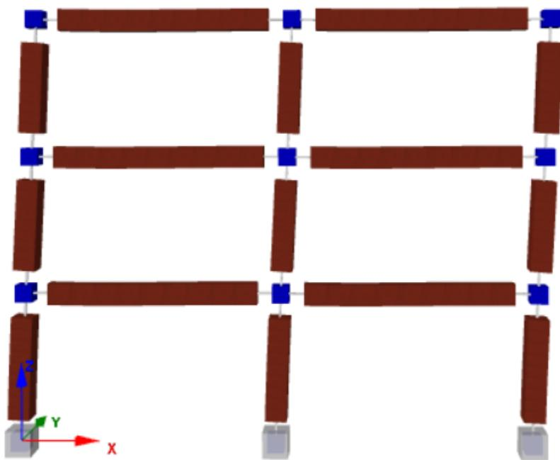
Slika 62. Pomak konstrukcije pri opterećenju 448 kN
