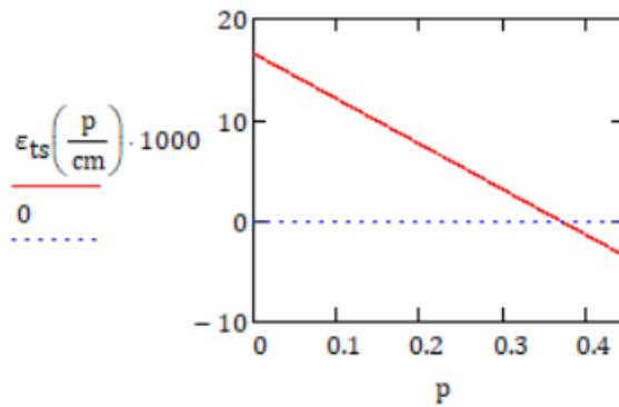
Slika 30. Raspodjela naprezanja pri tlačnom slomu u betonu
