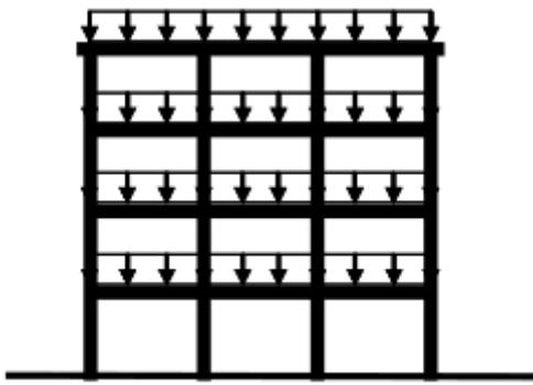
Slika 6. Konstrukcija podvrgnuta stalnim gravitacijskim opterećenjima [5]
