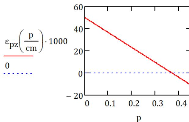
Slika 34. Raspodjela naprezanja pri tlačnom slomu u betonu
