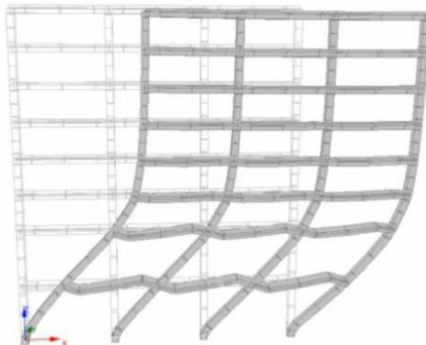
Slika 15. Pomak konstrukcije u trenutku prije formiranja mehanizma [2]
