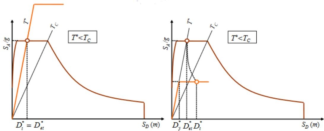
Slika 13. Elastični spektar (smeđe) s obzirom na spektar kapaciteta (narančasto) za zgrade s kratkim periodom osciliranja za slučaj a) (lijevo) i slučaj b) (desno) [5]
