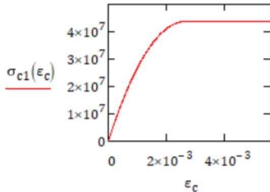
Slika 32. Dijagram ovijenog betona parabola+pravac
