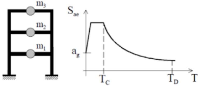
Slika 2. Konstrukcija (lijevo) i elastični spektar odziva ubrzanja (desno) [4]
