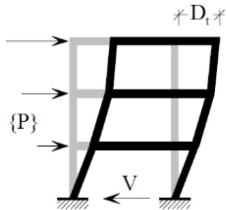
Slika 8. Bočno opterećenje  $\{P\}$ , Poprečna sila u podnožju  $V$  i kontrolni pomak  $D_t$  [4]
