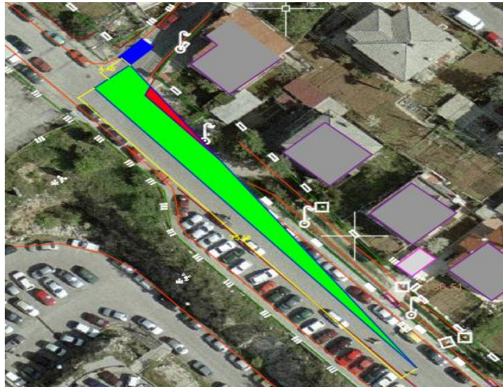
Slika 42: Duljina preglednosti za skretače u desno prema US normi
