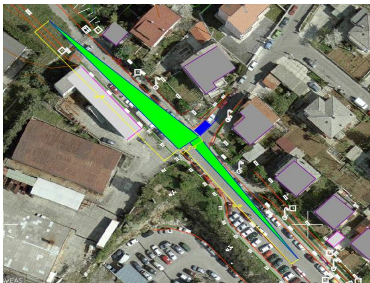
Slika 41: Duljina preglednosti za skretače u lijevo prema HR normi
