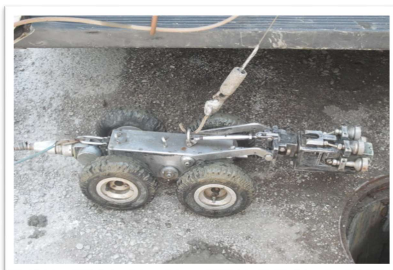
Slika 7 : Robot kamera na daljinsko upravljanje [10]
