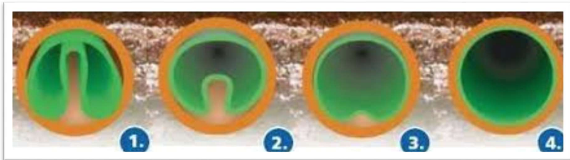
Slika 21 : Postupak ugradnje nove cijevi [5]
