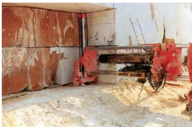
Slika 4. Izvedba iskopa rezanjem stijene [3]
