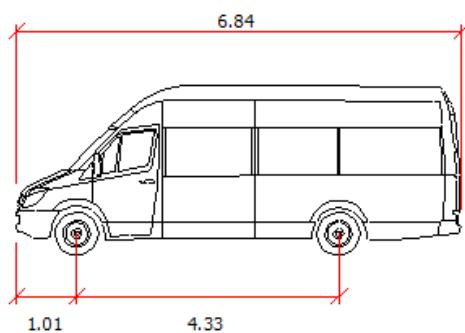
Slika 34. Mjerodavno vozilo – dostavno vozilo (FGSV 2020 (DE)) [9]
