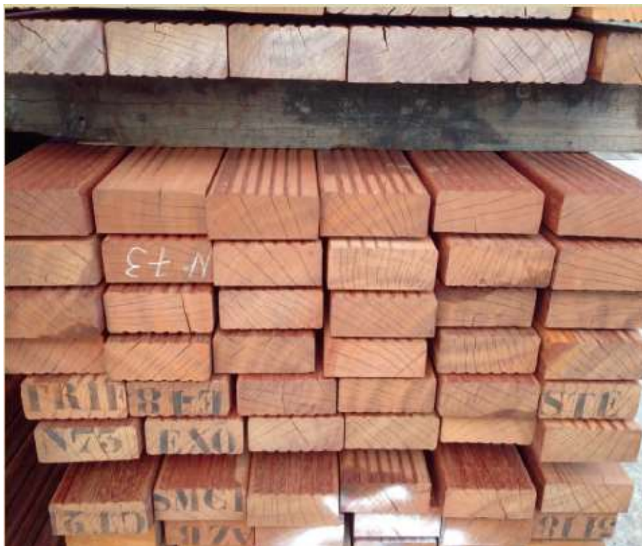
Slika 41: Drvene podnice bongosa (tzv. azobé) [3]
