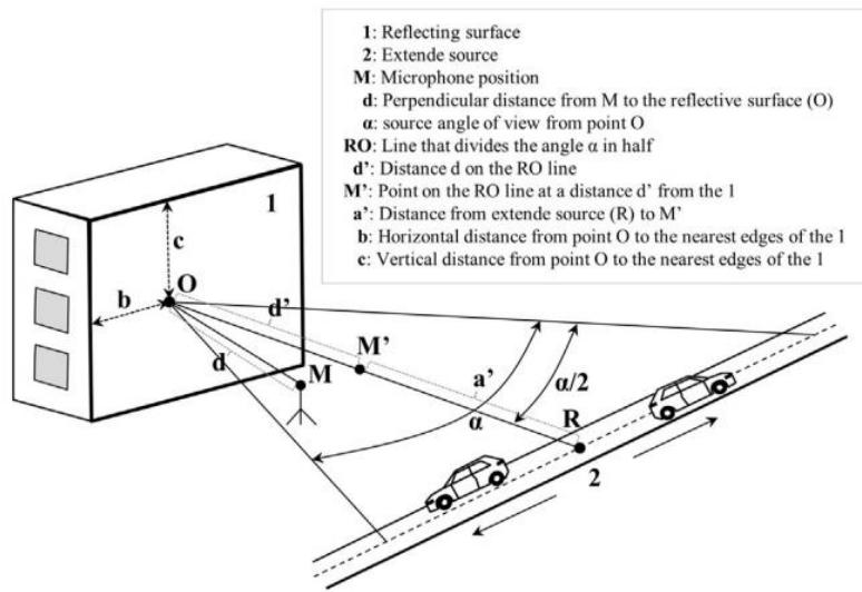
Slika 7: Mikrofon u blizini reflektirajuće površine [10]
