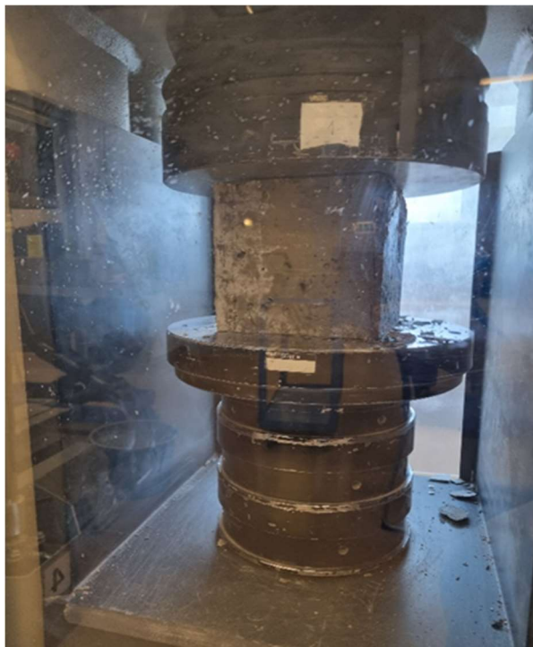
Slika 8: Ispitivanje tlačne čvrstoće na uzorcima (izvor: vlastita fotografija)
