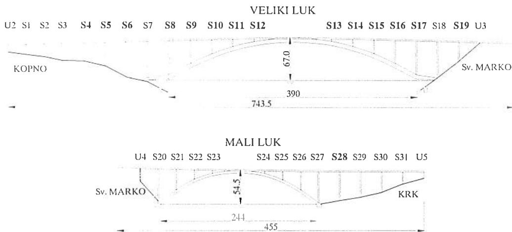
Slika 1. Raspored saniranih priležajnih mjesta na Krčkom mostu
