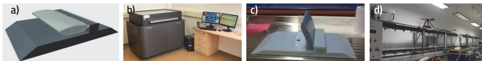
Slika 5. Od izrade do ispitivanja fizikalnog modela pregrade na Neretvi: a) digitalni model; b) izrada modela u 3D printeru; c) fizikalni model; d) modelsko ispitivanje
