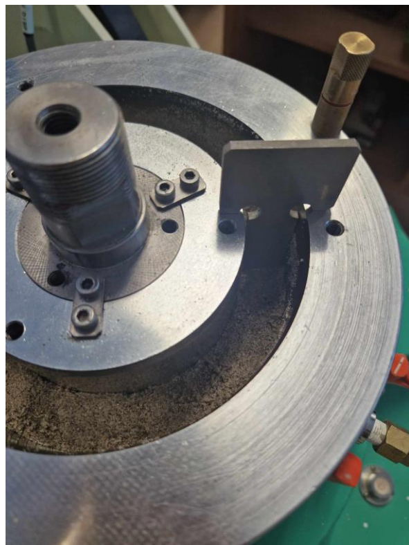
Slika 10. Postupak izravnavanja uzorka nožićem
