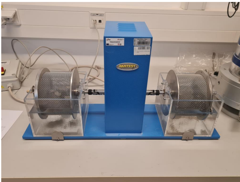
Slika 13. Uređaj za određivanje postojanosti stijene (eng. Slake Durability Test, SDT)
