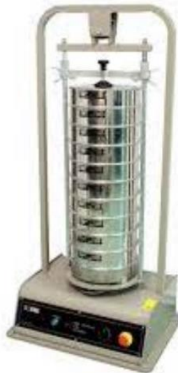
Slika 14. Uređaj za prosijavanje (Jagodnik, 2023)
