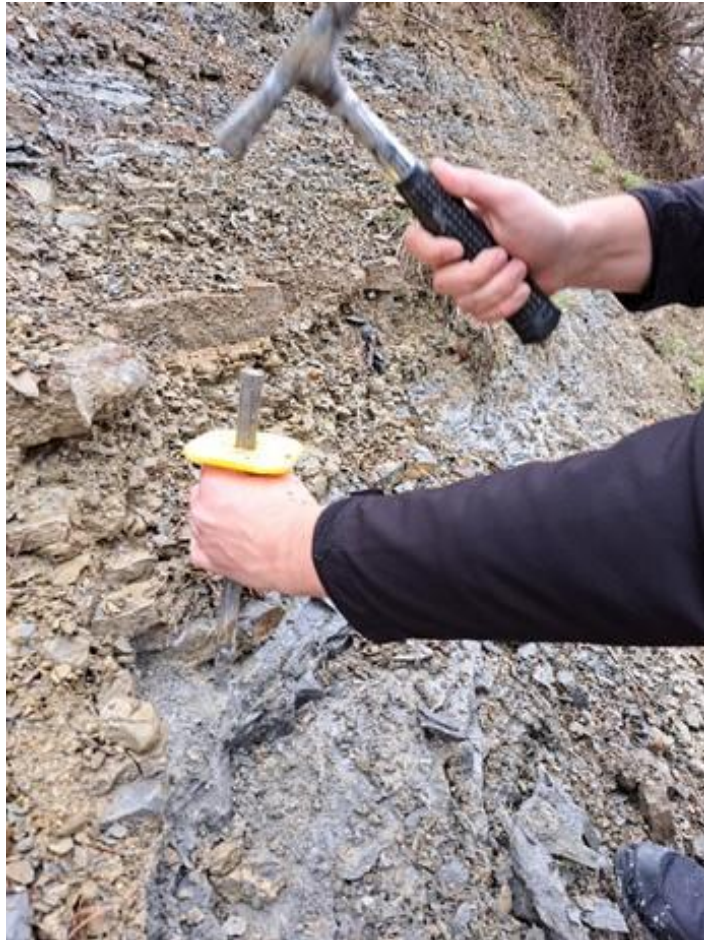
Slika 10. Uzimanje uzoraka za laboratorijsko ispitivanje s kosine.
