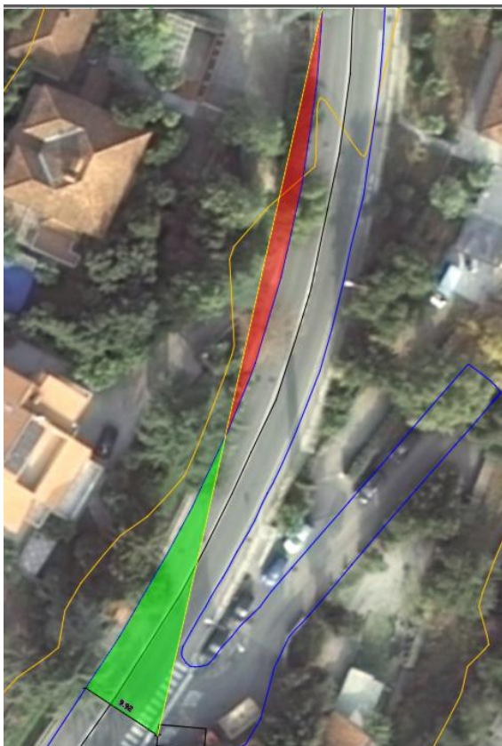
Slika 39. Grafički prikaz preglednosti za raskrižje 3 za lijevo skretanje (iz privoza 2 u privoz 1) [14]
