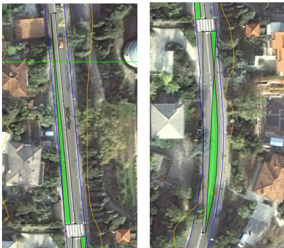
Slika 53. Grafički prikaz zaustavne preglednosti za pješački prijelaz 6 [14]
