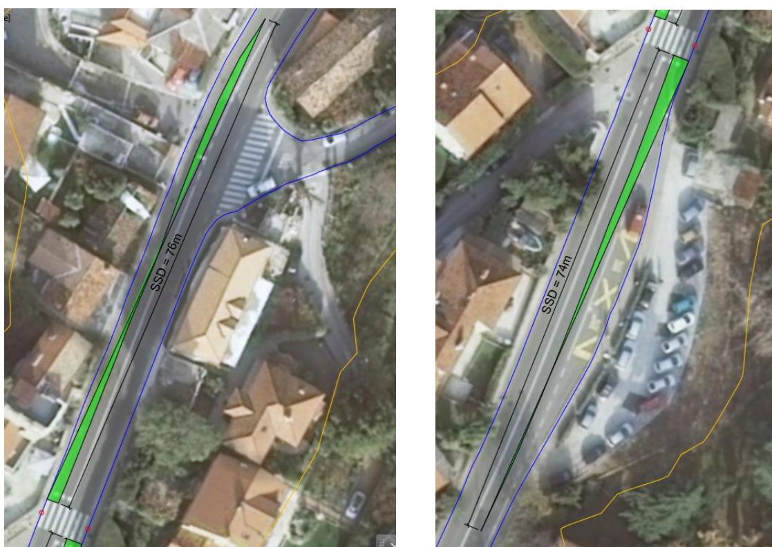
Slika 50. Grafički prikaz zaustavne preglednosti za pješački prijelaz 3 [14]
