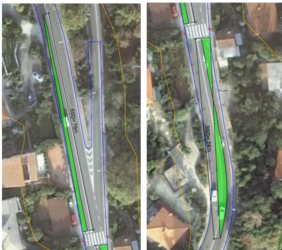
Slika 51. Grafički prikaz zaustavne preglednosti za pješački prijelaz 4 [14]
