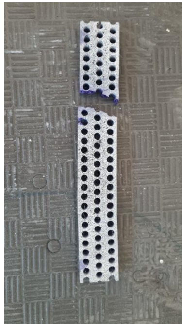
Slika 57: Puknuti uzorak B3 LMD sa 15% ispune
