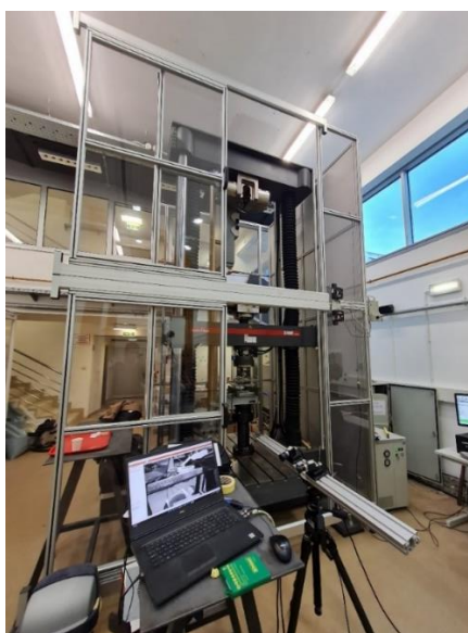
Slika 20: Kidalica Zwick/Roell Z600 u laboratoriju za konstrukcije
