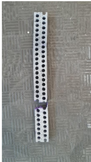
Slika 45: Puknuti uzorak B2 LMD sa 15% ispune
