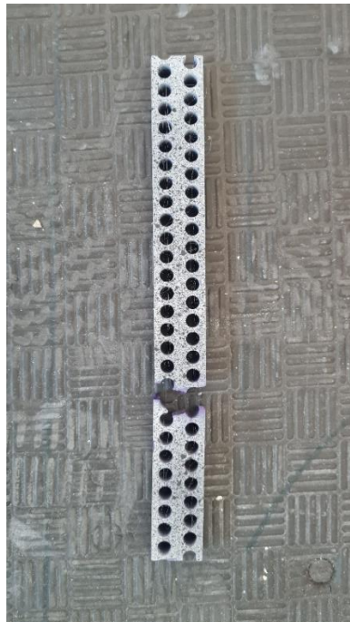
Slika 39: Puknuti uzorak B2 LMD
