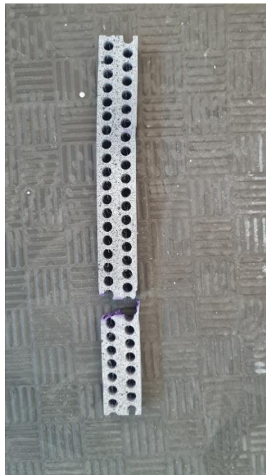
Slika 45: Puknuti uzorak B2 LMD sa 15% ispune
