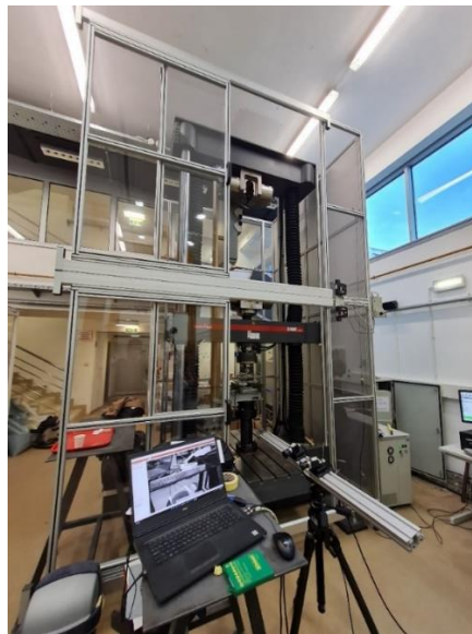
Slika 20: Kidalica Zwick/Roell Z600 u laboratoriju za konstrukcije
