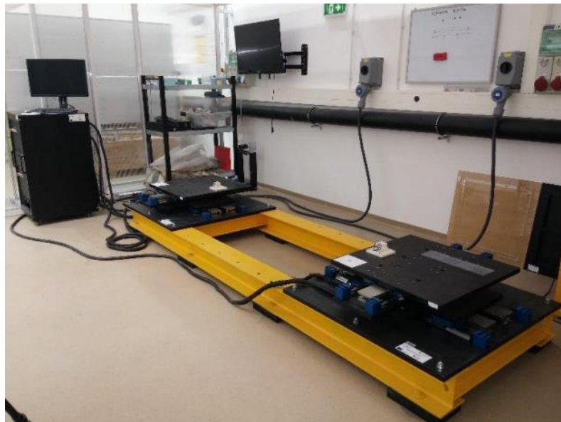
Slika 12 : Potresna platforma Quanser STI – III [8]
