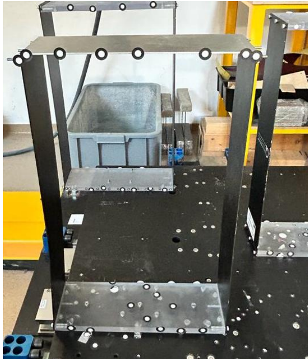
Slika 15 : Jednokatni model sa deformabilnom pločom
