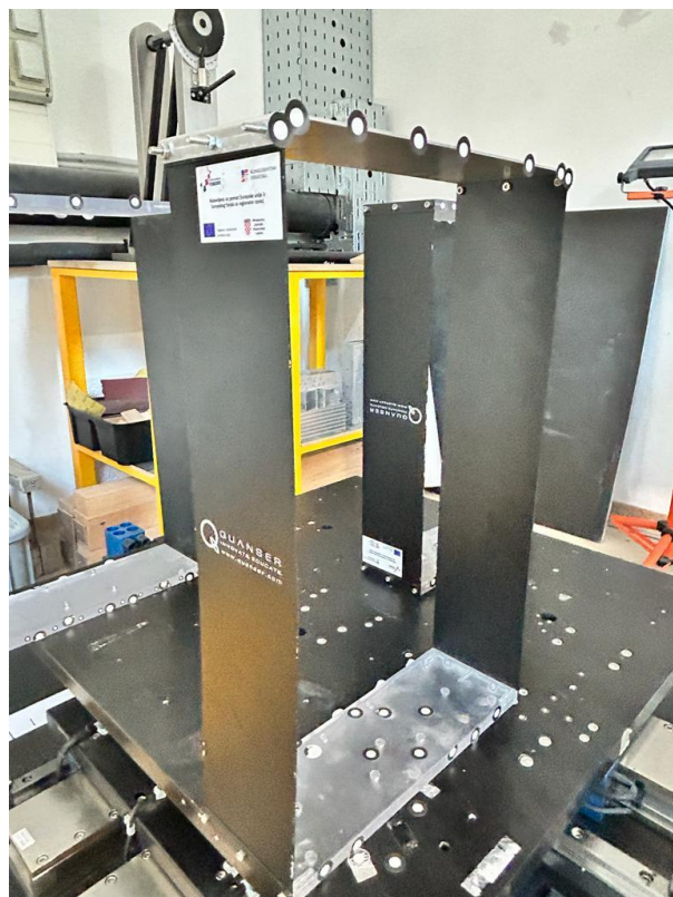
Slika 16 : Jednokatni model sa deformabilnom pločom
