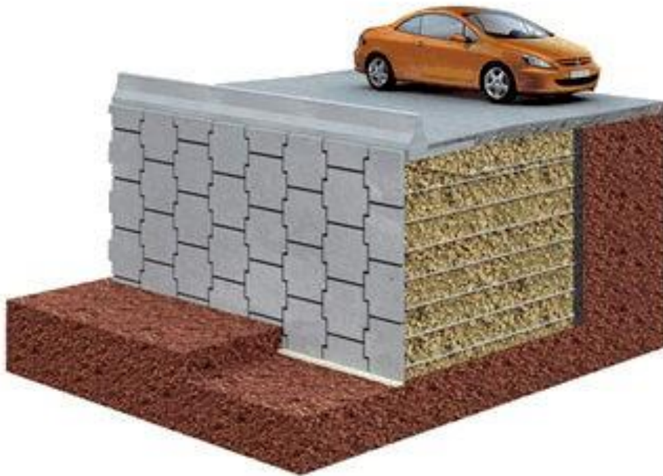
Slika 25. Shema potpornog sustava Terra arme [24]
