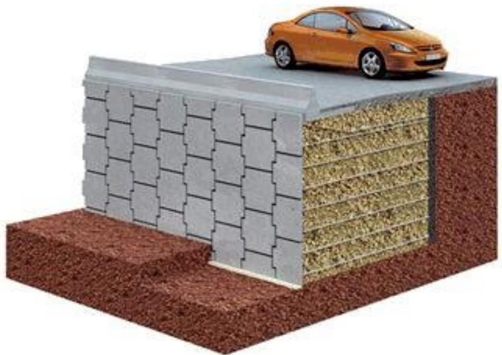
Slika 25. Shema potpornog sustava Terra arme [24]
