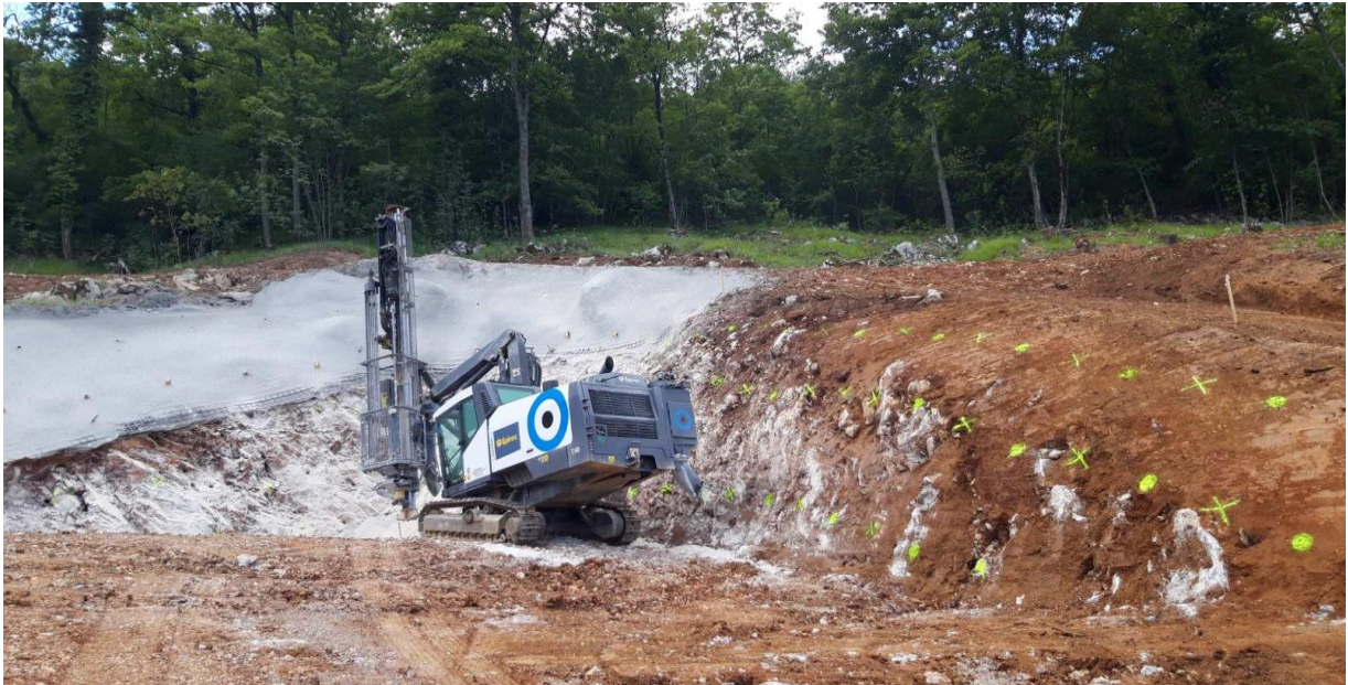
Slika 32. prikazuje minersku bušilicu Epiroc
