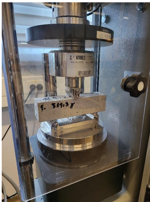
Slika 22. Ispitivanje vlačne čvrstoće savijanjem
