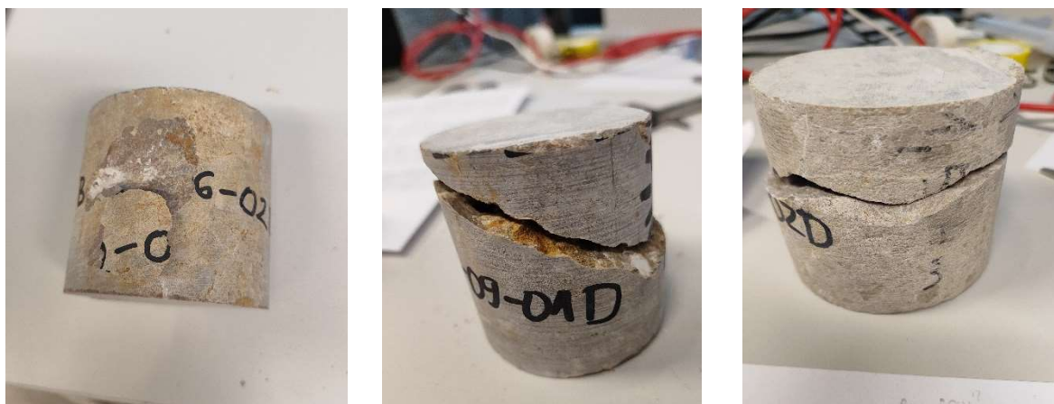
Slika 26: Nepravilni lomovi uzoraka u dijametralnom ispitivanju
