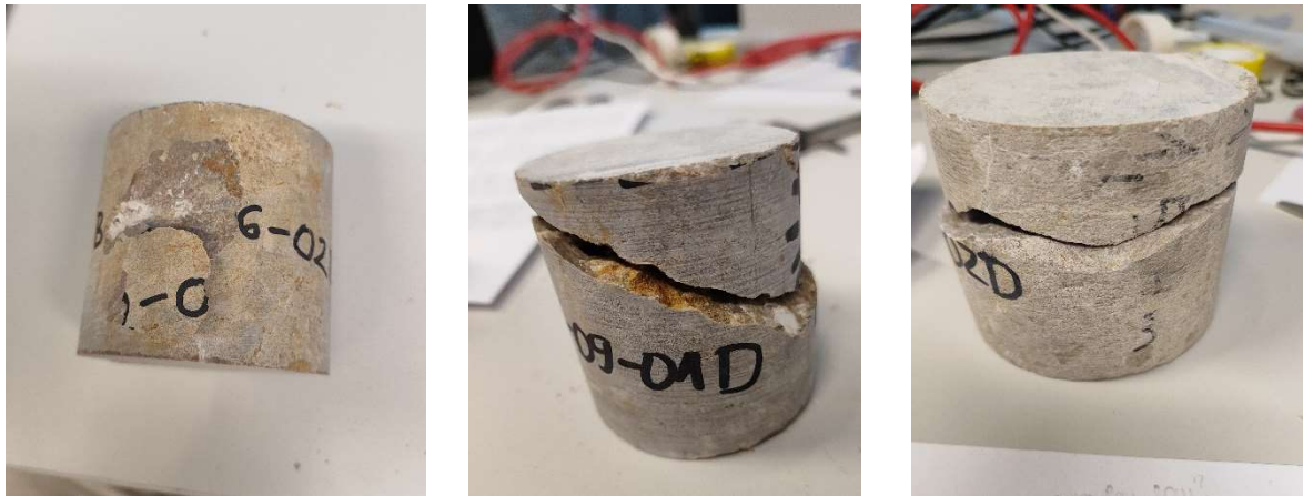
Slika 26: Nepravilni lomovi uzoraka u dijametralnom ispitivanju
