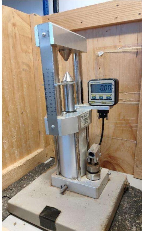
Slika 11: Uređaj za PLT ispitivanje u Laboratoriju za geotehniku Građevinskog fakulteta u Rijeci
