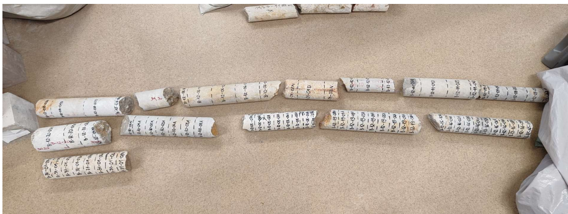
Slika 25: Označavanje i iscertavanje uzoraka
