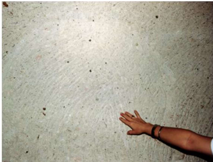
Slika 1: Prikaz intaktne stijene, vulkanskog tufa, na makroskopskoj razini [2]
