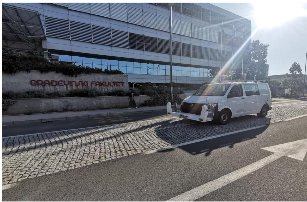
Slika 16. Mjerno vozilo i laserski sustav za snimanje stanja ceste
