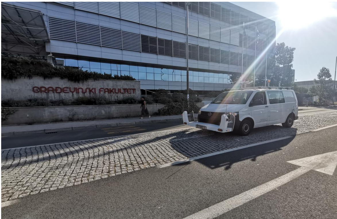
Slika 16. Mjerno vozilo i laserski sustav za snimanje stanja ceste
