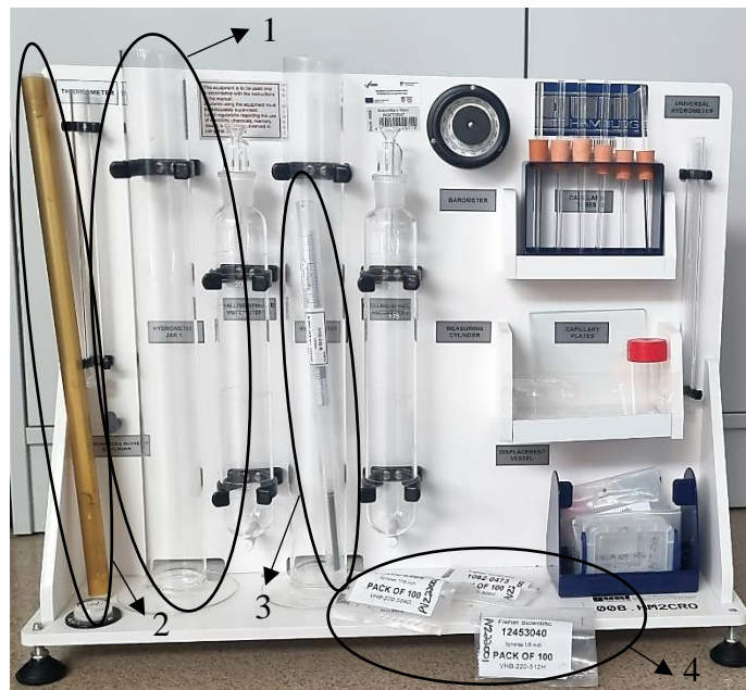
Slika 25. Fizikalni model 008.HM2CRO; 1. menzura, 2. živin termometar, 3. univerzalni hidrometar, 4. čelične kuglice (1/8 inča, 3/32 inča, 1/16 inča)
