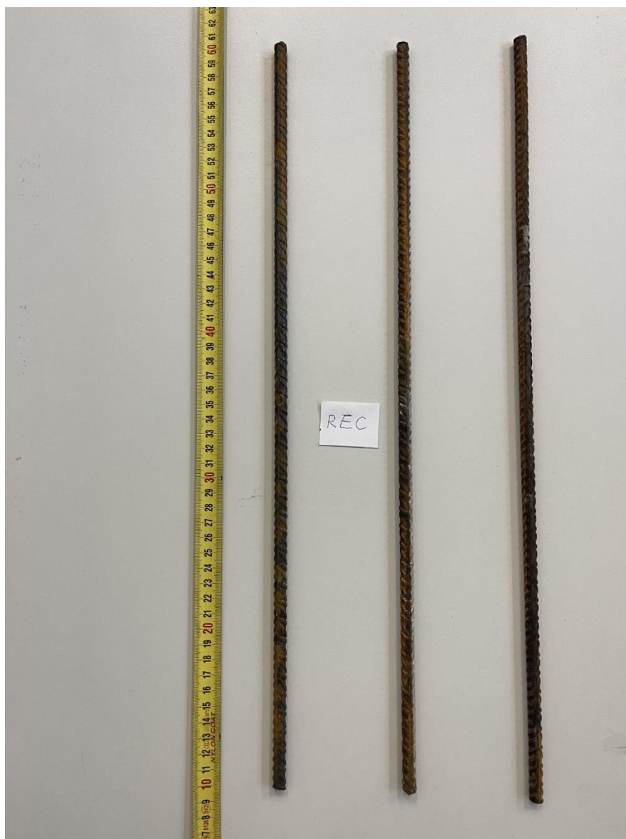
Slika 19 Uzorci prije vlačnog ispitivanja na preporučenim brzinama
