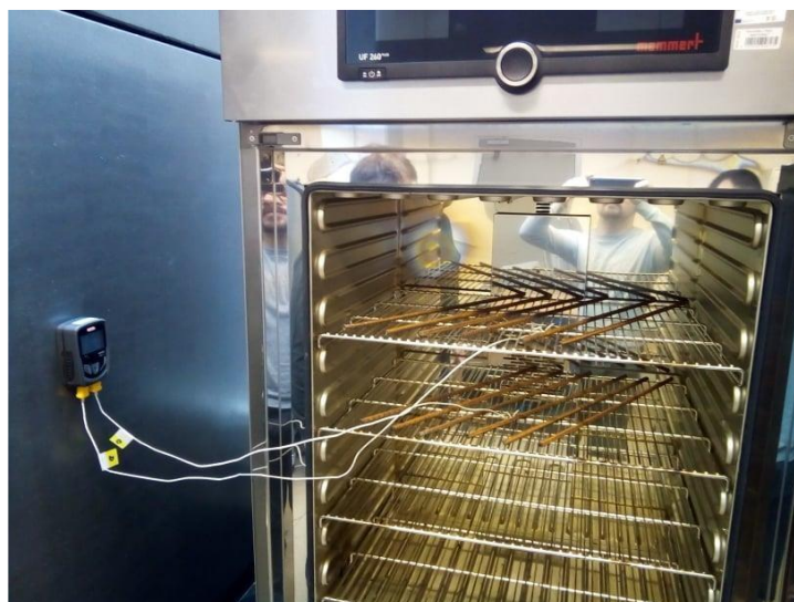
Slika 8 Sonde koje bilježe temperaturu unutar samog sušionika
