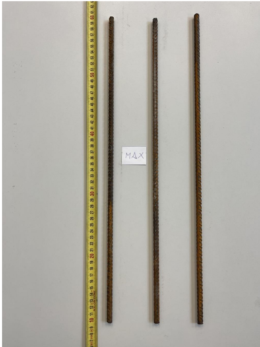
Slika 26 Uzorci nakon vlačnog ispitivanja na maksimalnim brzinama
