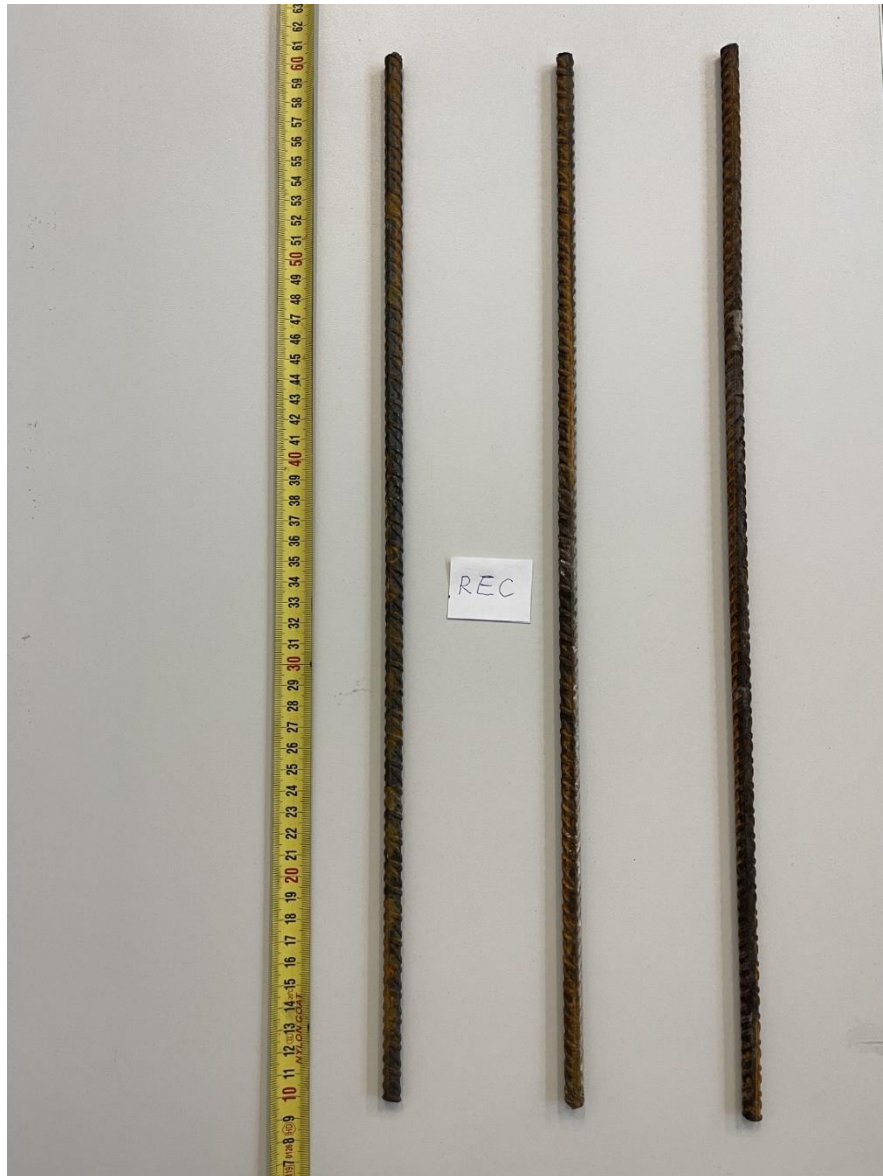
Slika 19 Uzorci prije vlačnog ispitivanja na preporučenim brzinama
