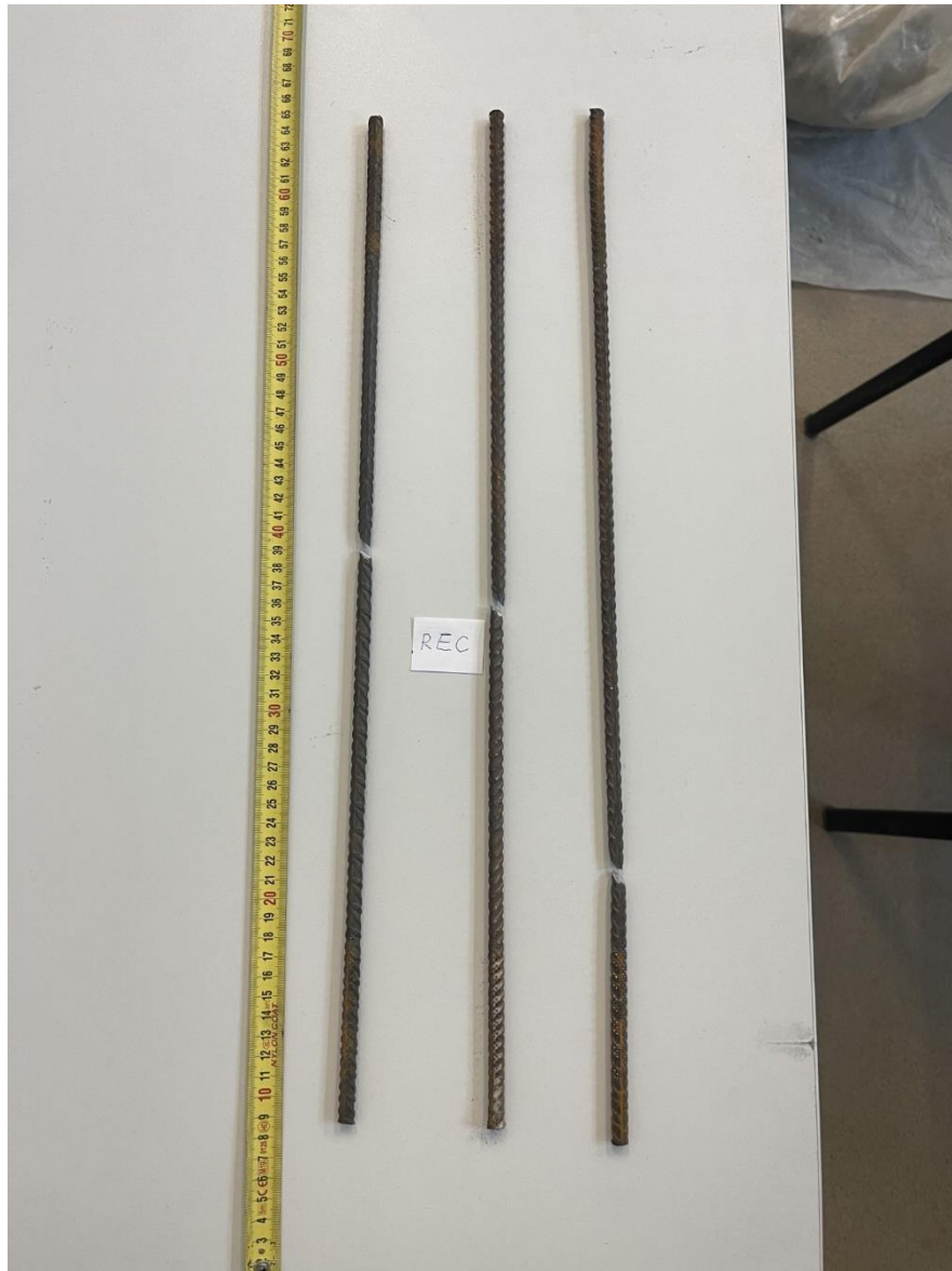
Slika 20 Uzorci nakon vlačnog ispitivanja na preporučenim brzinama
