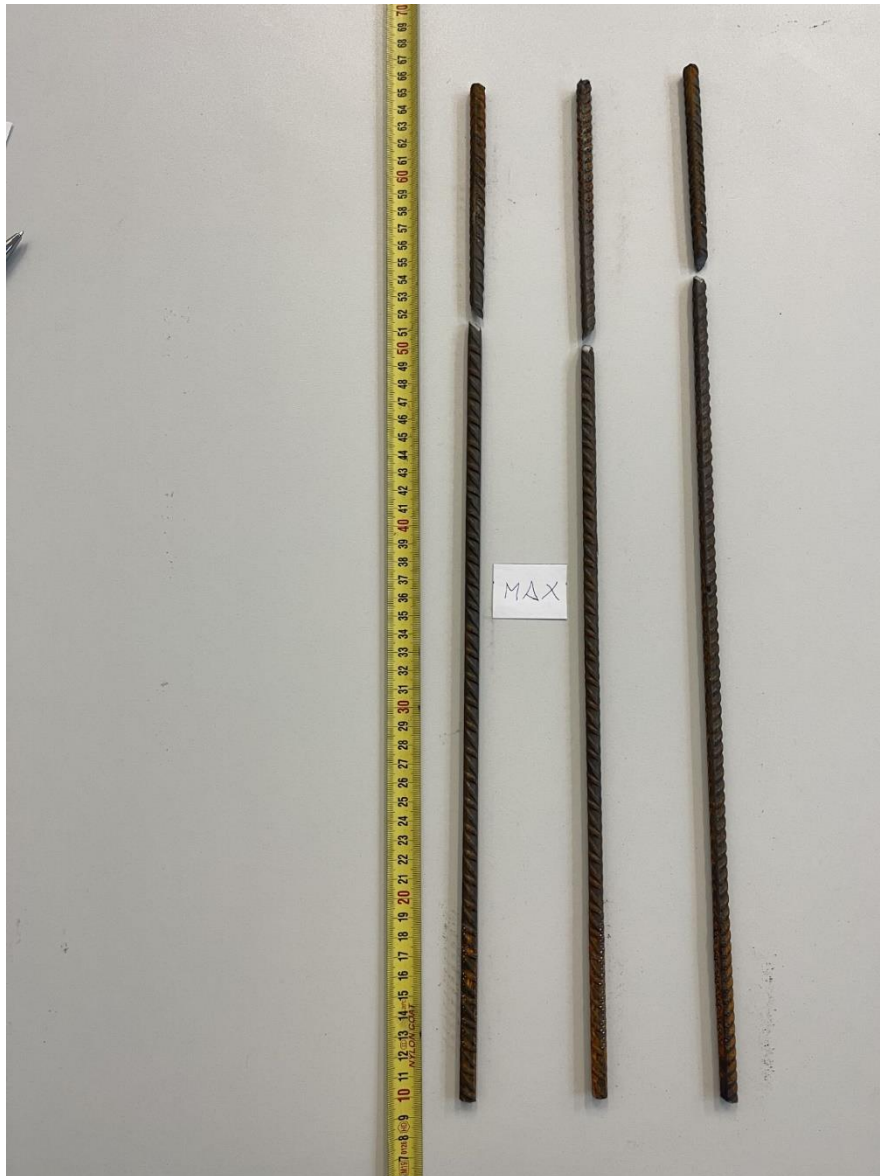
Slika 27 Uzorci nakon vlačnog ispitivanja na maksimalnim brzinama
