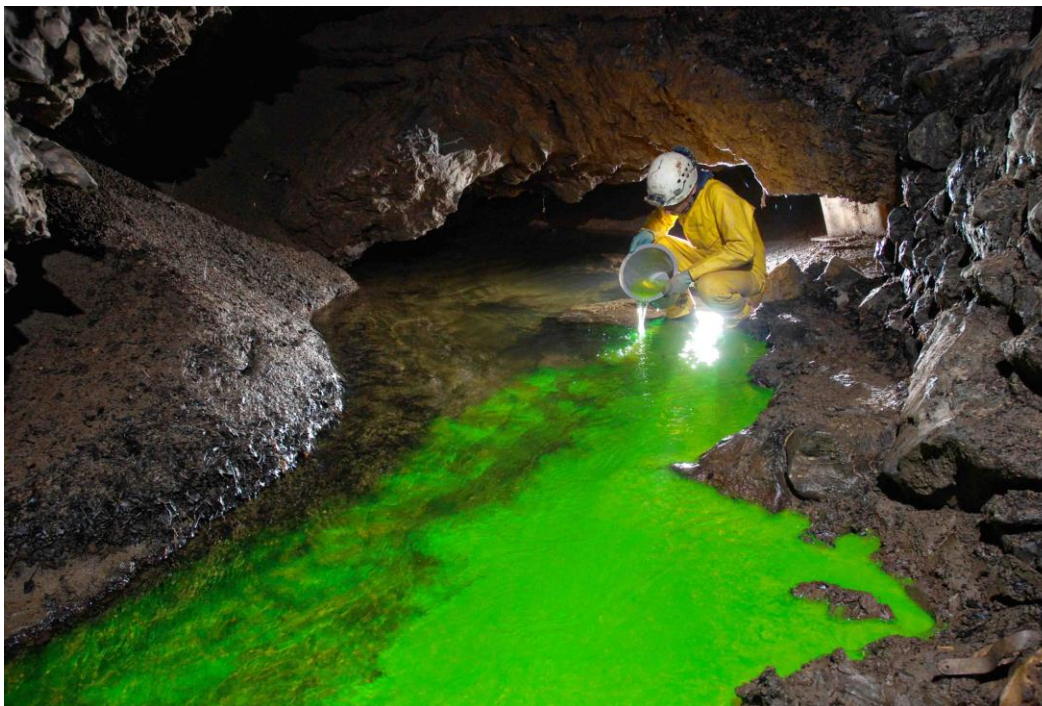
Slika 28: Ubacivanje traseru u podzemne vode [24]
