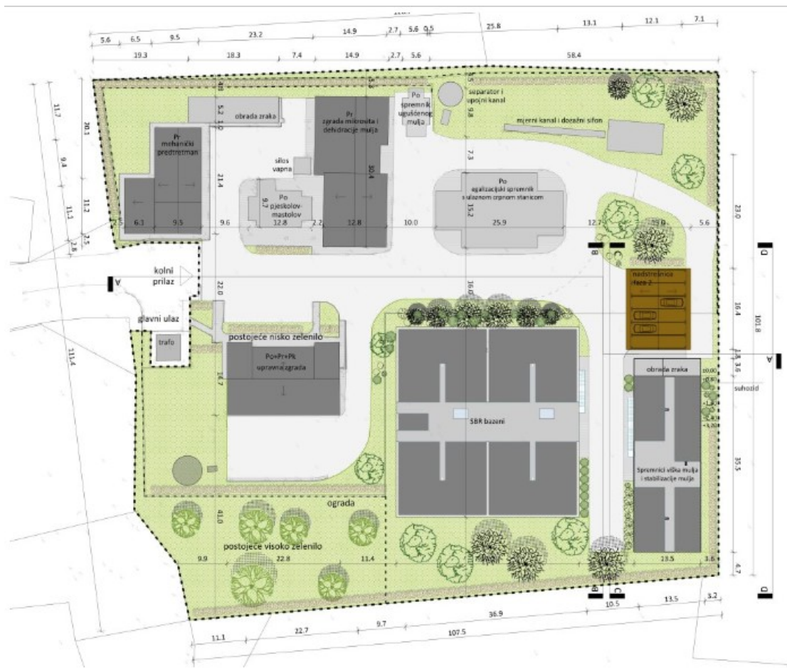
Slika 16. Tlocrtni prikaz postrojenja za pročišćavanje otpadnih voda [6]
