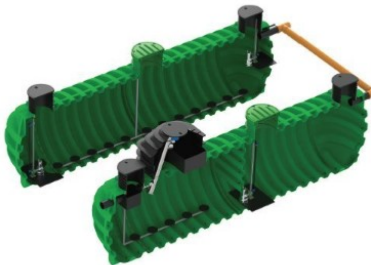
Slika 18. Presjek Bio pročišćivača Roclean [14]
