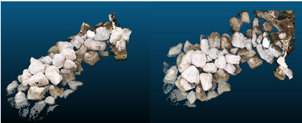
Slika 40 Prikaz oblaka točkaka lukobrana u programu CloudCompare snimljenog dronom
