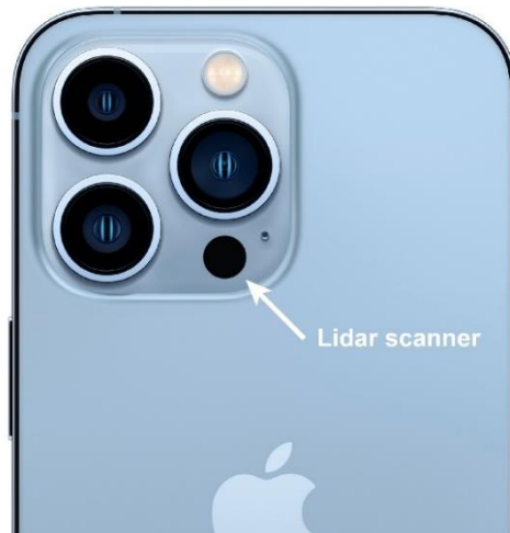
Slika 27 LiDAR uređaja iPhone 13 Pro
