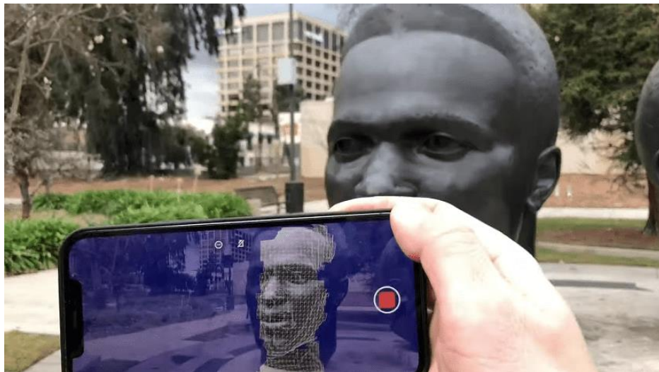
Slika 21 LiDAR skeniranje iPhone uređajem ( https://surveyinggroup.com/ )
