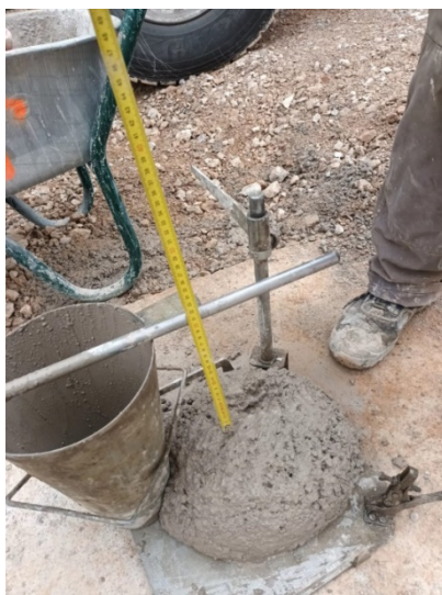
Slika 28. Primjer mjerenja konzistencije svježeg betona (autor)
