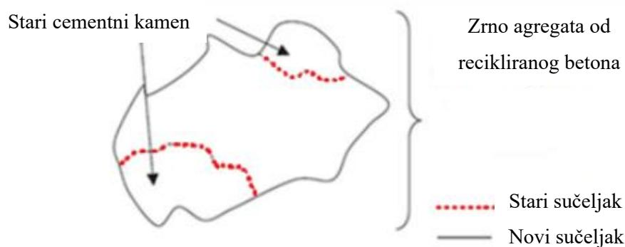
Slika 1: Zone sučeljaka recikliranog betonskog agregata
