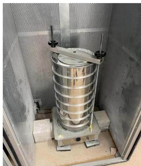
Slika 25: Sita u uređaju za prosijavanje
