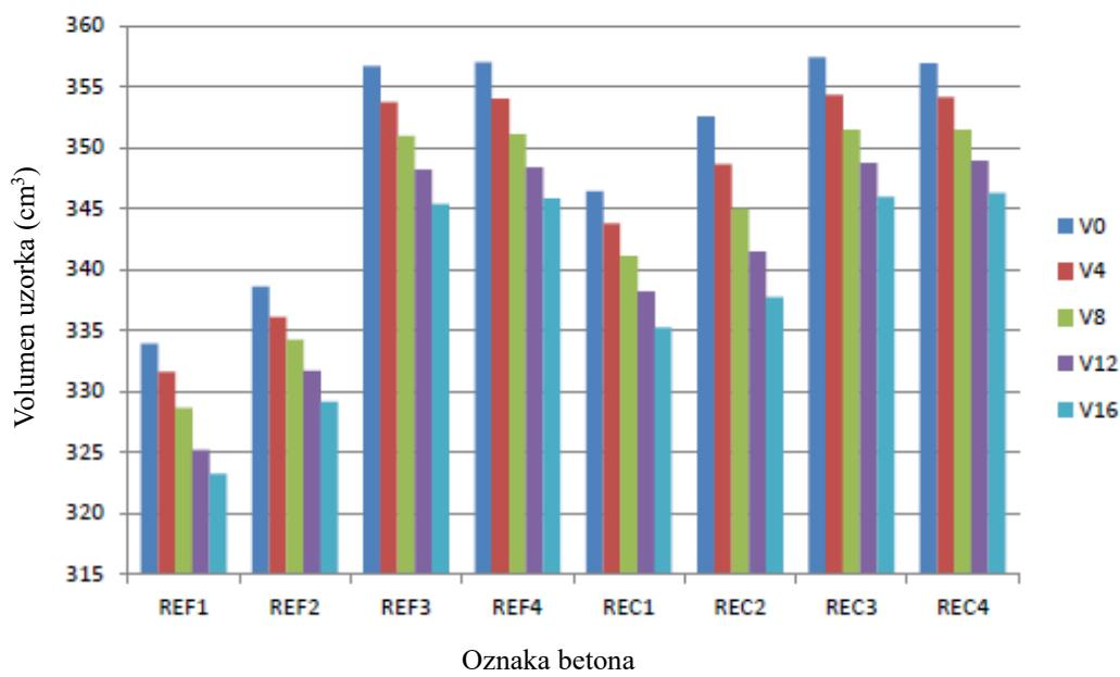
Slika 10: Abrazija uzorka ovisno o udjelu recikliranog agregata i broju rotacija
