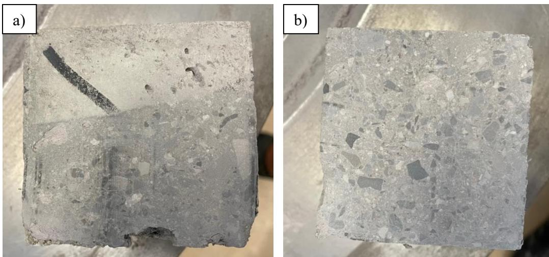
Slika 20: Istrošeni uzorak uslijed habanja.
