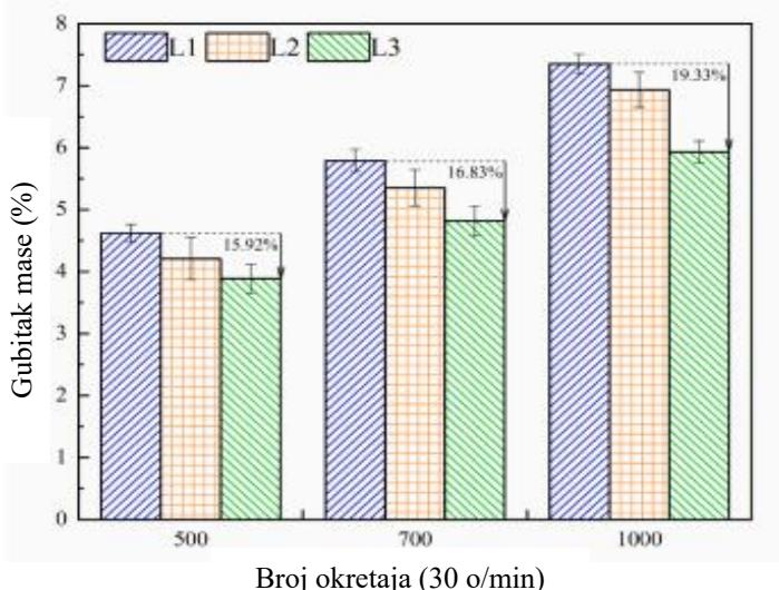
Slika 9: Otpornost na habanje ovisno o duljini PE vlakana
