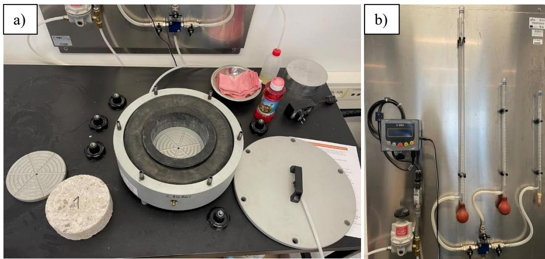
Slika 11: Aparatura za provođenje pokusa. a) Prazna zračna komora, gumeni zračnici, poklopac i vijci b) Digitalni manometar, ventilni sistem i mjerači protoka (Autor: Matija Budić)
