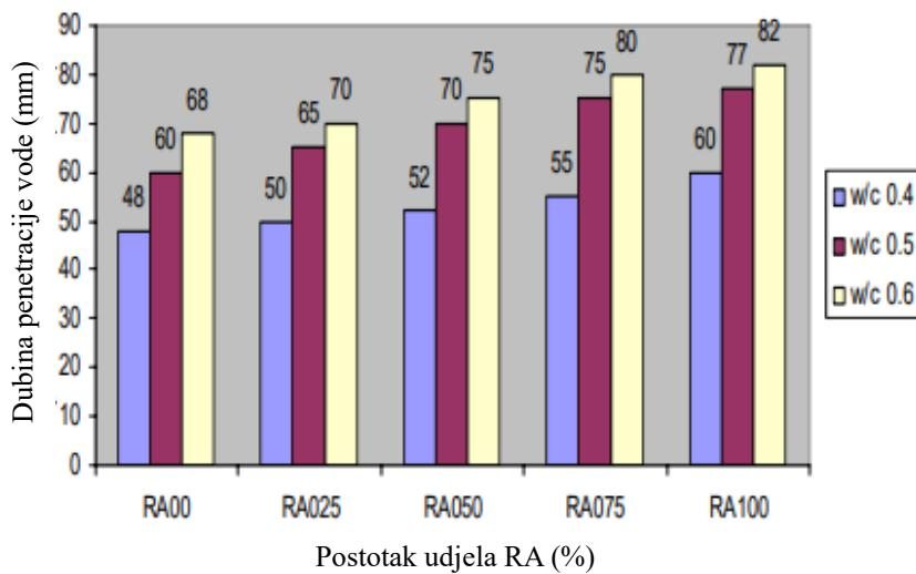
Slika 7: Dubina penetracije vode ispitana VDP uređajem
