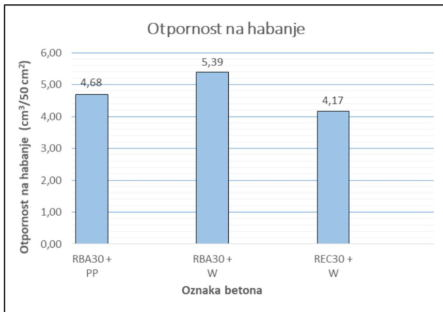
Slika 38: Usporedba rezultata ispitivanja otpornost na habanje
