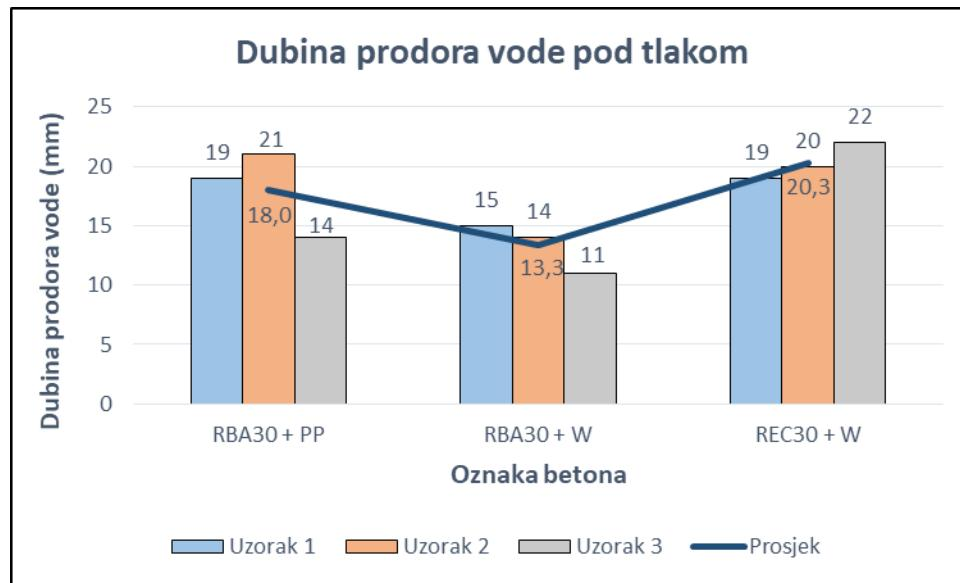
Slika 36: Usporedba rezultata ispitivanja dubine prodora vode pod tlakom
