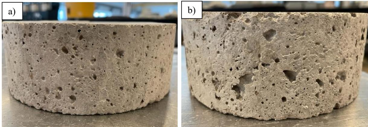
Slika 33: Prikaz poroznosti uzoraka. a) Mješavina RBA30+W b) Mješavina REC30+W
