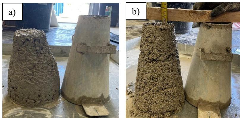
Slika 31: Ispitivanje slijeganja betona. a) Mješavina RBA30+PP b) Mješavina REC30+W
