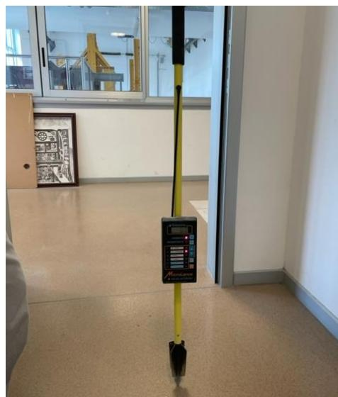
Slika 28: Instrument za ispitivanje vlažnosti agregata
