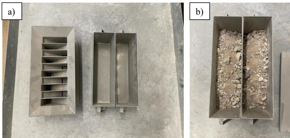
Slika 24: Mehanički linijski razdjelnik.
