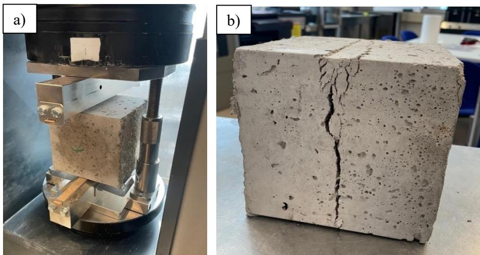
Slika 15: Cijepanje uzoraka. a) Uređaj za ispitivanje čvrstoće b) Cijepani uzorak
