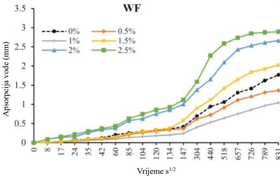
Slika 4: Utjecaj udjela vunenih vlakana na apsorpciju vode betona
