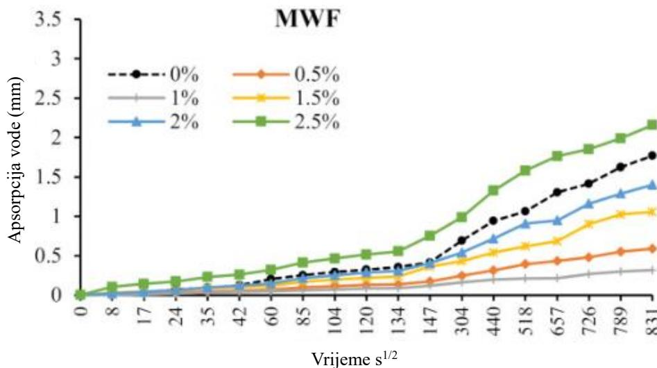
Slika 5: Utjecaj udjela modificiranih vunenih vlakana na apsorpciju vode betona
