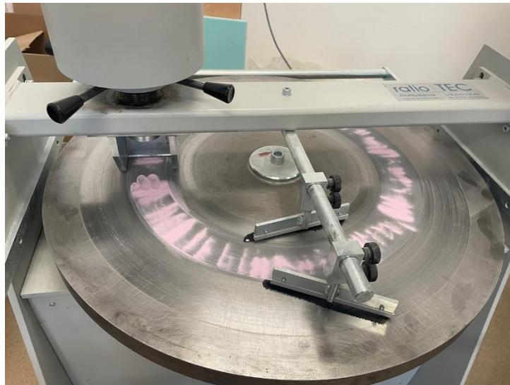
Slika 18: Raspoređeni kvarcni pijesak na rotacijskom stolu
