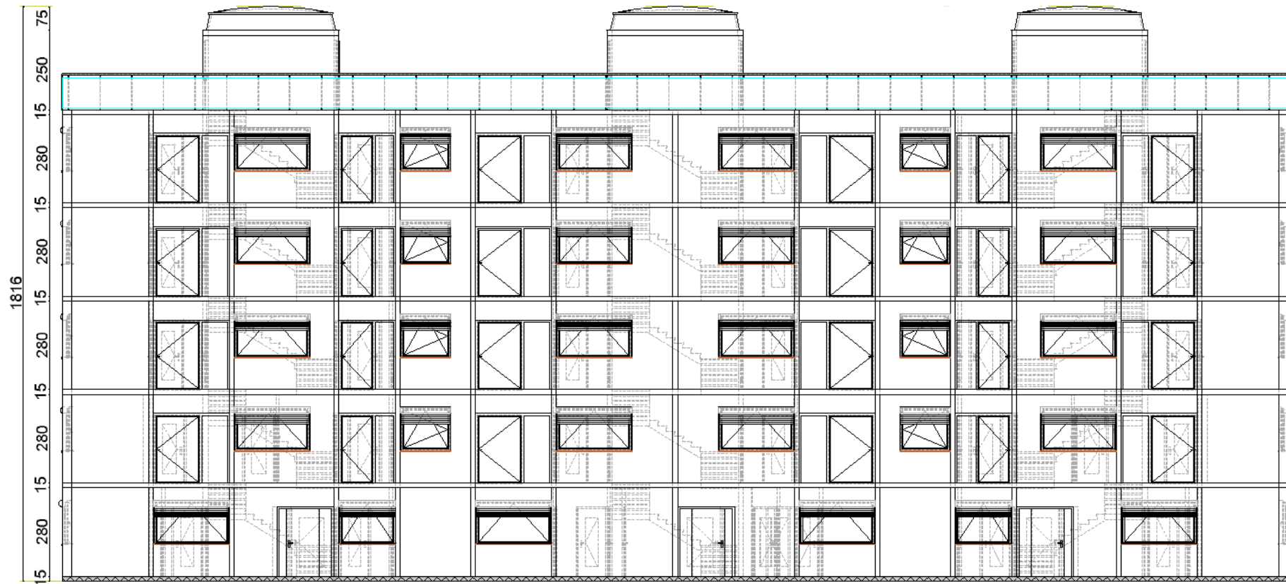
Slika 2. Nacrt zgrade sa osnovnim kotama
