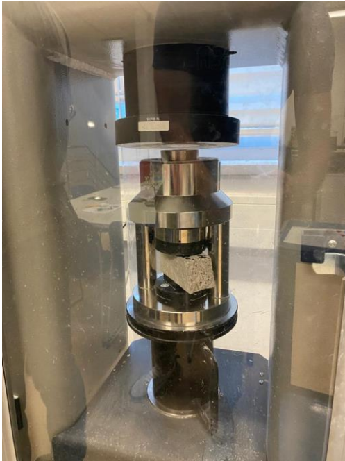
Slika 30. Ispitivanje tlačne čvrstoće
