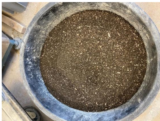
Slika 17. Agregat reciklirani asfalt
