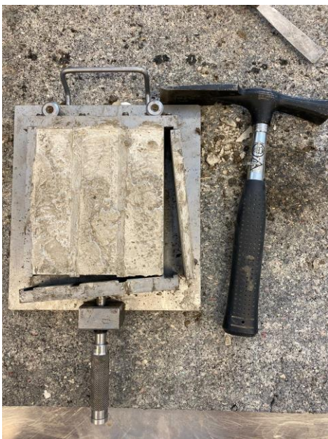
Slika 20. Odvajanje kalupa od cementnih prizmi
