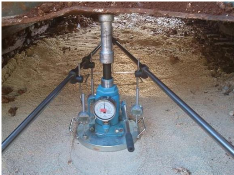
Slika 23: Ispitivanje modula stišljivosti kružnom pločom
