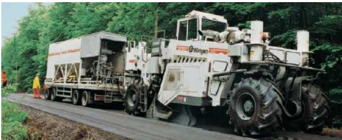
Slika 12: Mehanizacija za izradu hladne reciklaže, modeli WR 2500 i WM 400
