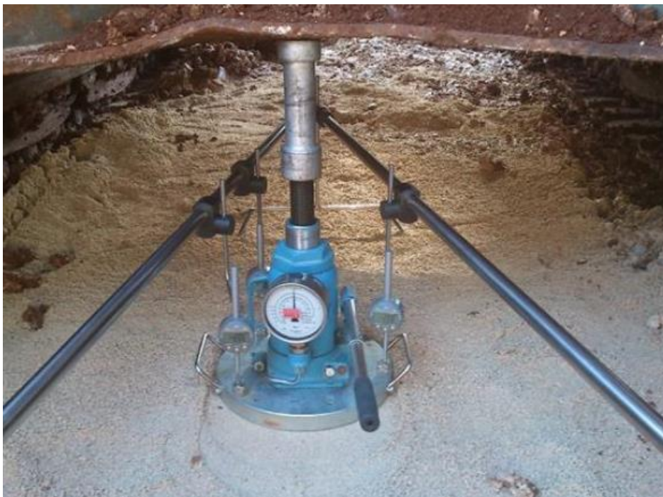
Slika 23: Ispitivanje modula stišljivosti kružnom pločom
