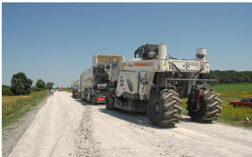
Slika 19: Mehanizacija za izradu hladne reciklaže, model WR 2500
