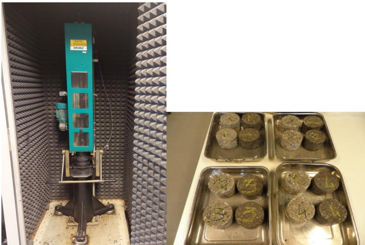
Slika 5: Pripreda laboratorijskog probnog uzorka Marshall nabijačem sa pripremljenim uzorcima
