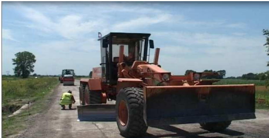
Slika 20: Motorni grejder za razastiranje
