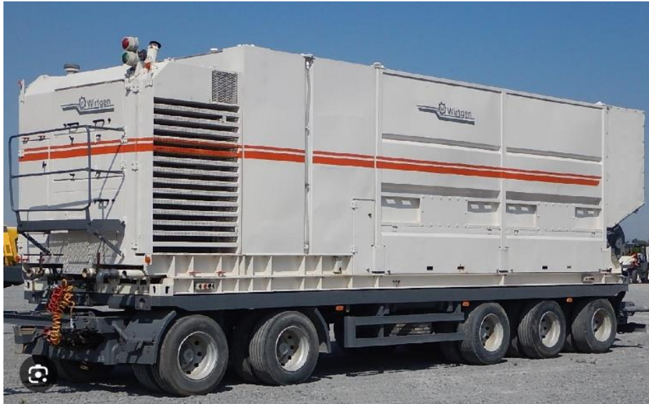
Slika 18: Mehanizacija za izradu hladne reciklaže, model WM 1000
