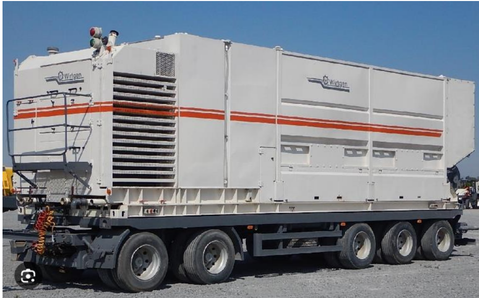
Slika 18: Mehanizacija za izradu hladne reciklaže, model WM 1000
