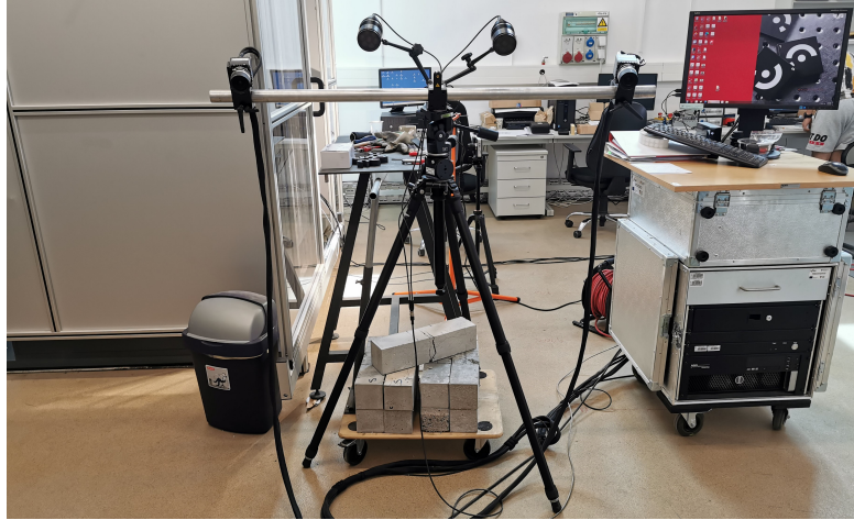
Slika 5.6: Optički mjerni sustav GOM Aramis 4M [5]
