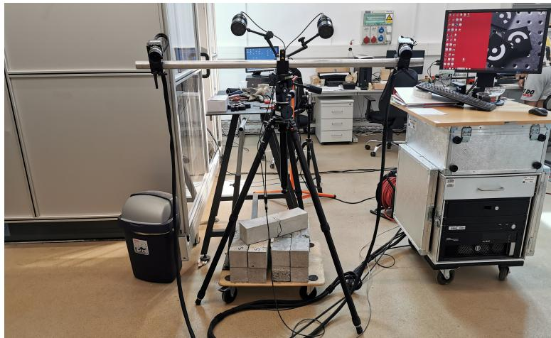
Slika 5.6: Optički mjerni sustav GOM Aramis 4M [5]
