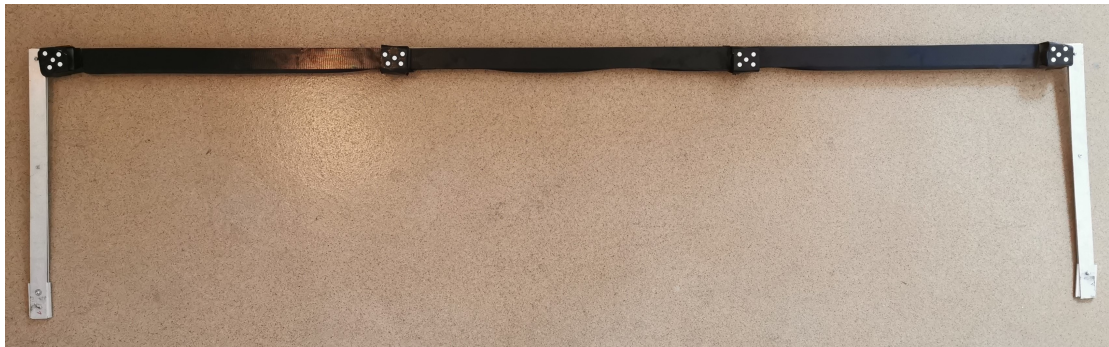
Slika 5.3: Fizikalni model okvira sa stupovima manje krutosti
