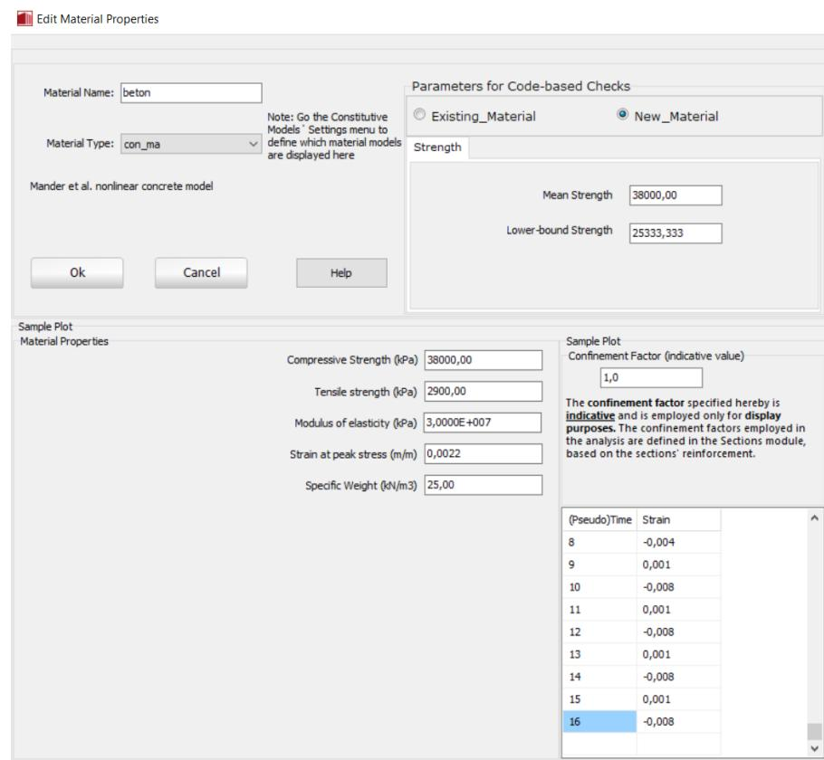
Slika 24: Materijalne karakteristike betona C30/37
