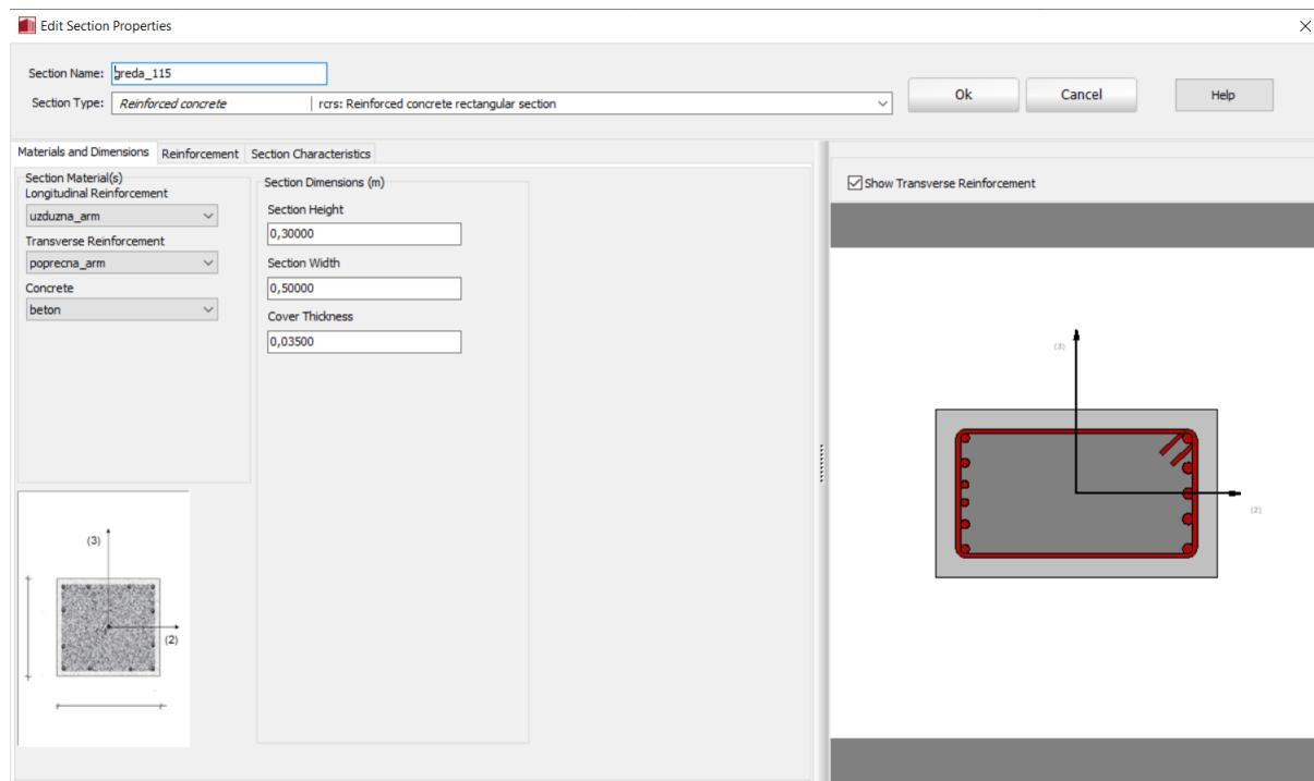
Slika 31. Primjer poprečnog presjeka grede zajedno s armaturom
