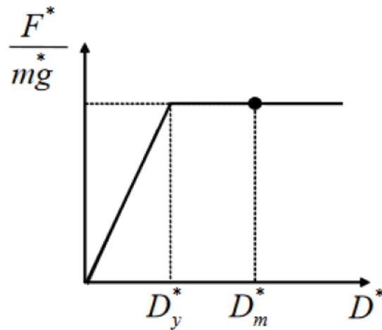
Slika 19: Spektar kapaciteta sustava s jednim stupnjem slobode [13]
