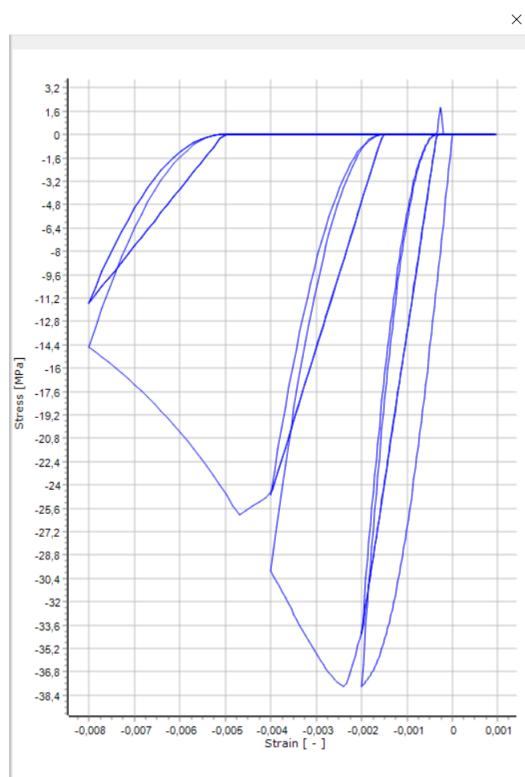
Slika 25: Odnos naprezanje - deformacija betona C30/37
