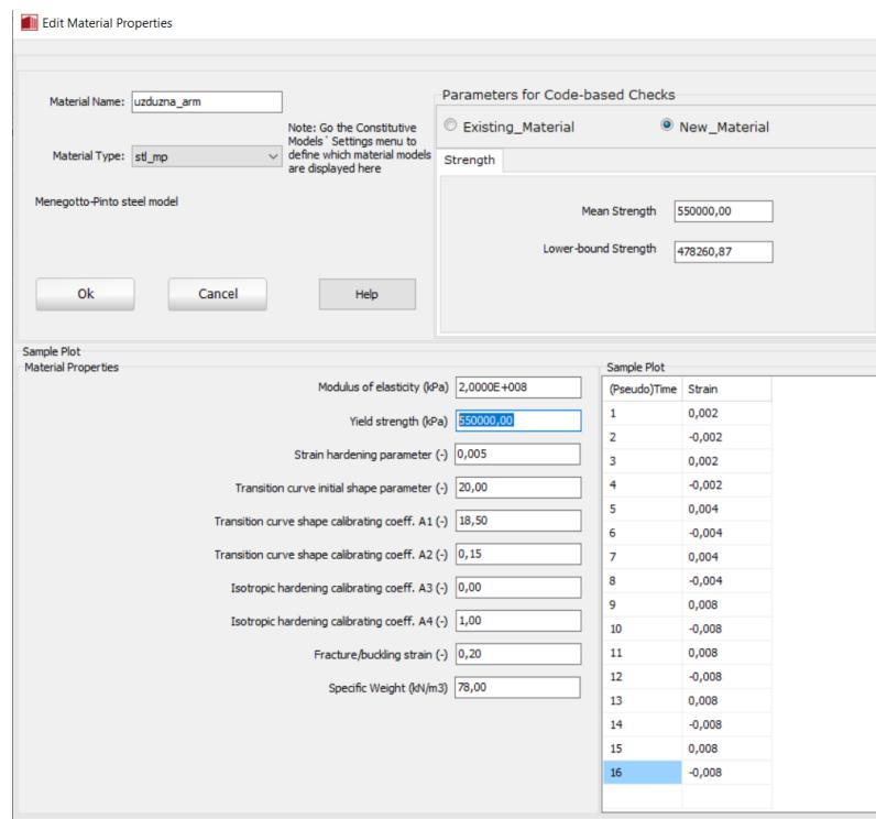
Slika 26: Materijalne karakteristike čelika za armiranje B500B
