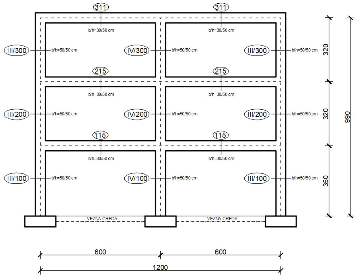
Slika 22: Proračunski model armiranobetonskog okvira [izradio autor]
