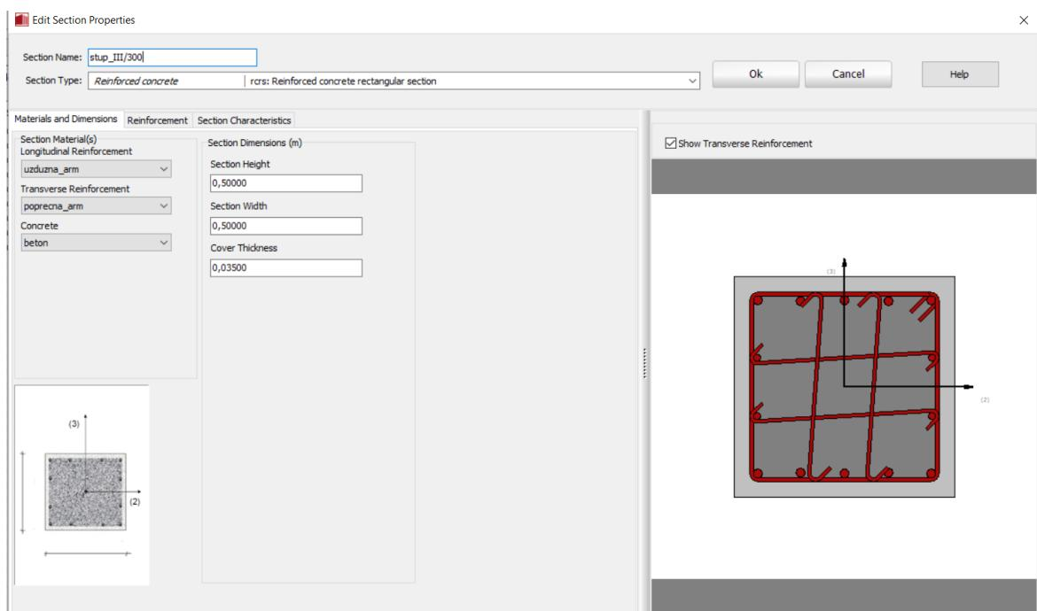
Slika 30. Poprečni presjek stupa zajedno s definiranom armaturom
