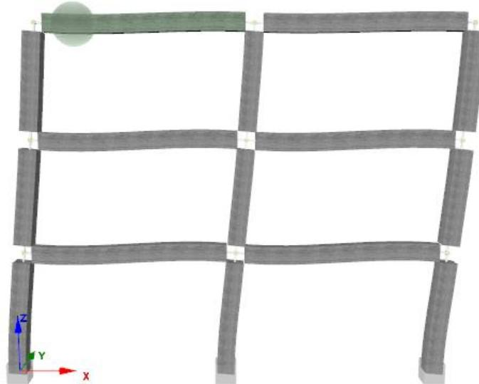
Slika 87: Plastični zglob na vanjskom osloncu grede POZ. 311
