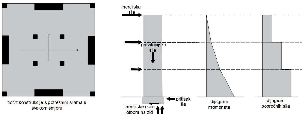
Slika 4: Preuzimanje horizontalnog potresnog djelovanja armiranobetonskim zidovima.
