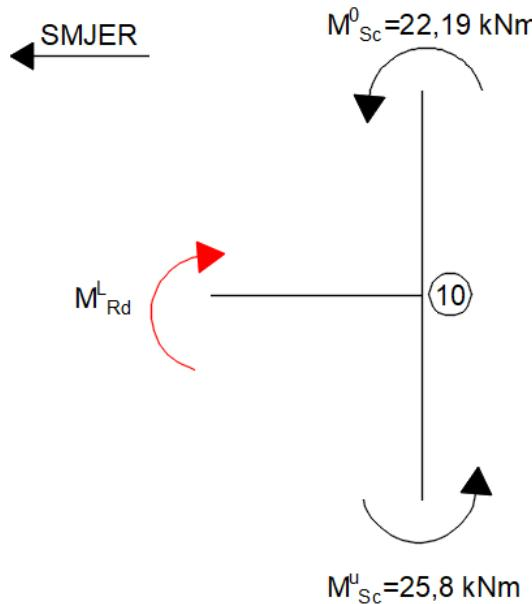
Slika 80: Vrijednosti momenata stupa i grede u čvoru 10 za smjer 2 [izradio autor]
