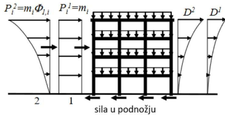
Slika 16: Načini raspodjele horizontalnog opterećenja - jednolično (1) i modalno (2) [13]
