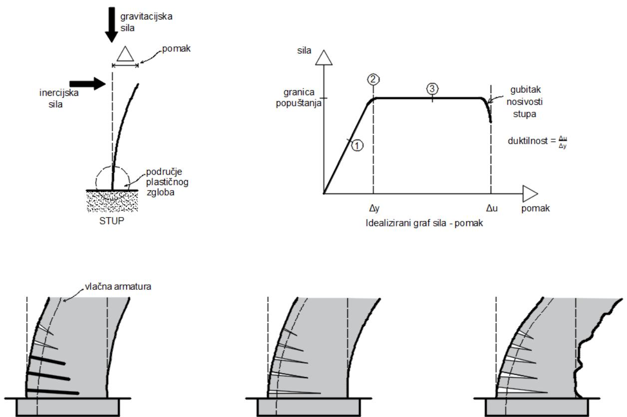
Slika 3: Model armiranobetonskog konzolnog stupa izloženog djelovanju horizontalne sile.
