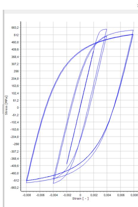
Slika 27: Odnos naprezanje - deformacija čelika za armiranje B500B
