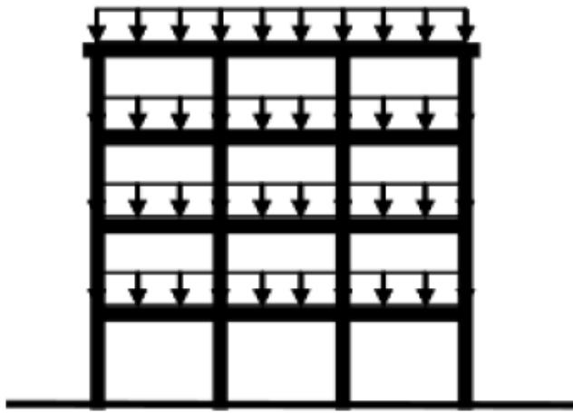
Slika 15: Prikaz vertikalnog opterećenja na konstrukciju [13]
