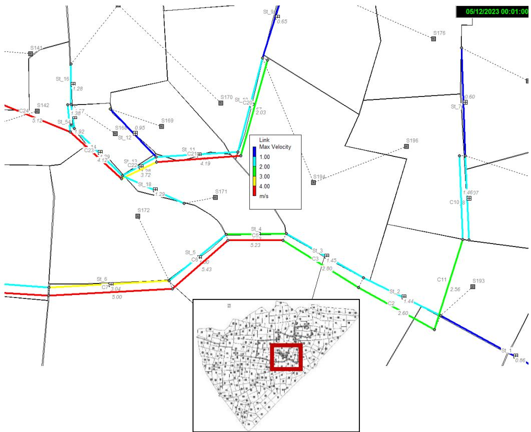
Slika 69. Grafički prikaz maksimalnih brzina u cijevima u podsustavu 4 za sadašnje stanje (PP 25.god., 3h)
