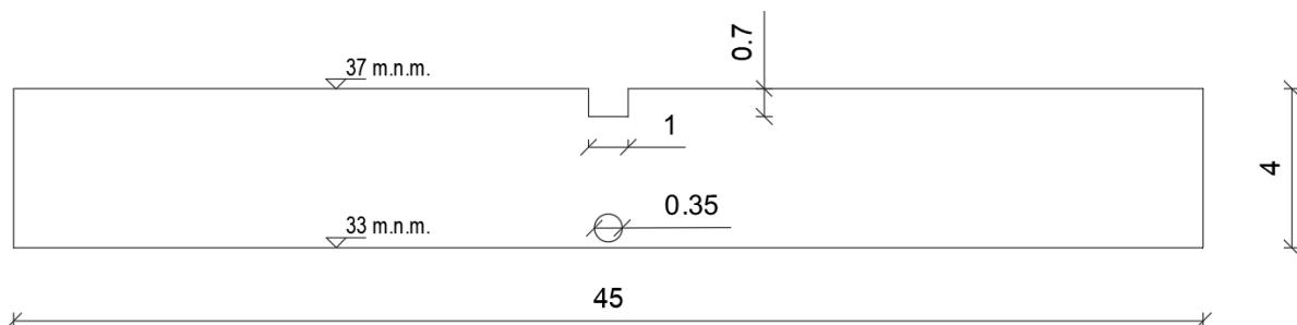
Slika 155. Shematski prikaz poprečnog presjeka retencije
