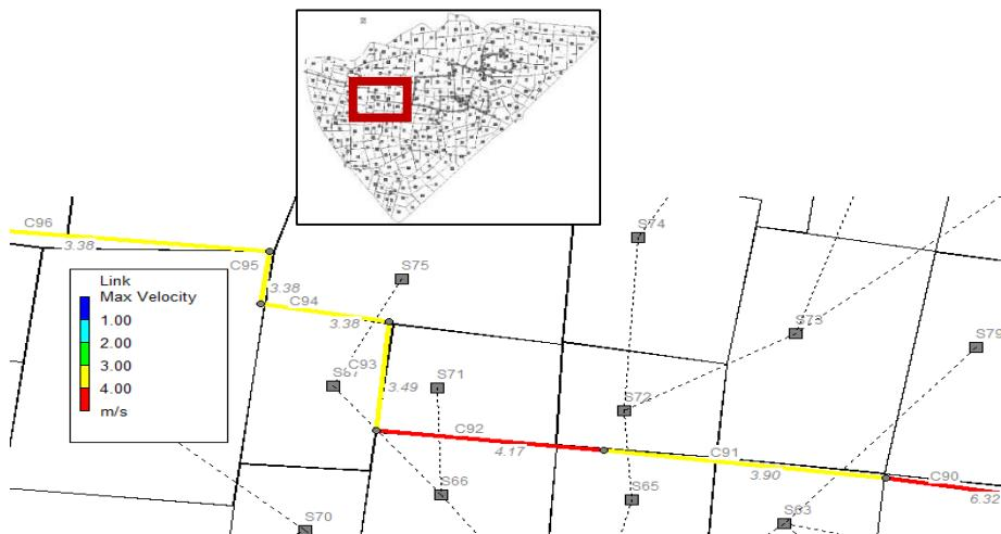
Slika 71. Grafički prikaz maksimalnih brzina u cijevima u podsustavu 6 za sadašnje stanje (PP 25.god., 3h)
