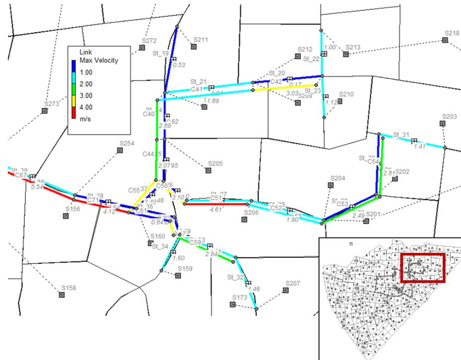
Slika 59. Grafički prikaz maksimalnih brzina u cijevima u podsustavu I za sadašnje stanje (PP 2.god., 3h)
