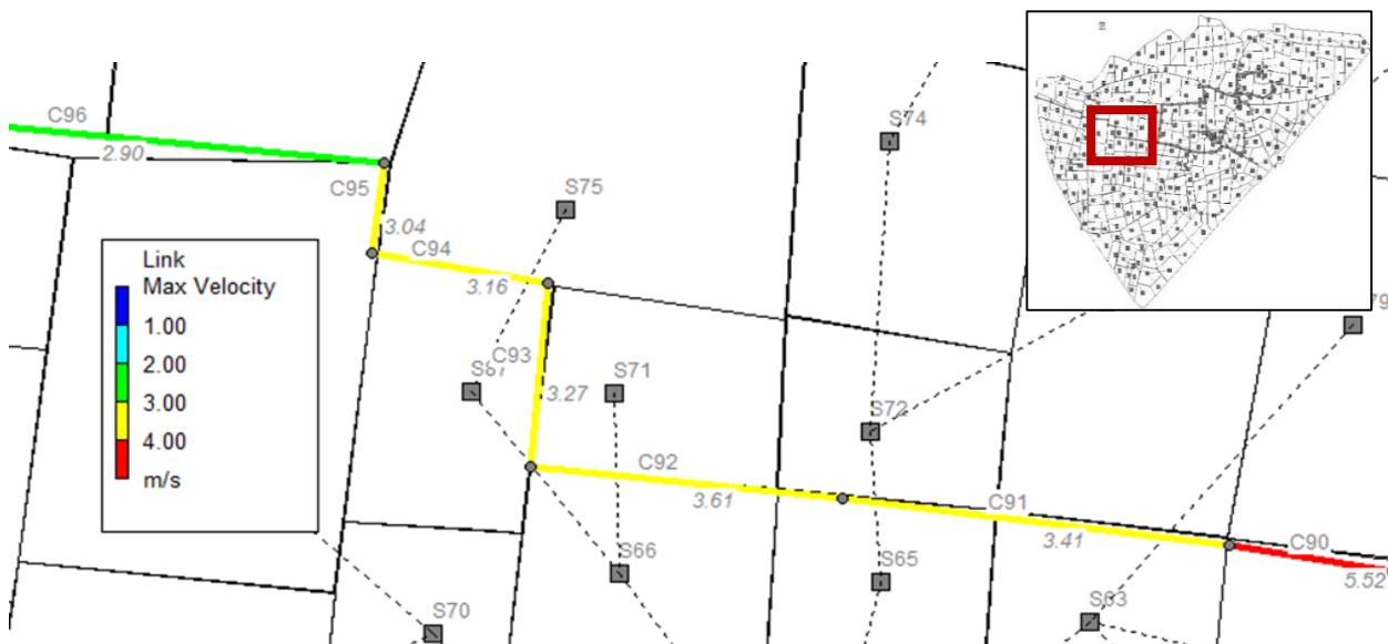
Slika 64. Grafički prikaz maksimalnih brzina u cijevima u podsustavu 6 za sadašnje stanje (PP 2.god., 3h)
