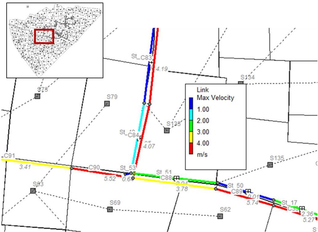
Slika 61. Grafički prikaz maksimalnih brzina u cijevima u podsustavu 3 za sadašnje stanje (PP 2.god., 3h)
