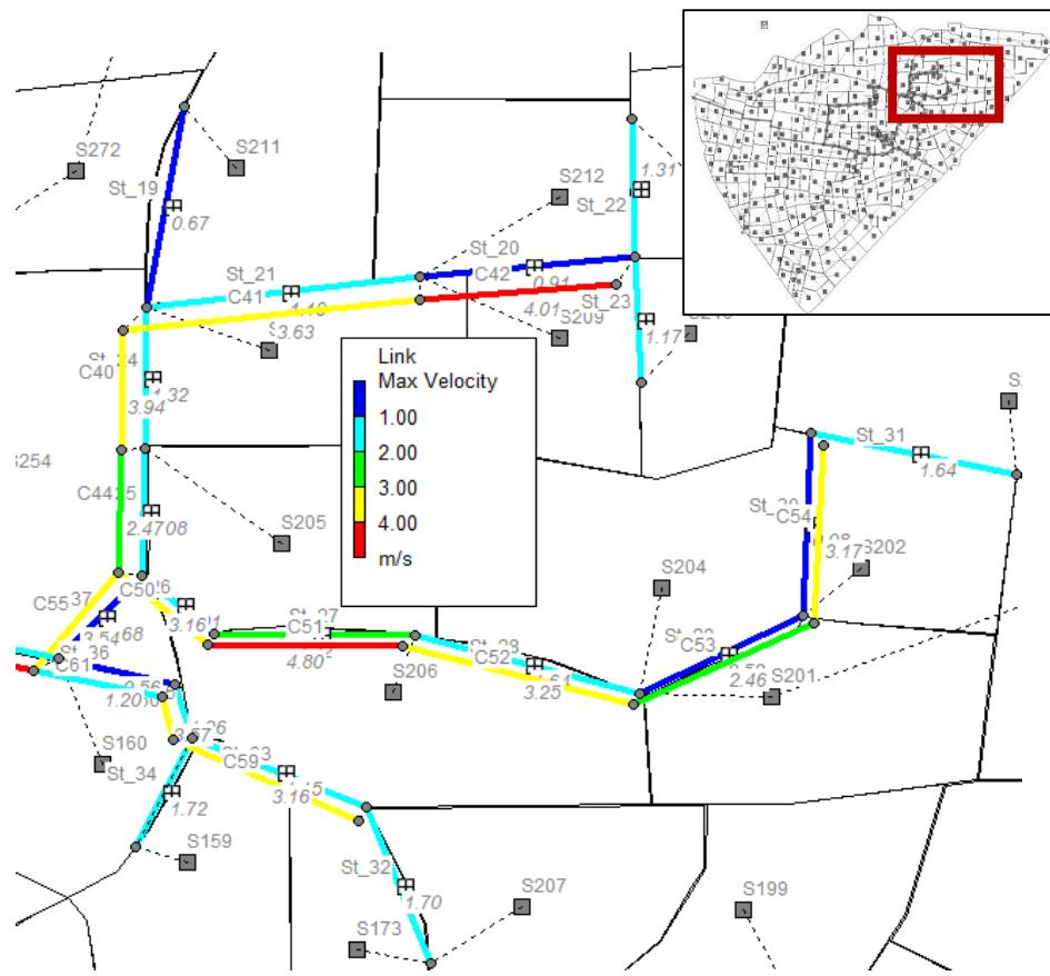
Slika 66. Grafički prikaz maksimalnih brzina u cijevima u podsustavu 1 za sadašnje stanje (PP 25.god., 3h)
