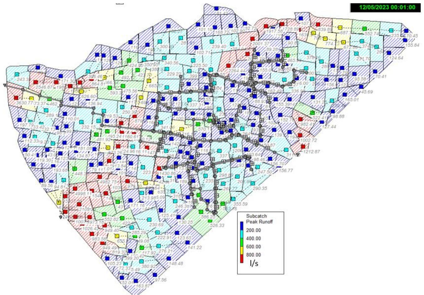
Slika 103. Grafički prikaz vršnog otjecanja na analiziranom području(100god.,3h)
