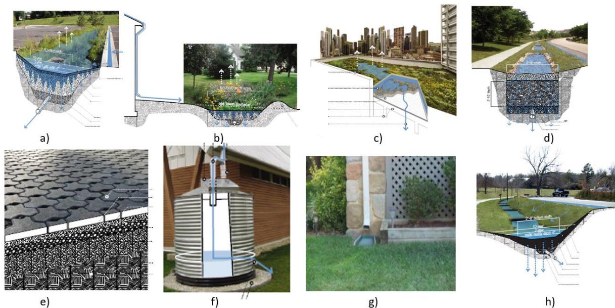
*Slika 6. Primjeri zelene infrastrukture (LID elementi): a) bioretencija, b) kišni vrt, c) zeleni krov, d) infiltracijski jarak, e) propusni kolnik f) cisterna, g) krov s povezanim olucima i h) vegetativni kanali*
