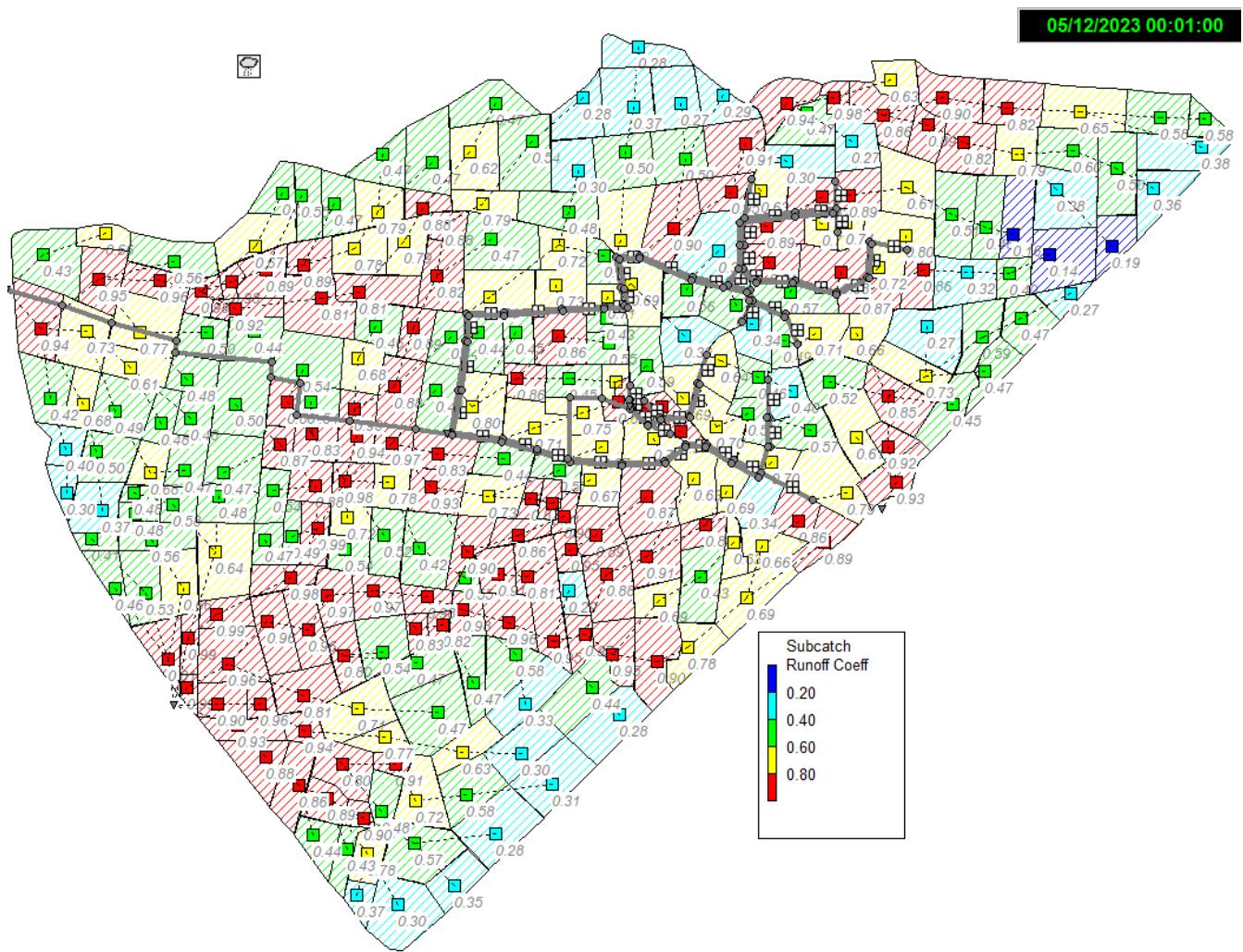
Slika 51. Shematski prikaz koeficijenta otjecanja na pojedinom podslivu (PP100,3h)
