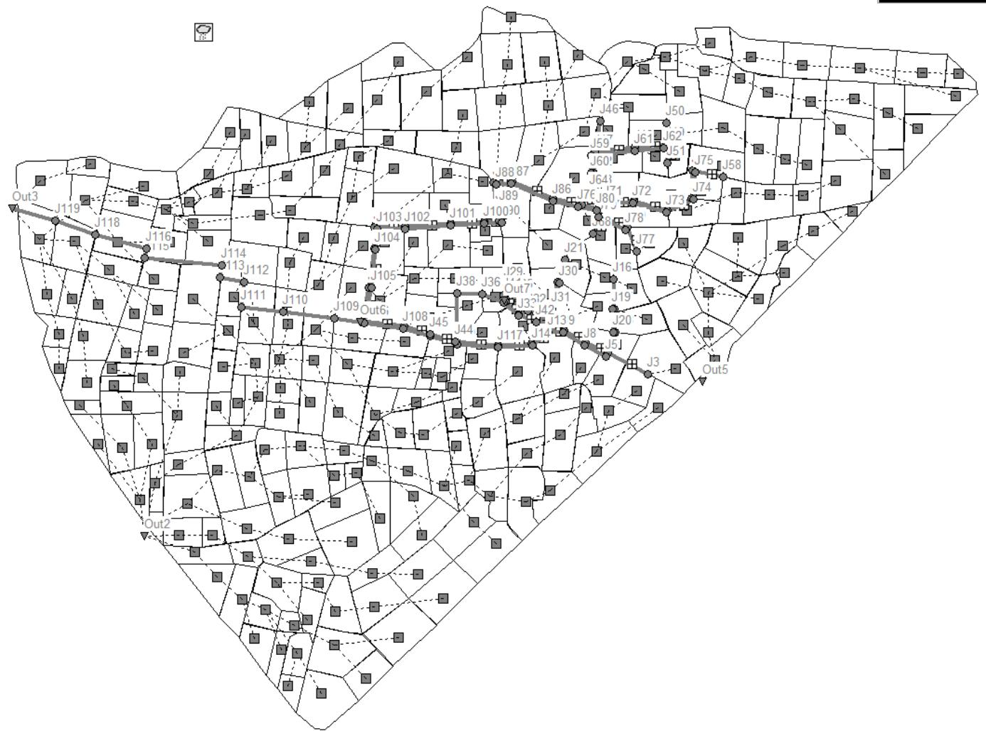
Slika 21. Prikaz hidrološko-hidrauličkog modela u SWMM programu
