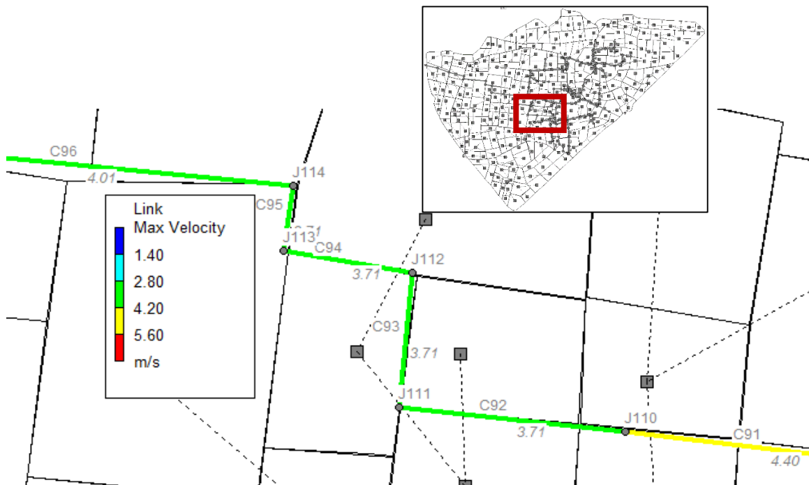
Slika 144. Grafički prikaz maksimalnih brzina u cijevima u podsustavu 9 za buduće stanje (PP 100 god., 3h)
