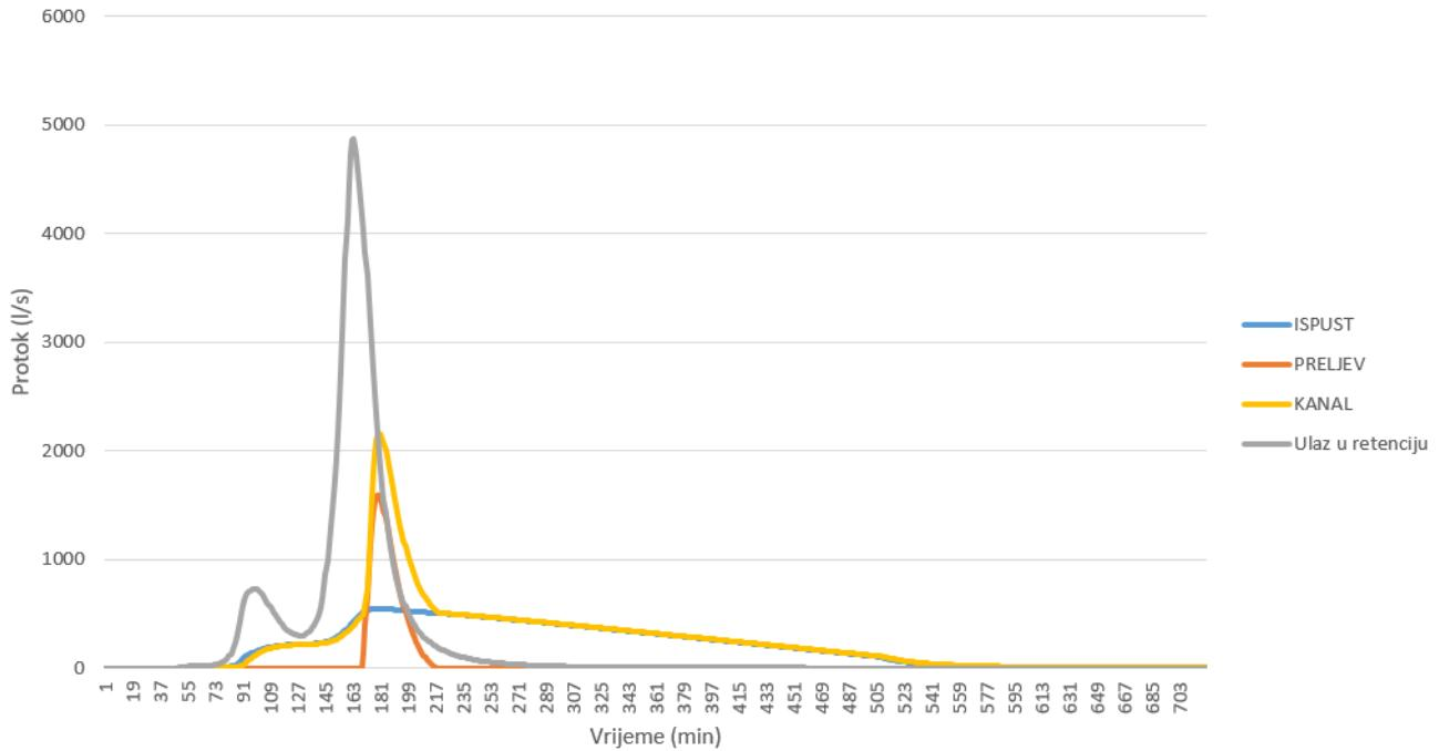
Slika 159. Hidrogrami otjecanja za ulaz u retenciju, isplust, preljev i kanal (PP100\_3h)
