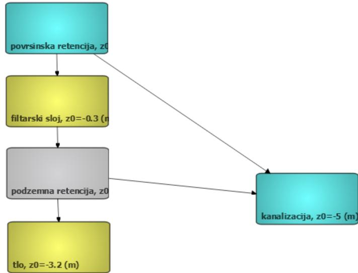
Slika 36: Primjer modela kišnog vrta u GIFMod računalnom programu
