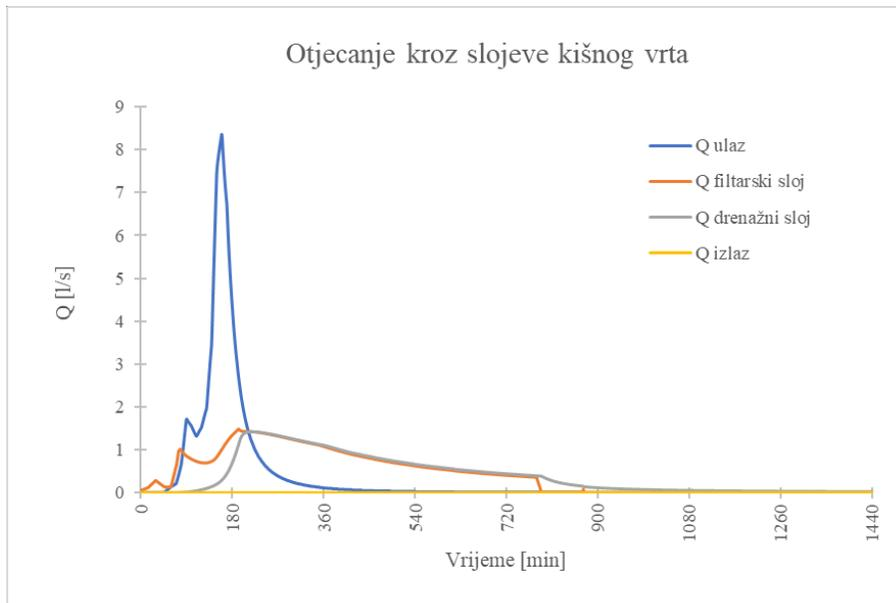
Slika 40: Model 1, 3.kriterij – otjecanje kroz slojeve kišnog vrta
