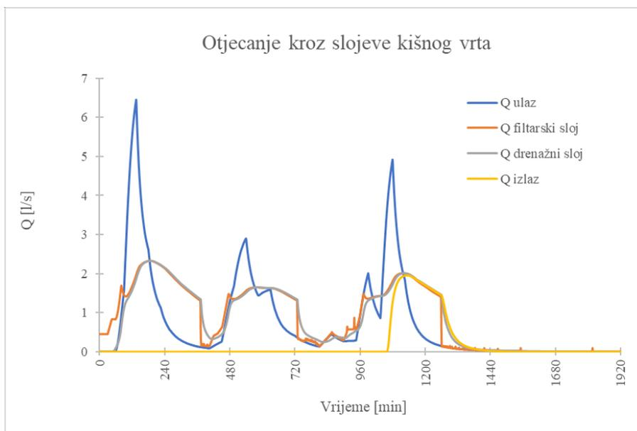
Slika 108: Model 7, 4.kriterij – otjecanje kroz slojeve kišnog vrta
