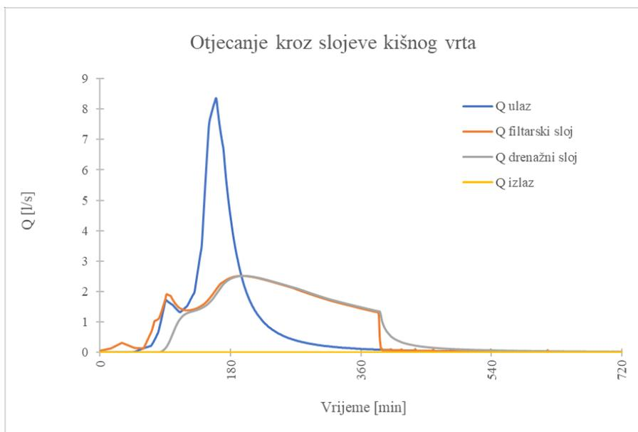
Slika 84: Model 5, 3.kriterij – otjecanje kroz slojeve kišnog vrta
