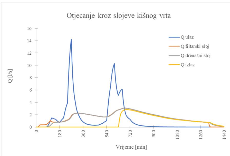
Slika 77: Model 4, 5.kriterij – otjecanje kroz slojeve kišnog vrta
