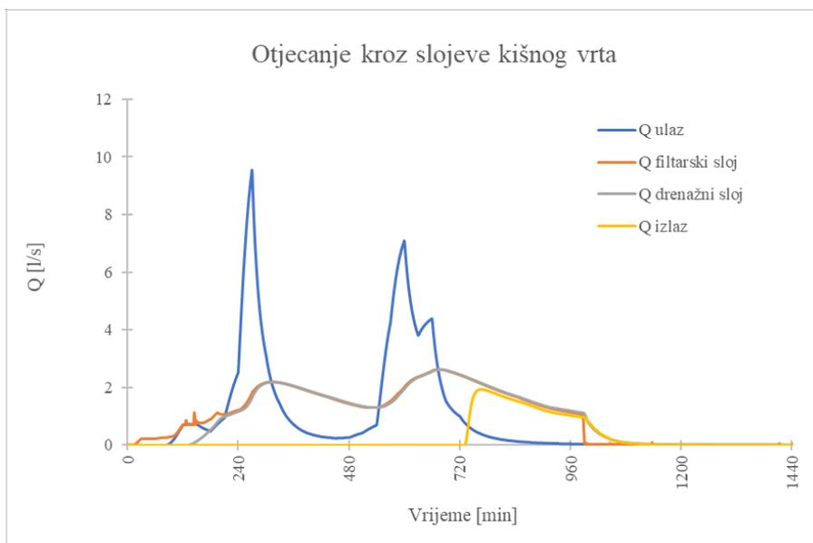
Slika 64: Model 3, 4.kriterij – otjecanje kroz slojeve kišnog vrta
