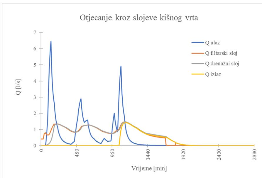
Slika 42: Model 1, 4.kriterij – otjecanje kroz slojeve kišnog vrta
