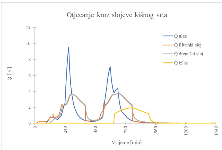
Slika 53: Model 2, 4.kriterij – otjecanje kroz slojeve kišnog vrta
