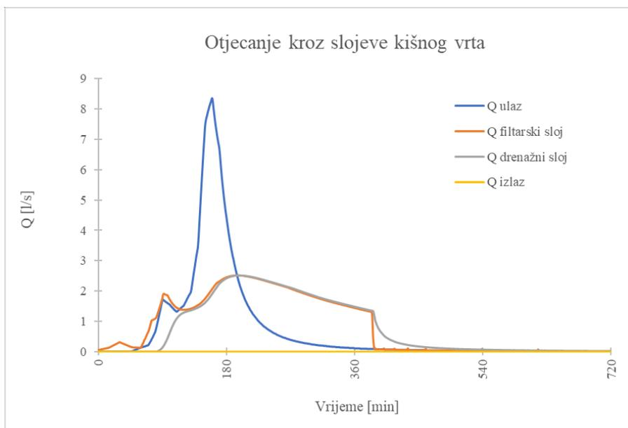
Slika 95: Model 6, 3.kriterij – otjecanje kroz slojeve kišnog vrta
