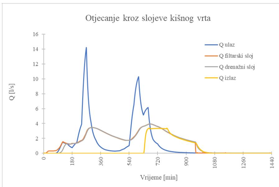
Slika 99: Model 6, 5.kriterij – otjecanje kroz slojeve kišnog vrta
