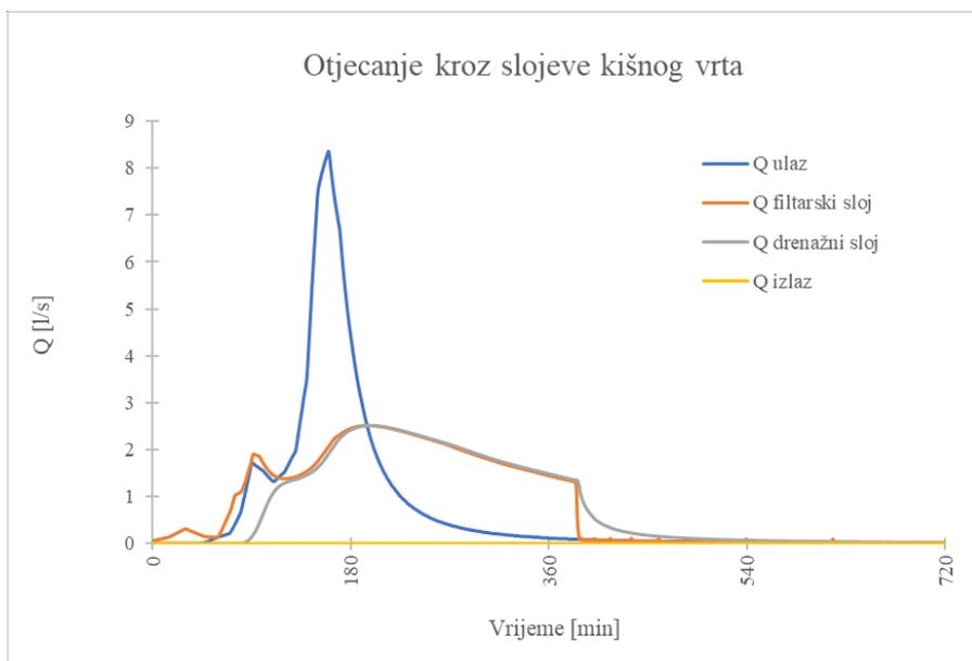
Slika 106: Model 7, 3.kriterij – otjecanje kroz slojeve kišnog vrta
