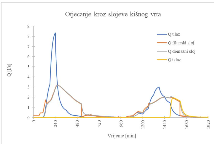
Slika 86: Model 5, 4.kriterij – otjecanje kroz slojeve kišnog vrta
