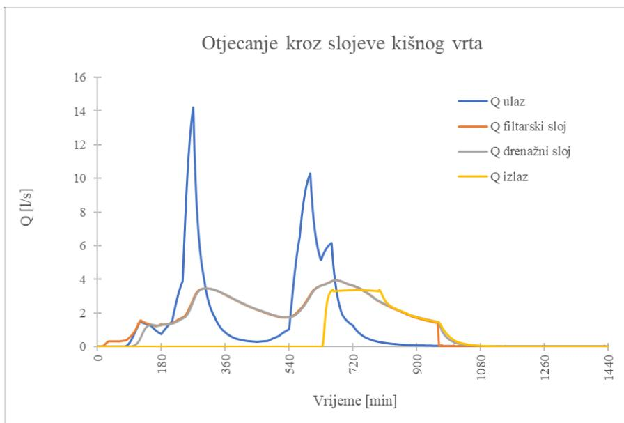
Slika 110: Model 7, 5.kriterij – otjecanje kroz slojeve kišnog vrta
