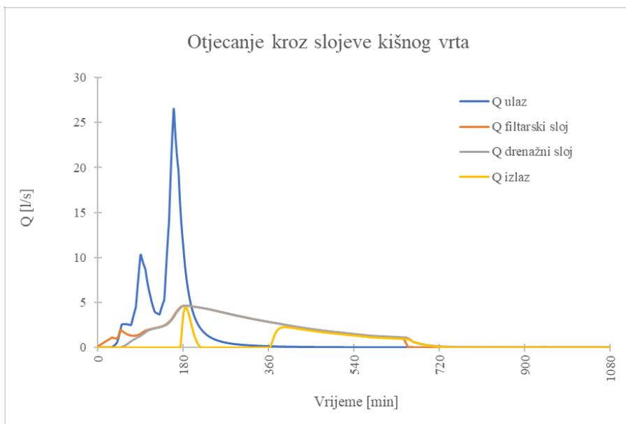
Slika 66: Model 3, 5.kriterij – otjecanje kroz slojeve kišnog vrta
