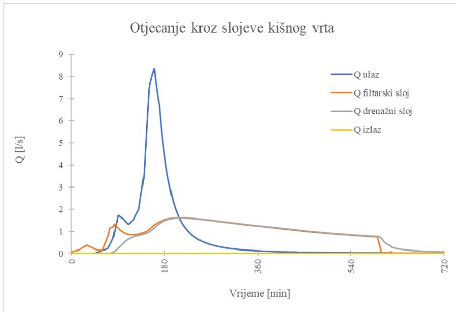
Slika 73: Model 4, 3.kriterij – otjecanje kroz slojeve kišnog vrta
