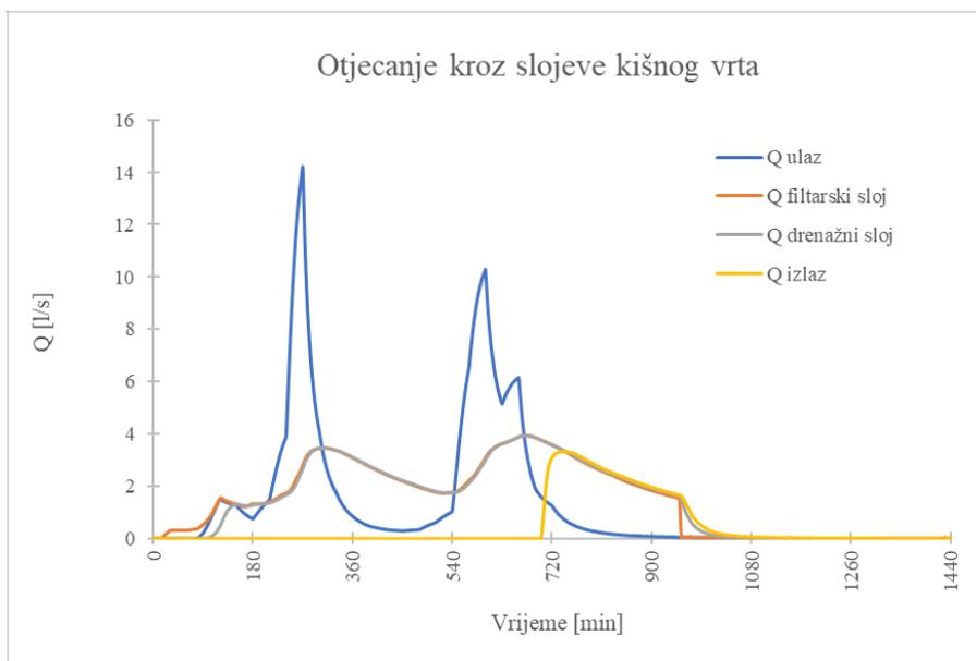
Slika 88: Model 5, 5.kriterij – otjecanje kroz slojeve kišnog vrta
