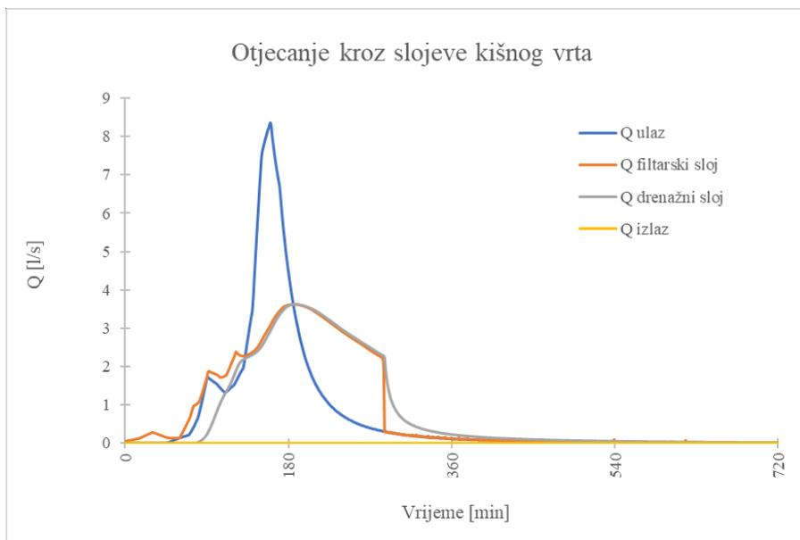
Slika 51: Model 2, 3.kriterij – otjecanje kroz slojeve kišnog vrta
