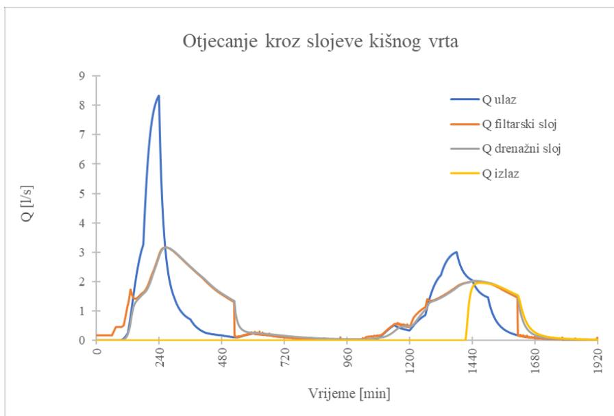
Slika 97: Model 6, 4.kriterij – otjecanje kroz slojeve kišnog vrta
