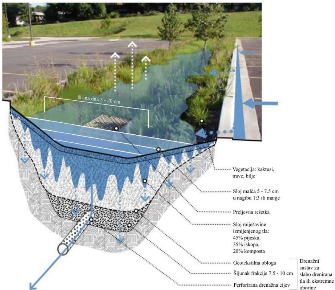
Slika 9: Shematski prikaz bioretencije (modificirano prema [4])
