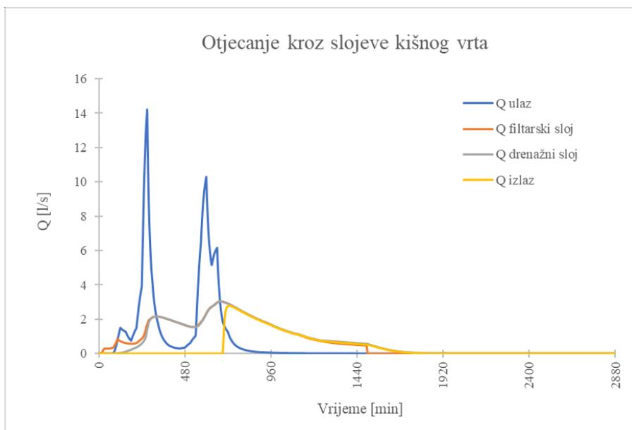
Slika 44: Model 1, 5.kriterij – otjecanje kroz slojeve kišnog vrta
