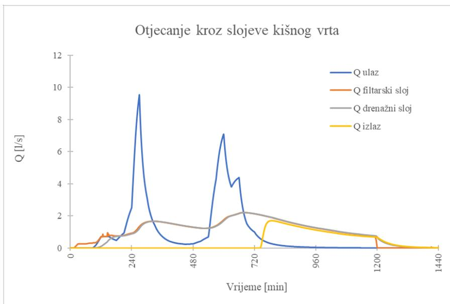
Slika 75: Model 4, 4.kriterij – otjecanje kroz slojeve kišnog vrta
