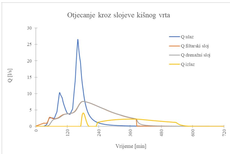
Slika 55: Model 2, 5.kriterij – otjecanje kroz slojeve kišnog vrta
