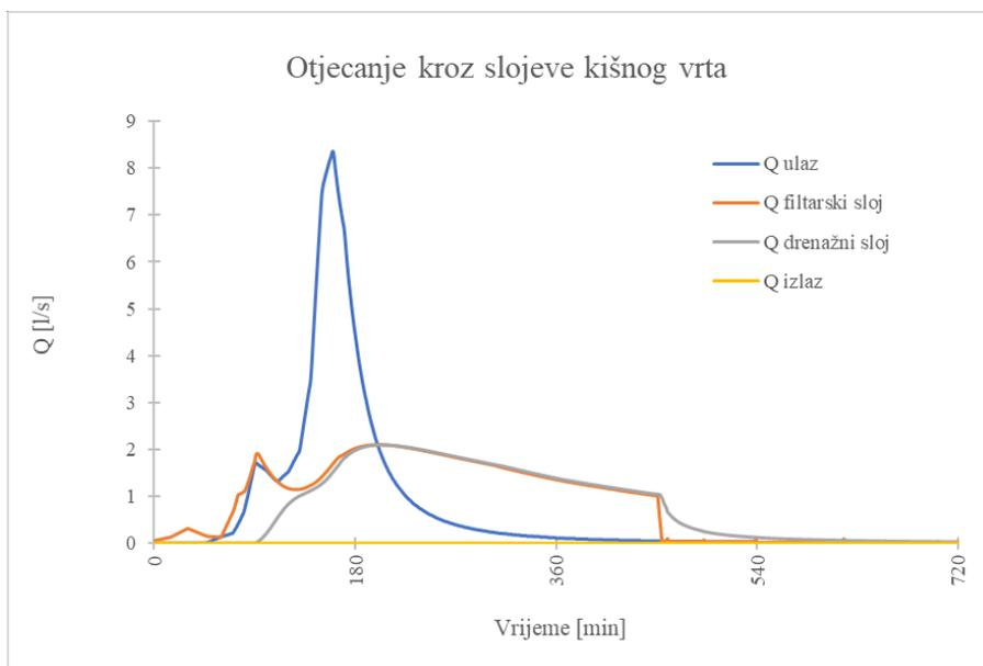
Slika 62: Model 3, 3.kriterij – otjecanje kroz slojeve kišnog vrta
