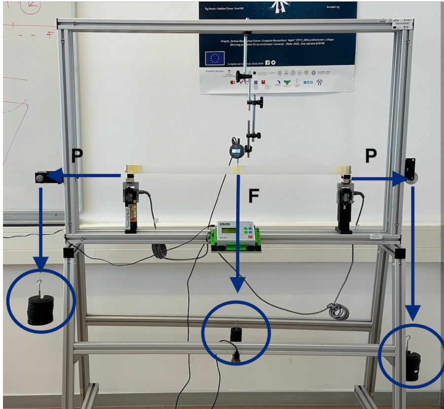
Slika 18. Prednapeta greda u punom opterećenju
