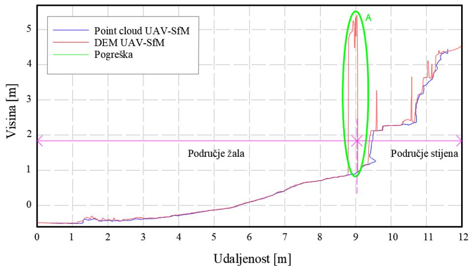
Slika 89: Prikaz presjeka 3 u AutoCAD-u, usporedba oblak točaka i DEM modela
