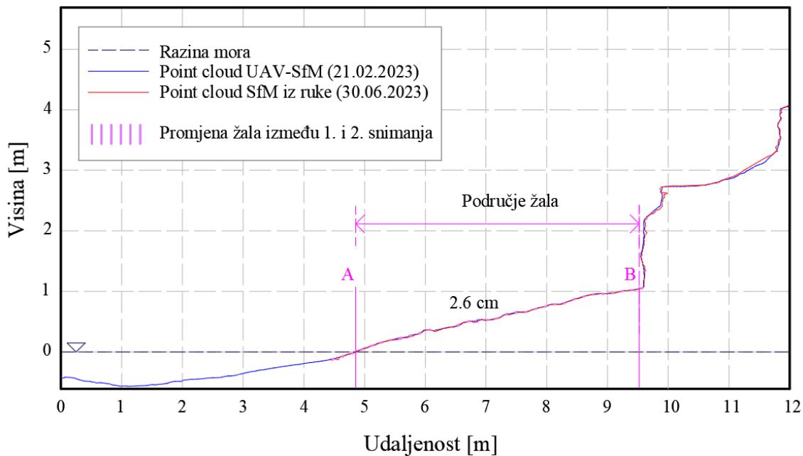
Slika 110: Prikaz promjene visina u poprečnim presjecima profila 4 u *AutoCAD*-u
