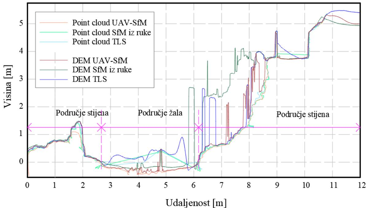
Slika 80: Prikaz poprečnih presjeka profila 1 u *AutoCAD* softveru
