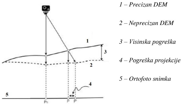
Slika 9: Pogreška projiciranja uslijed nepreciznog DEM modela [17]
