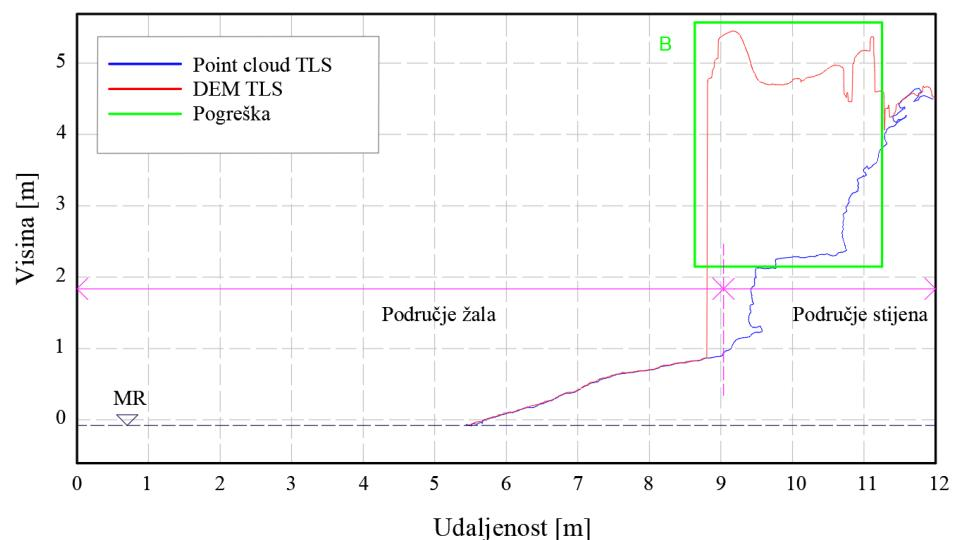
Slika 97: Prikaz presjeka 3 u AutoCAD-u, usporedba oblak točaka i DEM modela - metoda TLS
