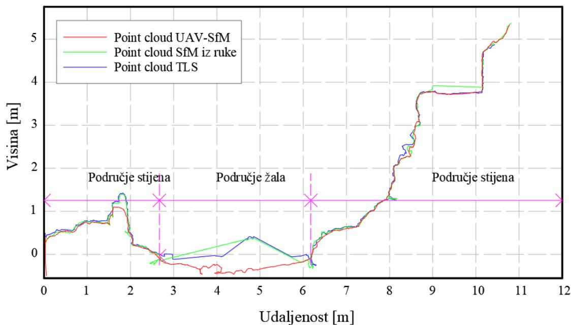
Slika 81: Prikaz poprečnih presjeka profila 1 u AutoCAD softveru – presjeci iz oblaka točaka
