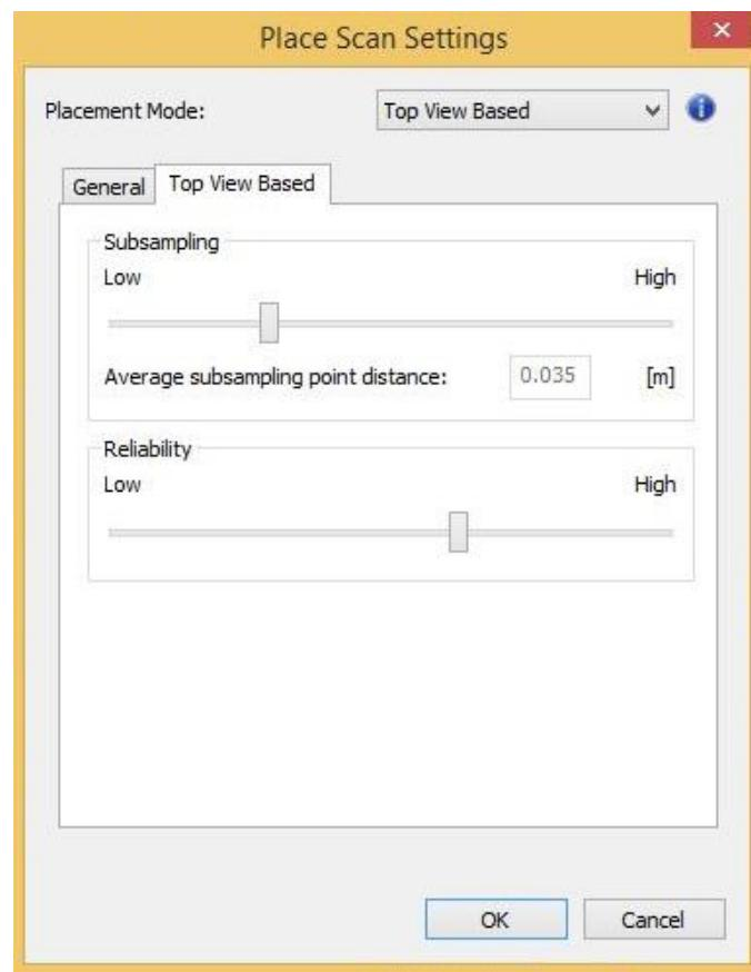
Slika 35: Prikaz odabralih parametara pri registraciji skenova TLS metodom
