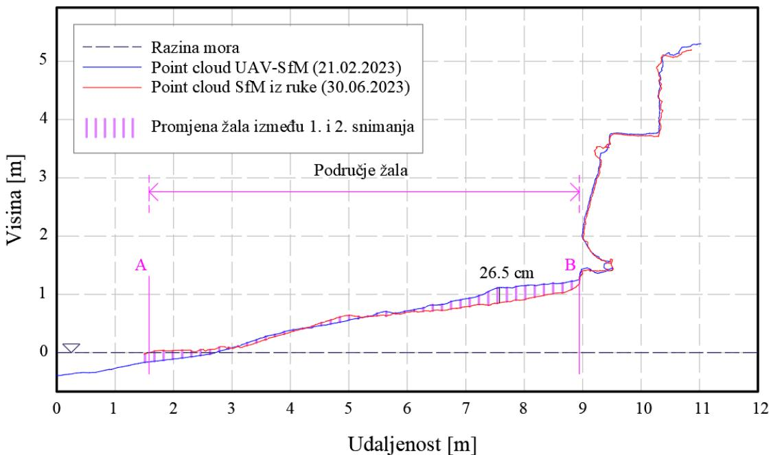
Slika 112: Prikaz promjene visina u poprečnim presjecima profila 6 u AutoCAD-u
