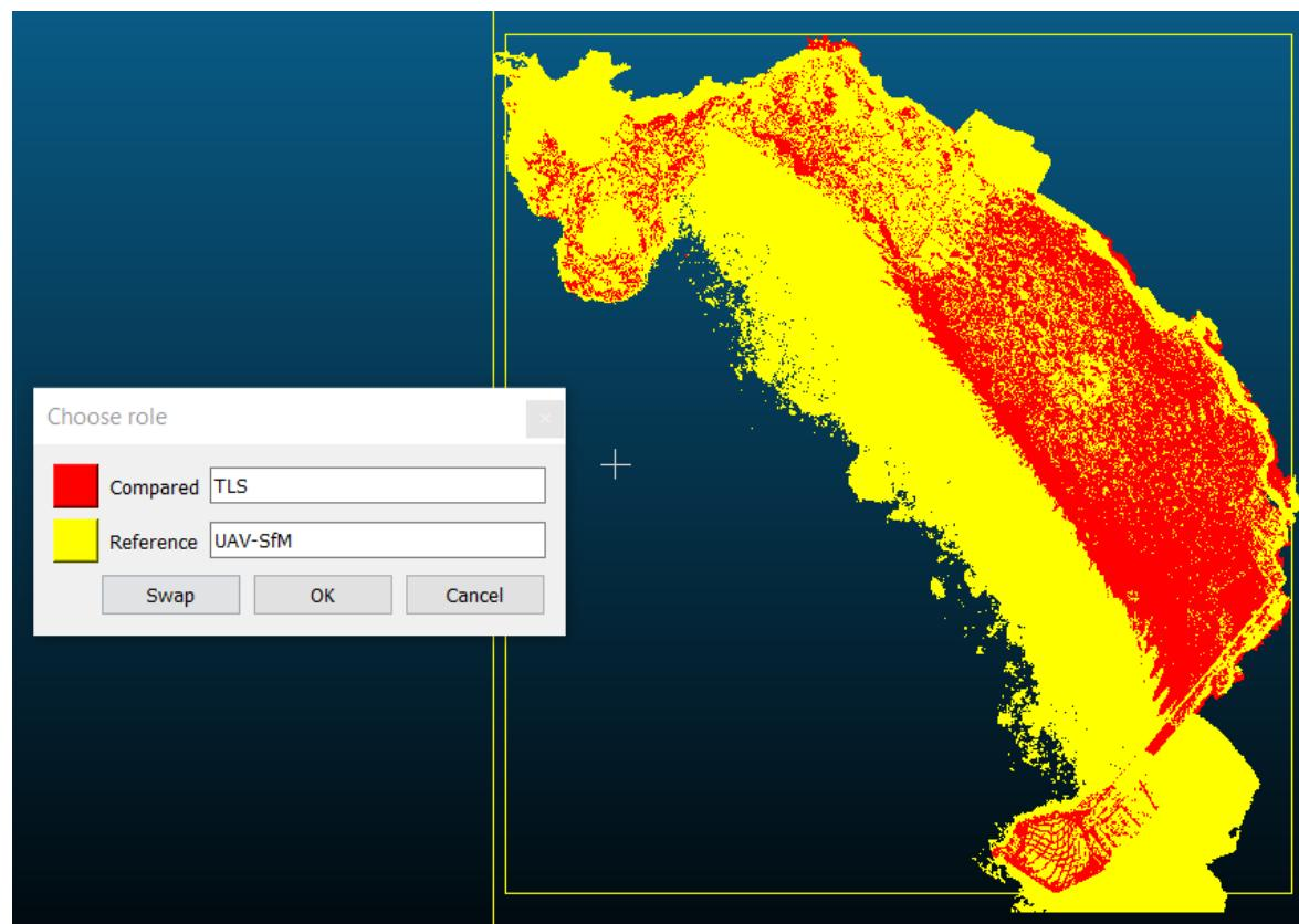
Slika 49: Definiranje referentnog i uspoređenog oblika točaka pri C2C usporedbi
