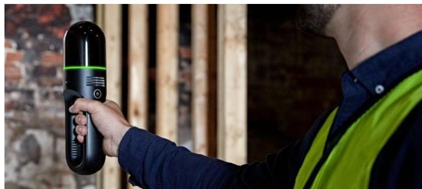
Slika 12: Ručni laserski skener [32]
