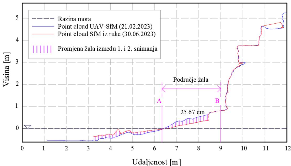
Slika 108: Prikaz promjene visina u poprečnim presjecima profila 2 u *AutoCAD*-u
