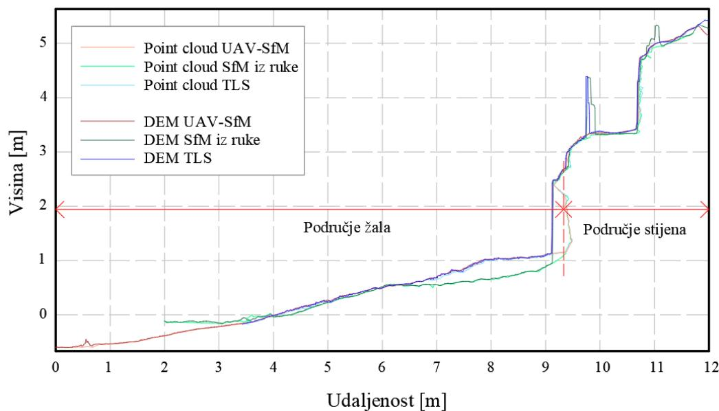
Slika 86: Prikaz poprečnih presjeka profila 5 u *AutoCAD* softveru
