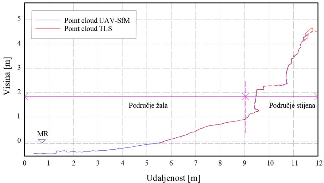
Slika 103: Prikaz presjeka 3 u AutoCAD-u, usporedba oblaka točaka UAV-SfM i TLS metoda
