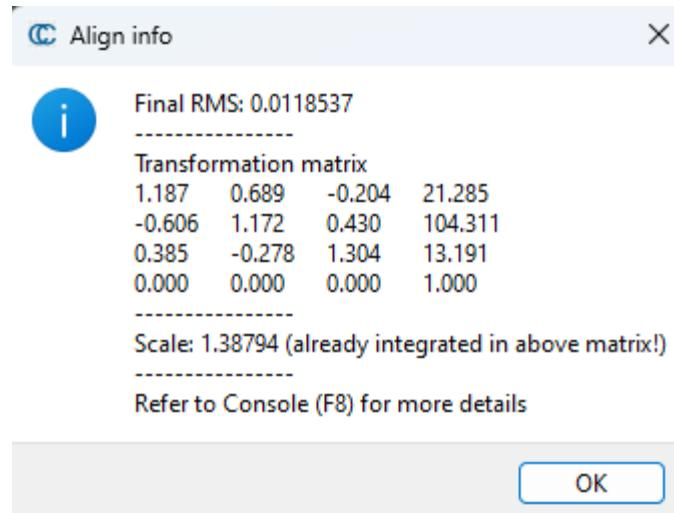
Slika 53: Prikaz RMS broja i matrice transformacije modela dobivenih metodama
