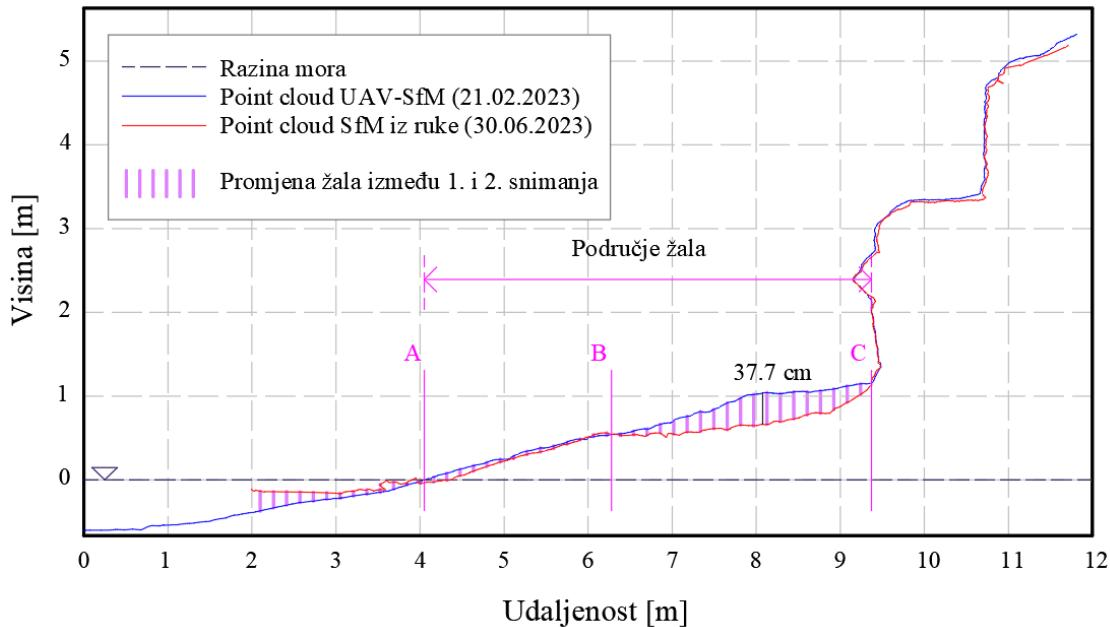
Slika 111: Prikaz promjene visina u poprečnim presjecima profila 5 u *AutoCAD*-u
