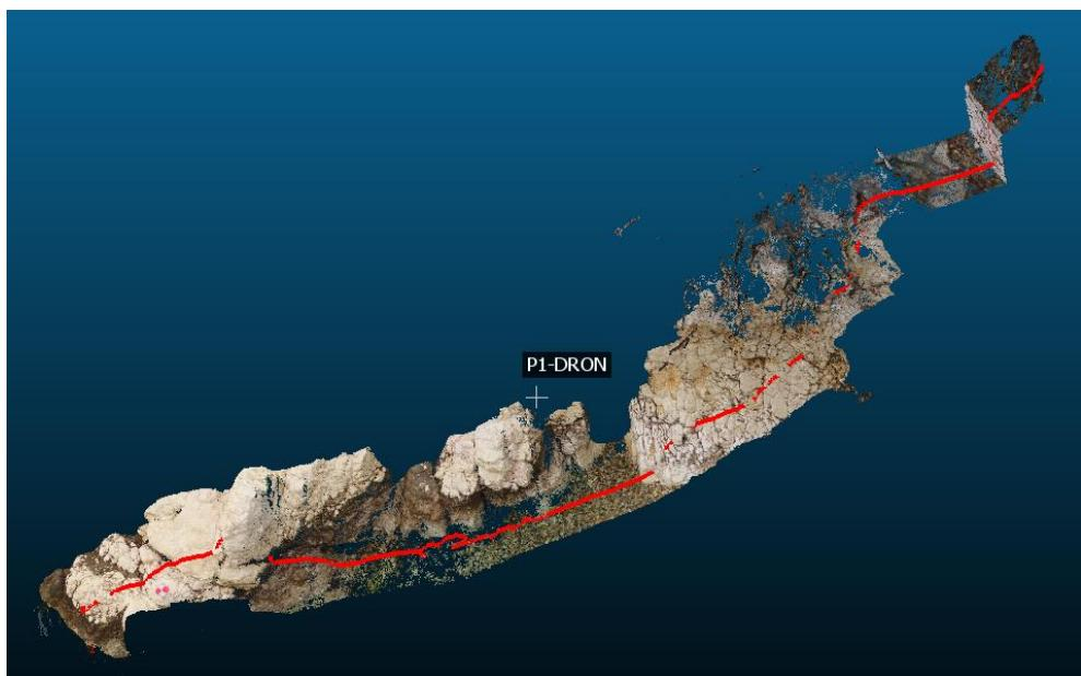
Slika 101: Prikaz presjeka 1 u CloudCompare-u – UAV-SfM metoda
