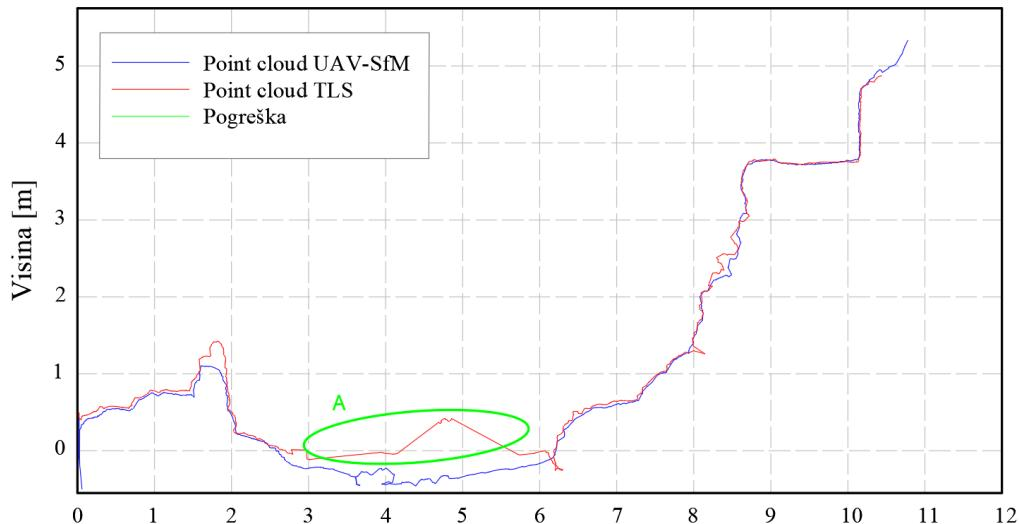
Slika 100: Prikaz presjeka 1 u *AutoCAD*-u, usporedba oblaka točaka UAV-SfM i TLS metoda
