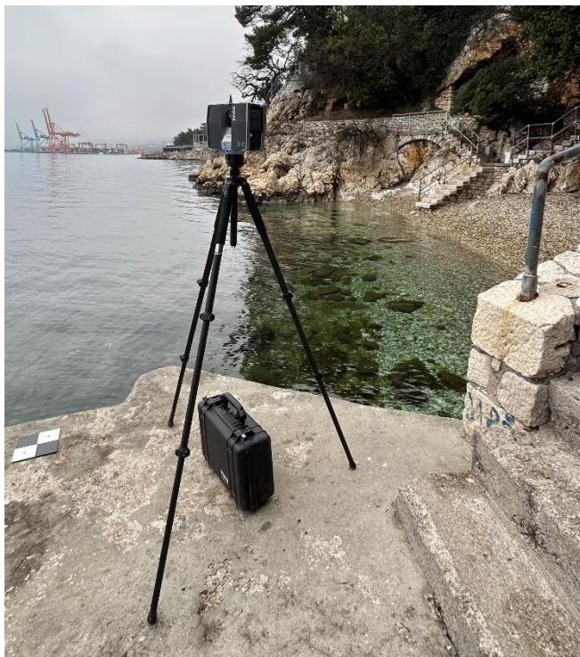
Slika 10: Statički laserski skener FARO Focus3D X 130
