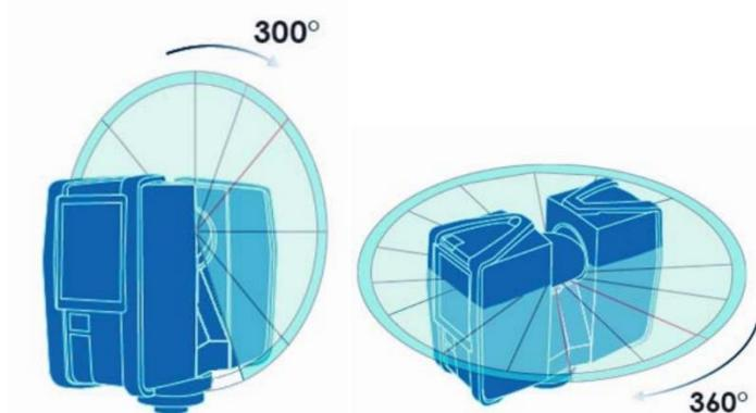
Slika 31: Raspon vidnog polja korištenog skenera u vertikalnom i horizontalnom smjeru [34]
