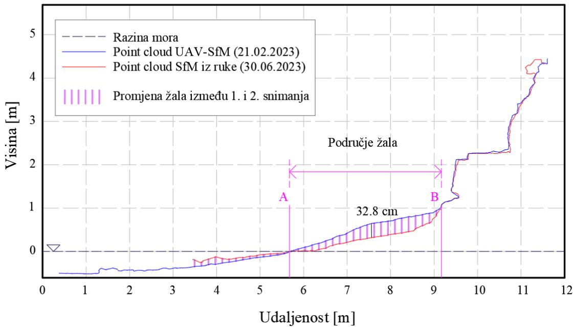
Slika 109: Prikaz promjene visina u poprečnim presjecima profila 3 u *AutoCAD*-u
