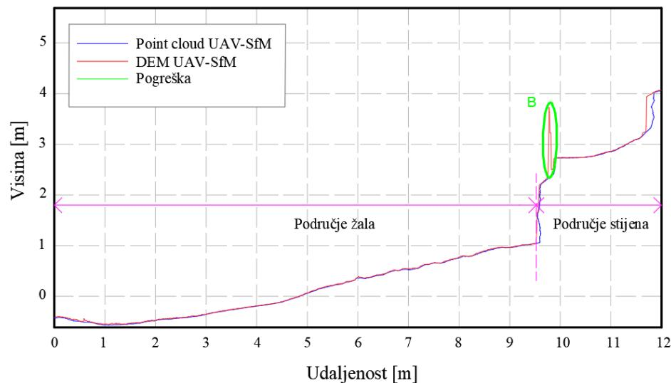
Slika 90: Prikaz presjeka 4 u AutoCAD-u, usporedba oblak točaka i DEM modela - metoda UAV-SfM
