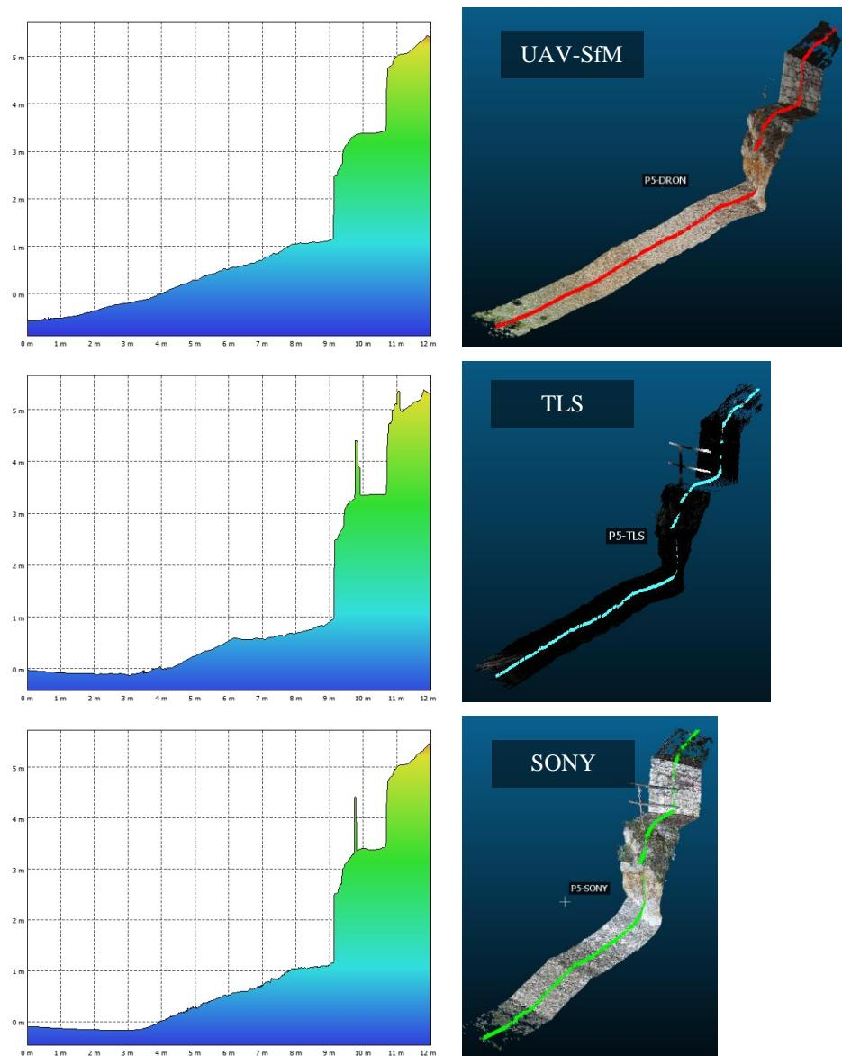
Slika 78: Prikaz poprečnog presjeka profila 5 iz DEM modela u *Agisoft Metashape* softveru
