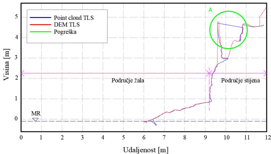
Slika 94: Prikaz presjeka 2 u AutoCAD-u, usporedba oblak točaka i DEM modela - metoda TLS
