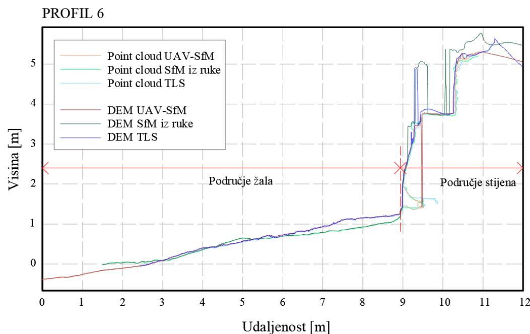
Slika 87: Prikaz poprečnih presjeka profila 6 u *AutoCAD* softveru
