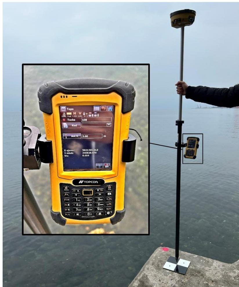
Slika 25: Prikaz mjerjenja koordinata kontrolnih točaka na terenu pomoću GPS-RTK uređaja
