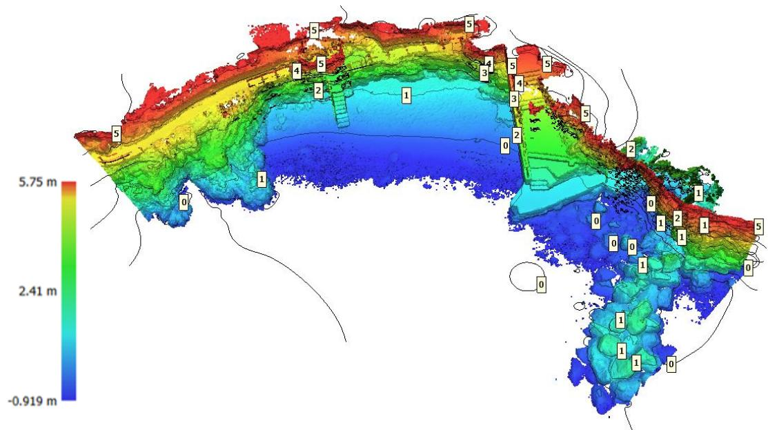
Slika 58: Prikaz DEM modela s konturama slojnika dobivenog UAV-SfM metodom
