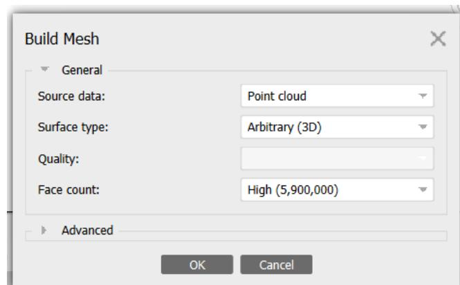
Slika 56: Parametri za generiranje mreže modela dobivenog TLS metodom
