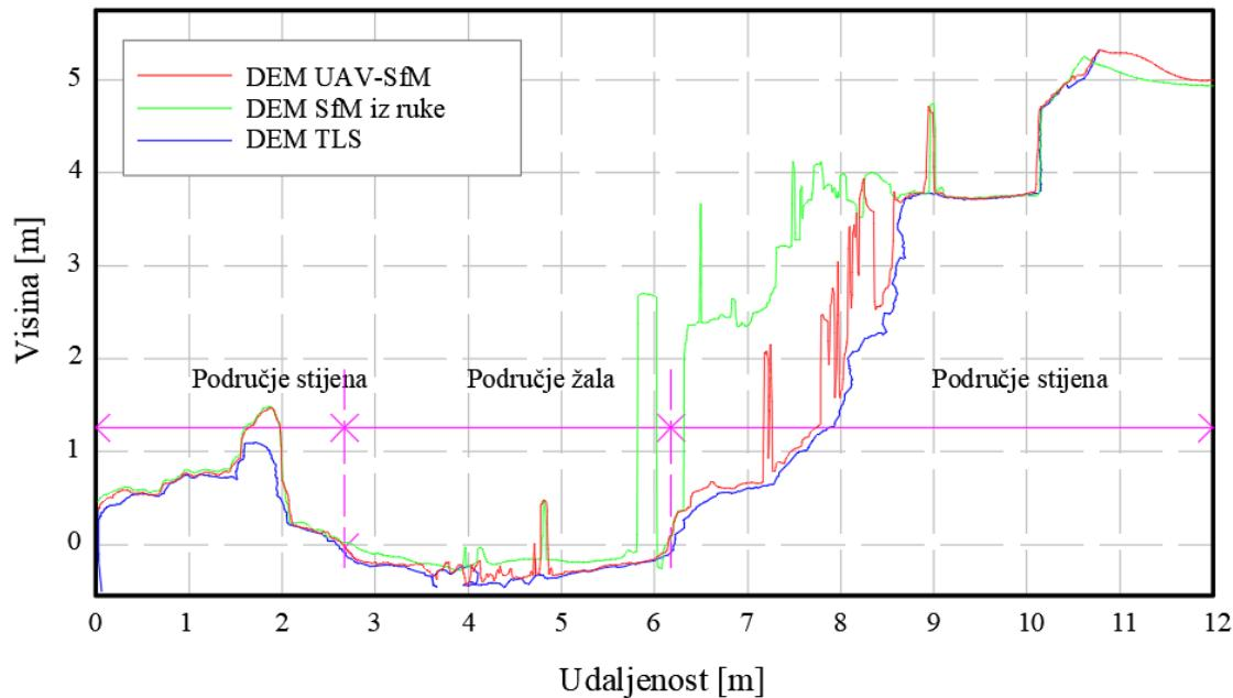
Slika 82: Prikaz poprečnih presjeka profila 1 u AutoCAD softveru – presjeci iz DEM-a
