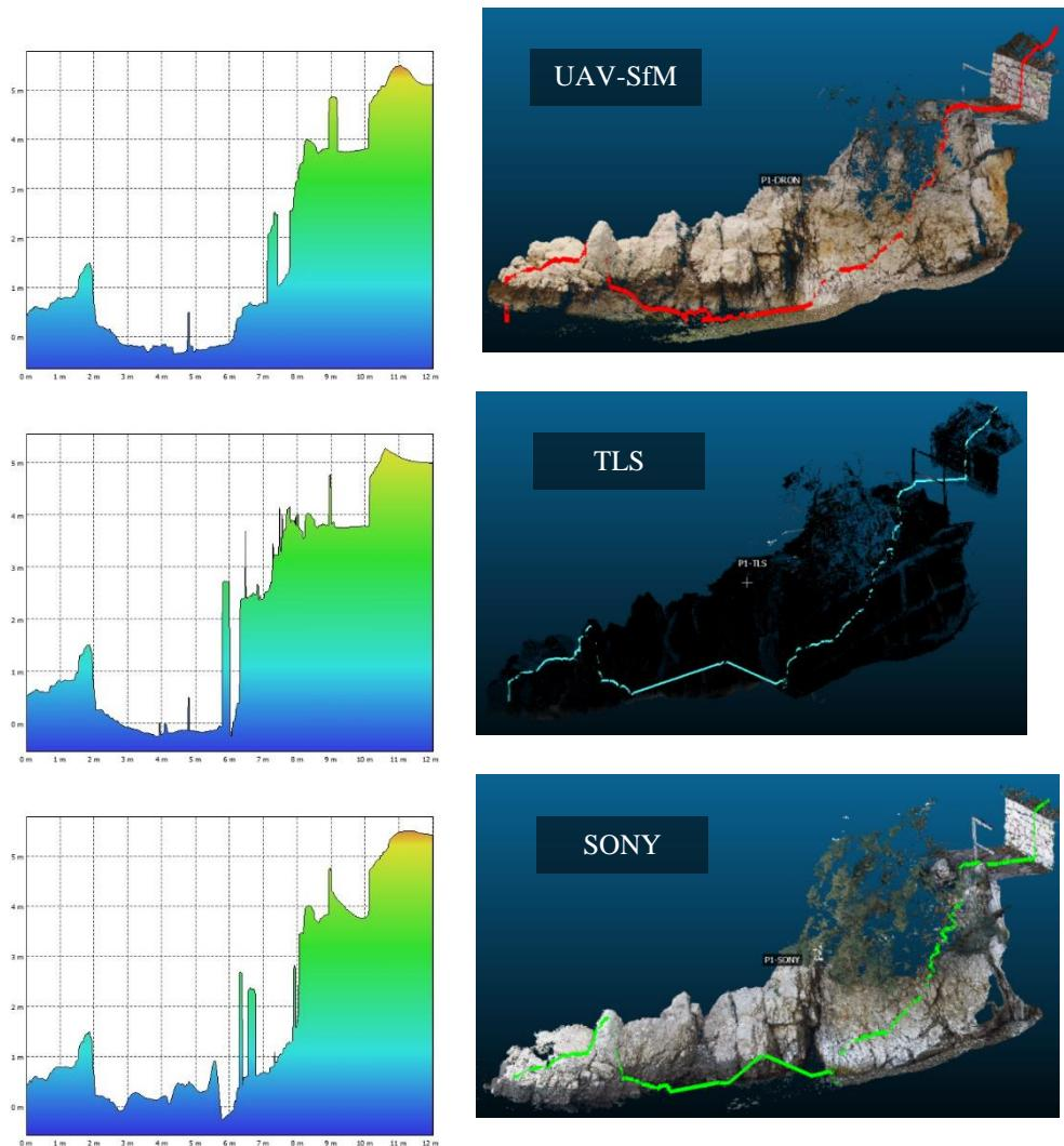
Slika 74: Prikaz poprečnog presjeka profila 1 iz DEM modela u *Agisoft Metashape* softveru
