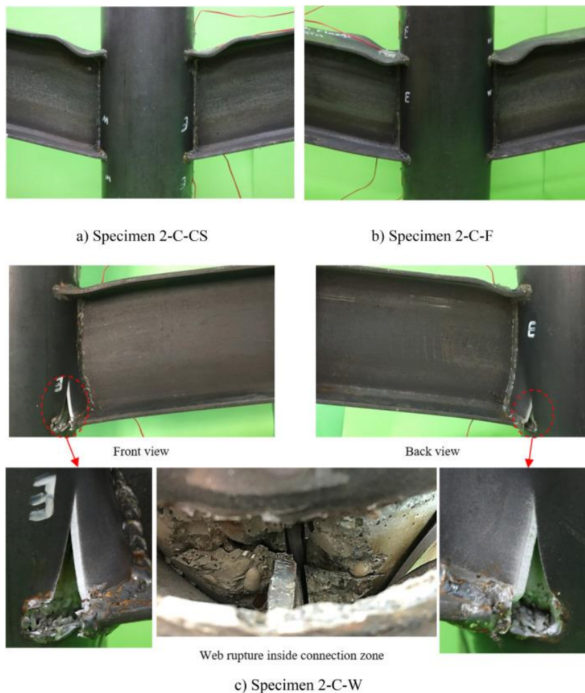
Slika 56. Primjer plastičnog deformiranja [14]
