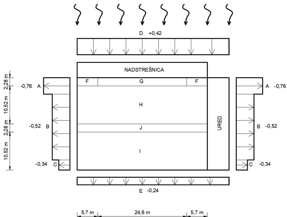
Slika 15. Prikaz opterećenja na vertikalne zidove izložene djelovanju transverzalnog vjetra ( $\theta = 0^\circ$ ) za Slučaj 2 - tlocrt. Modificirano prema [5]
