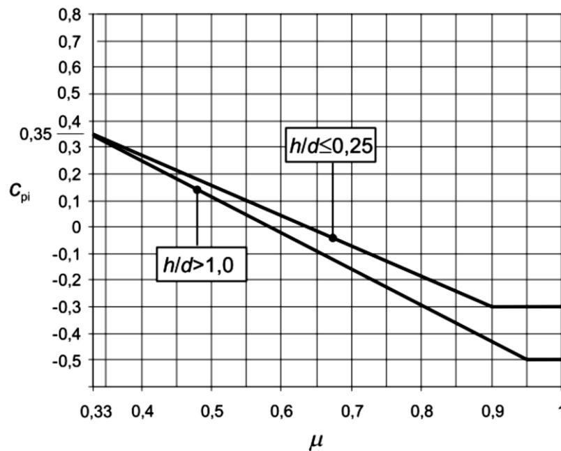
Slika 22. Koeficijenti unutarnjeg pritiska za jednoliko raspodijeljene otvore [5]
