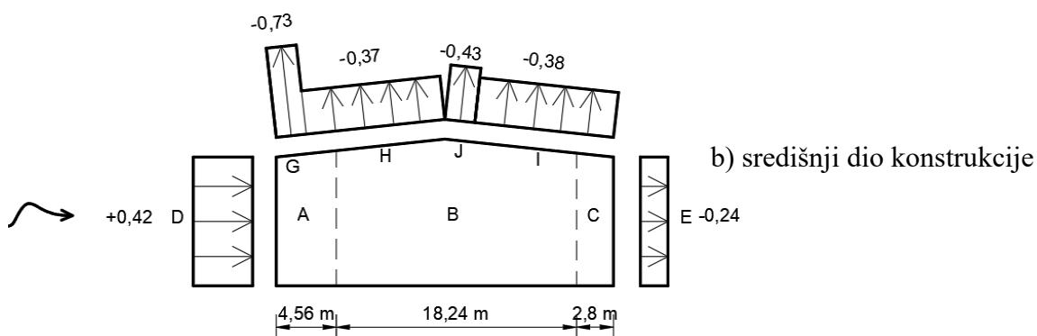
Slika 16. Prikaz opterećenja na vertikalne zidove i krovnu plohu izloženih djelovanju transverzalnog vjetra ( $\theta = 0^\circ$ ) za Slučaj 2 - presjek (I. slučaj). Modificirano prema [5]
