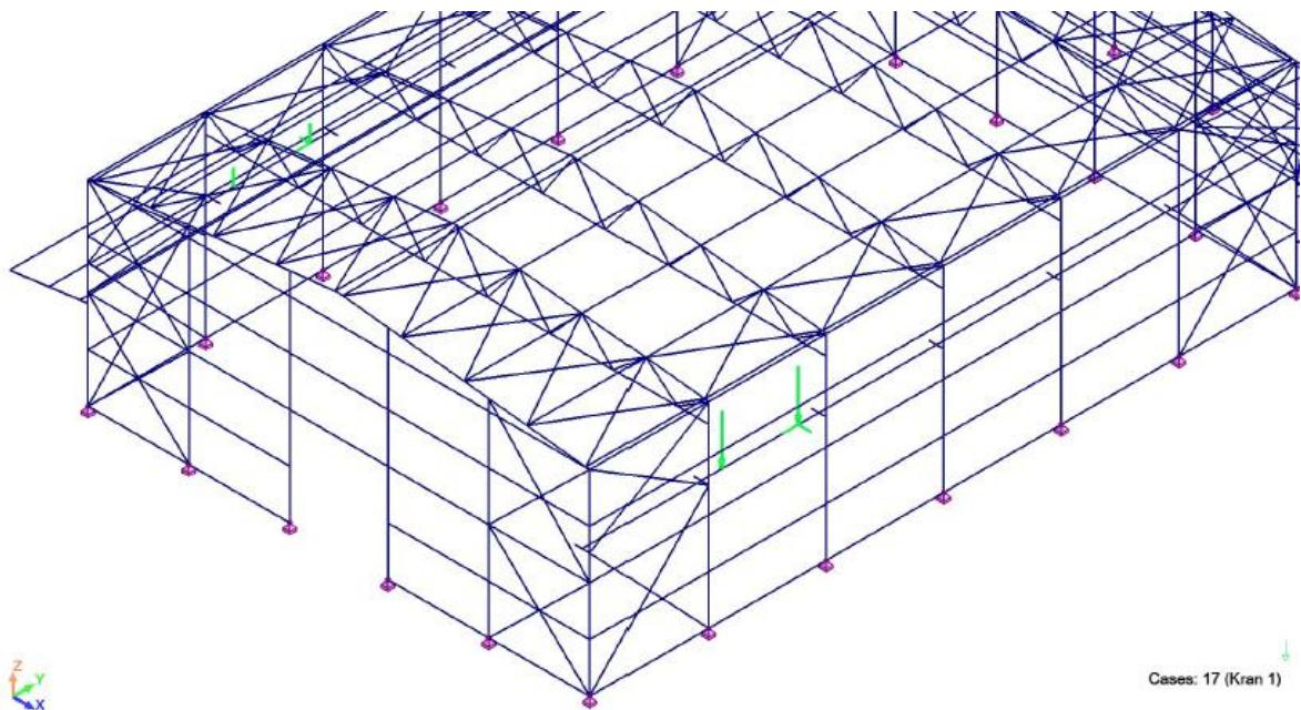
Slika 56. Položaj krana 1 – sile kotača nalaze se između dva glavna nosača – maksimalne sile desno, minimalne lijevo [izradio autor]
