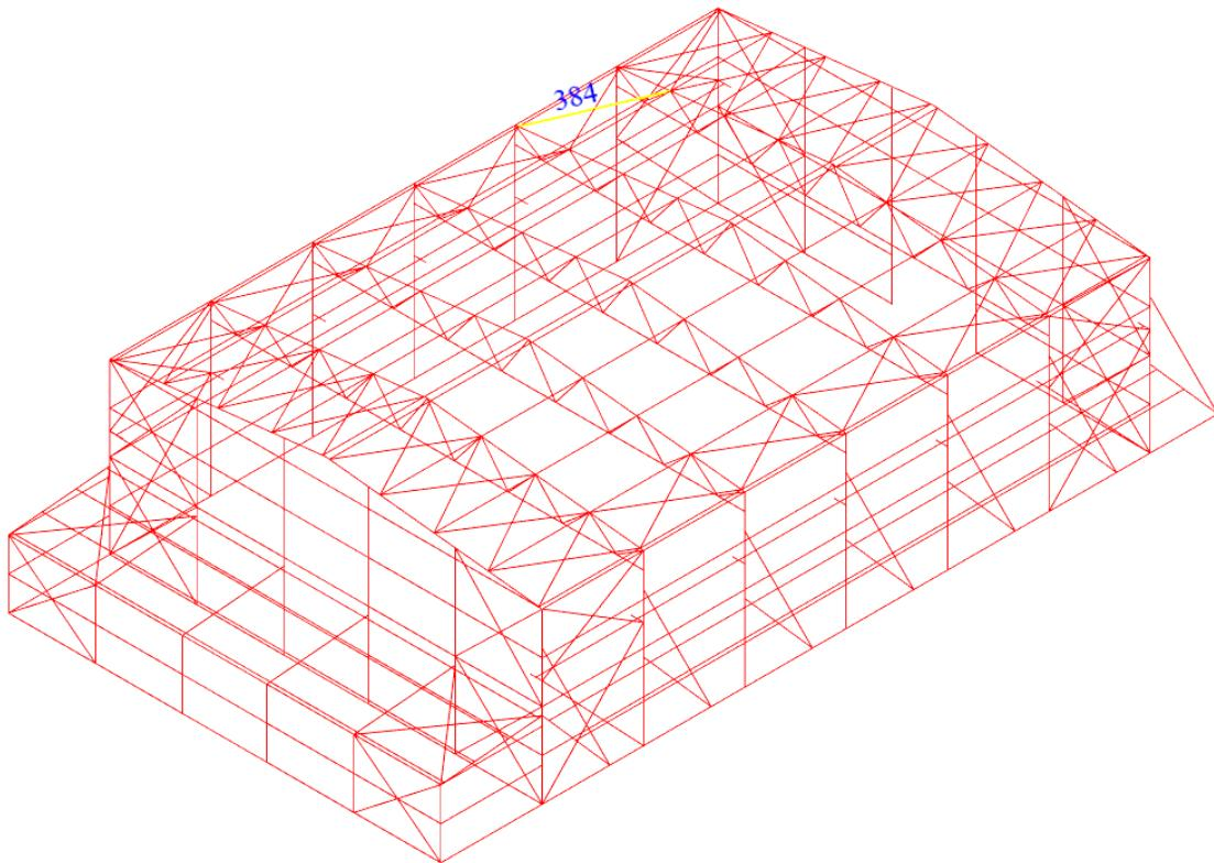
Slika 75. Položaj krovnog uzdužnog vjetrovnog veza mjerodavnog za dimenzioniranje - element 384
