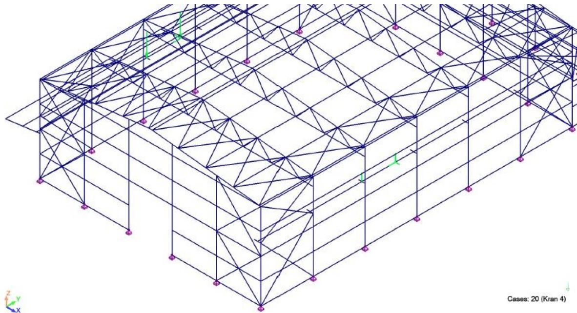
Slika 59. Položaj krana 4 – sila kotača nalazi se na osi glavnog nosača – minimalne sile desno, maksimalne lijevo [izradio autor]
