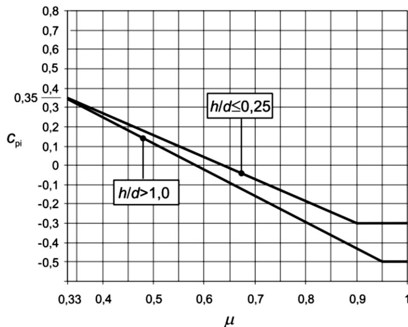
Slika 14. Koeficijenti unutarnjeg pritiska za jednoliko raspodijeljene otvore [5]
