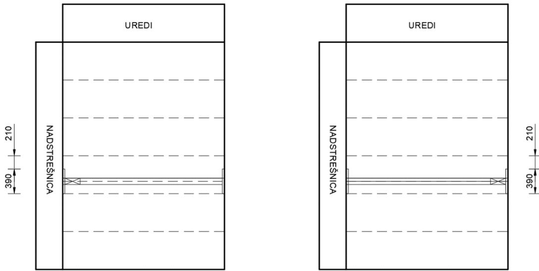
Slika 33. Položaj broj 1 i 2 (kotač krana nalaze se u osi glavnog nosača) [izradio autor]
