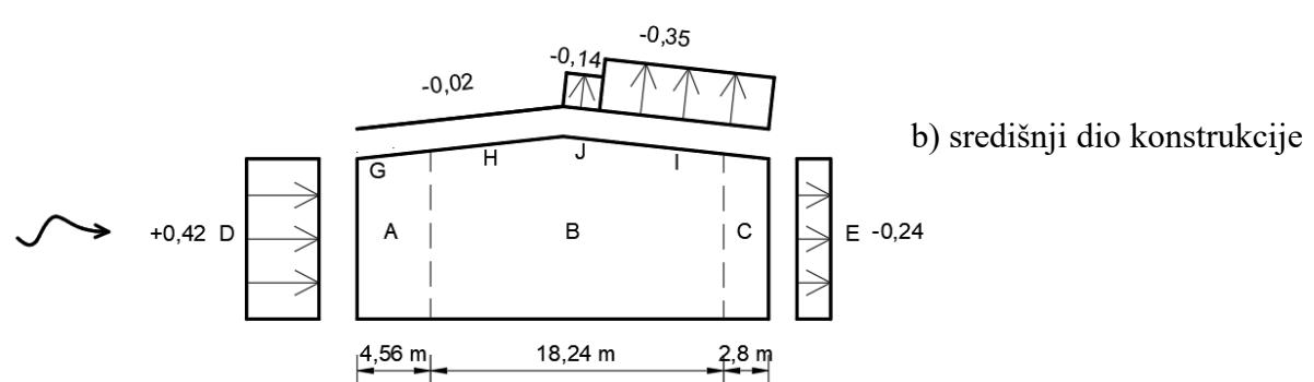
Slika 17. Prikaz opterećenja na vertikalne zidove i krovnu plohu izloženih djelovanju transverzalnog vjetra ( $\theta = 0^\circ$ ) za Slučaj 2 - presjek (II. slučaj). Modificirano prema [5]
