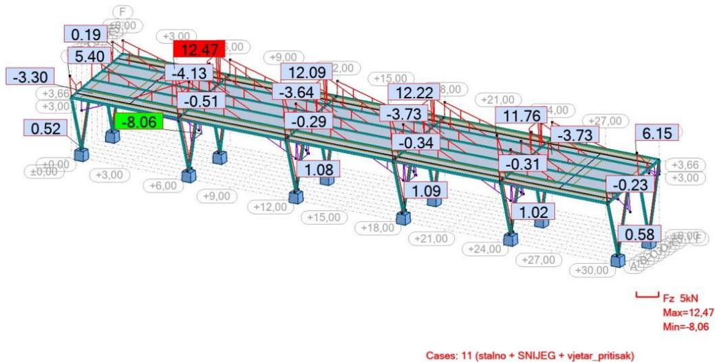
Slika 34: Prikaz vrijednosti dijagrama poprečnih sila (kN) [3]
