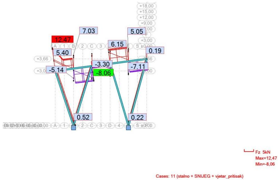
Slika 30: Prikaz vrijednosti dijagrama poprečnih sila (kN) [3]
