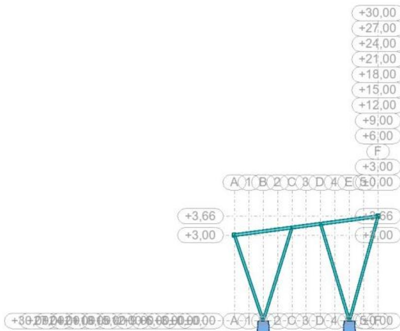
Slika 12. Poprečni presjek nadstrešnice u programu Robot Structural Analysis Professional
