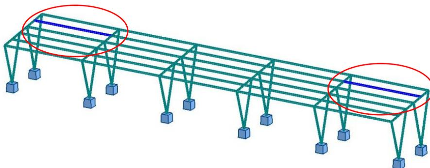
Slika 42: Položaj kritičnih sekundarnih nosača na konstrukciji nadstrešnice [3]
