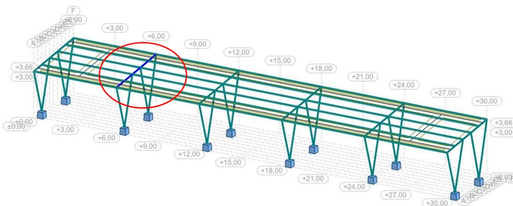
Slika 37: Prikaz kritičnog glavnog nosača na konstrukciji nadstrešnice [3]
