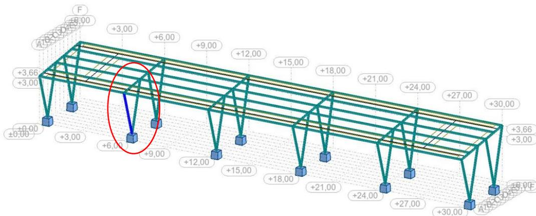
Slika 47. Prikaz kritičnog stupa na konstrukciji nadstrešnice [3]
