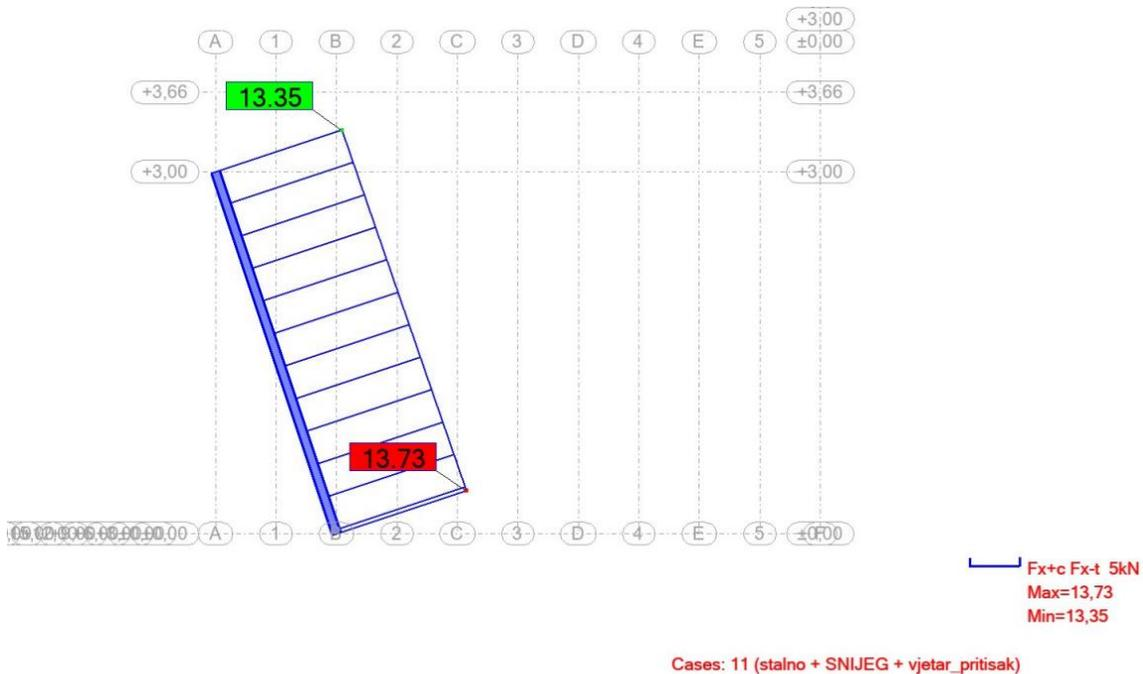
Slika 50. Dijagram uzdužnih sila na kritičnom stupu konstrukcije nadstrešnice [3]
