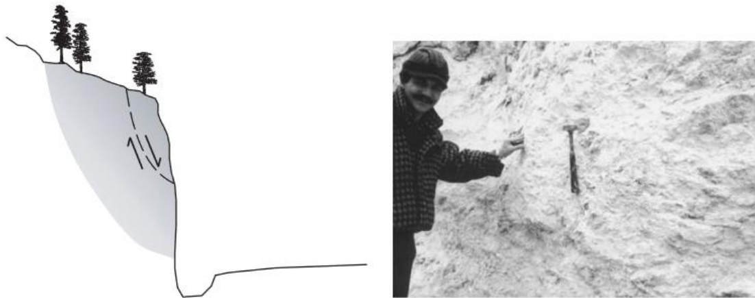
Slika 6. Plitki slom u slaboj stijenskoj masi bez diskontinuiteta [2]
