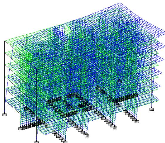
Slika 33. Prvi ton - translacija zgrade X smjeru ( $T=0,48\text{s}$ )
