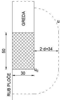
Slika 29. Model za provjeru nosivosti na probaj s kontrolnim presjecima
