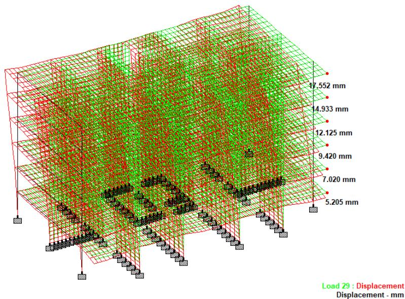
Slika 35. Katni pomak konstrukcijskog sustava prouzročen potresnim djelovanjem
