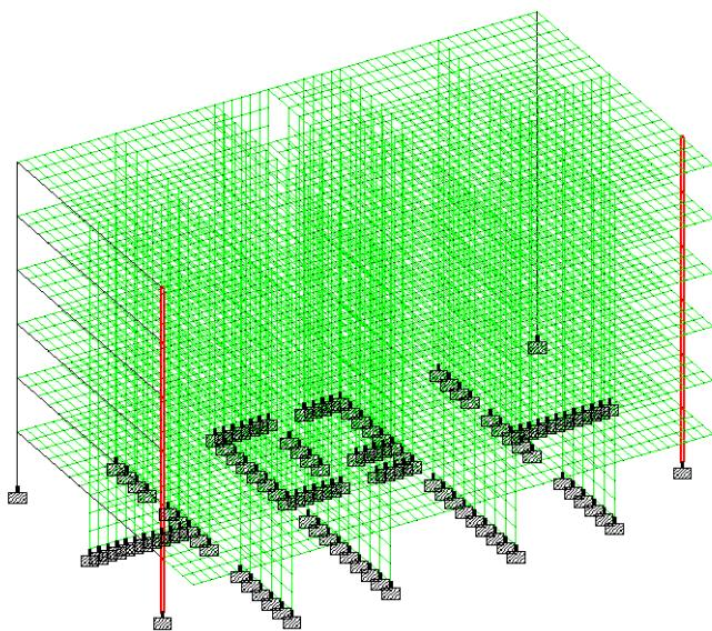
Slika 26. Rubni stupovi za kontrolu nosivosti na proboj
