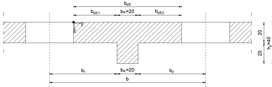
Slika 14. Poprečni presjek središnje grede POZ. 110
