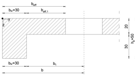
Slika 15. Poprečni presjek rubne grede POZ. 107
