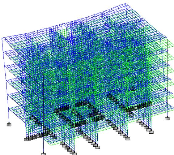
Slika 34. Treći ton - translacija zgrade Z smjeru ( $T=0,25\text{s}$ )
