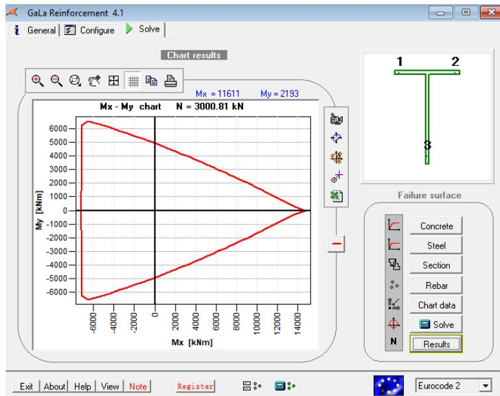
Slika 47. Provjera nosivosti presjeka za odabranu armaturu
