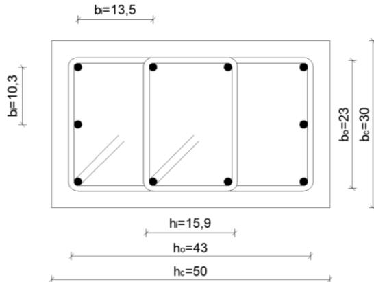
Slika 59. Poprečni presjek stupa i raspored armature
