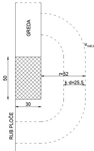
Slika 30. Kontrolni opseg  $u_{out,ef}$  kod kojega poprečna armatura nije potrebna
