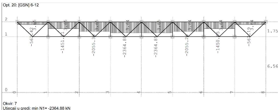
Slika 26. Dijagrami uzdužnih sila gornjeg pojasa – okvir 7 (Tower 8 Professional)
