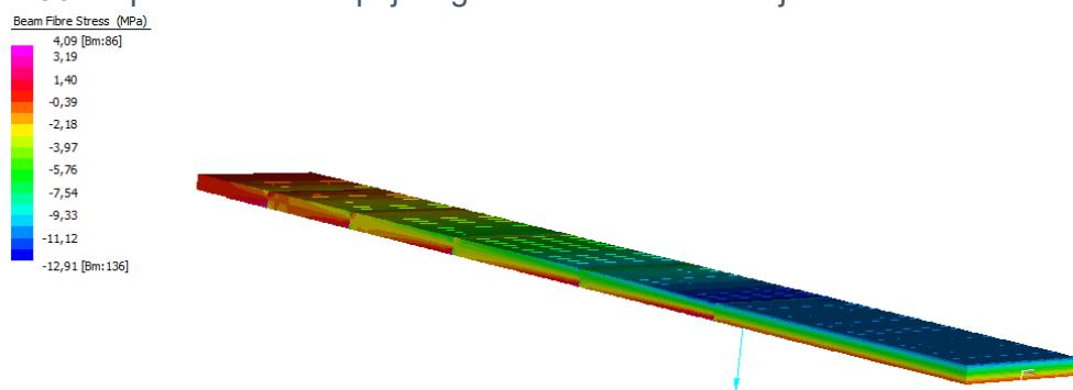
Slika 57. Naprezanja u betonskom dijelu grede B1 za kombinaciju vlastita težina + sila – model 2
