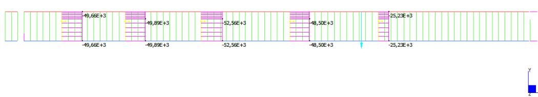
Slika 52. Poprečne sile na spajala grede B1 za kombinaciju vlastita težina + sila – model 1
