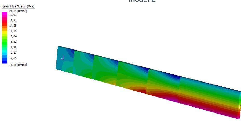
Slika 58. Naprezanja u drvenom dijelu grede B1 za kombinaciju vlastita težina + sila – model 2
