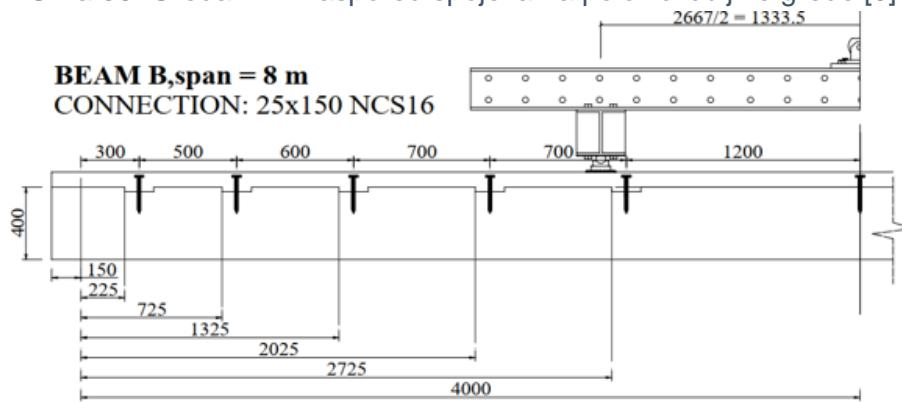
Slika 37. Greda B1 – rasporedi spojeva na polovici duljine grede [9]
