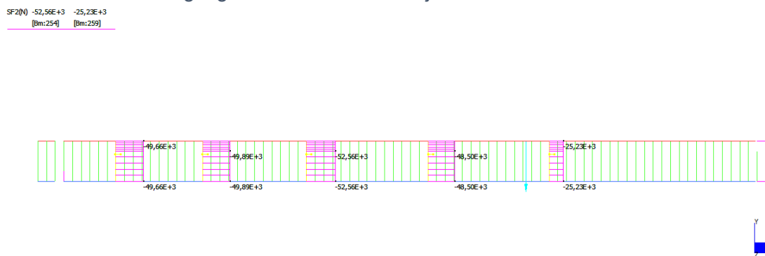
Slika 52. Poprečne sile na spajala grede B1 za kombinaciju vlastita težina + sila – model 1
