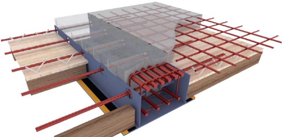
e) Patentirani sustavi sprezanja za TCC stropne konstrukcije
