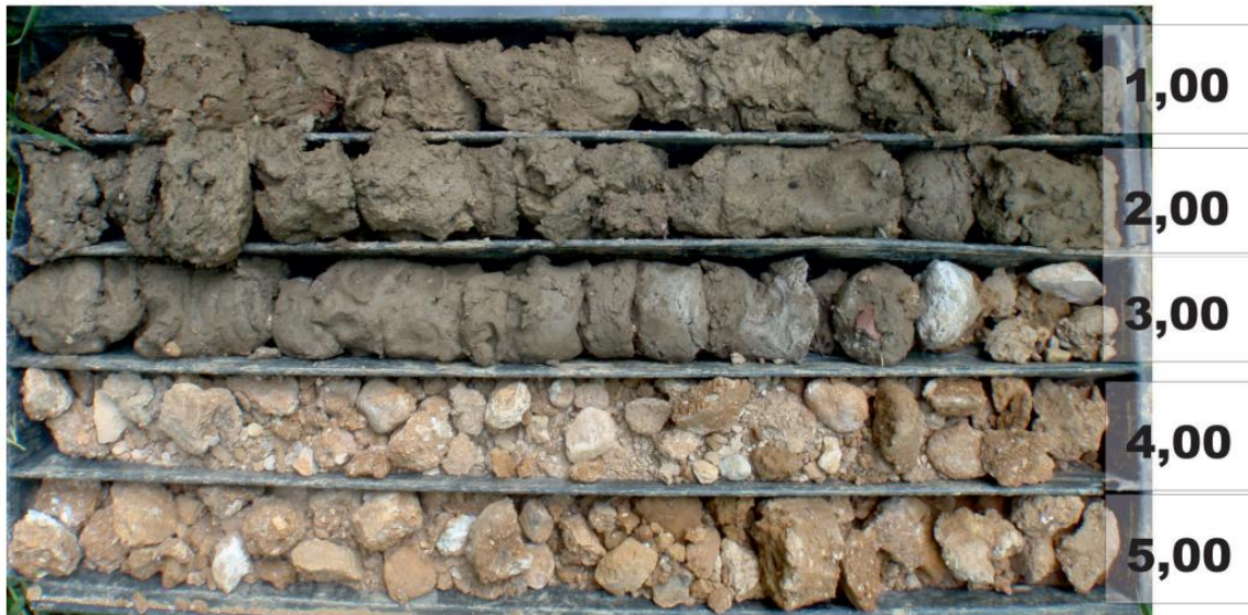
Slika 12. Jezgra bušotine B-4 (Geotehnički elaborat, 2014)
