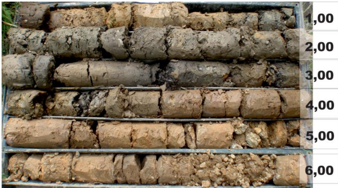
Slika 11. Jezgra bušotine B-3 (Geotehnički elaborat, 2014)
