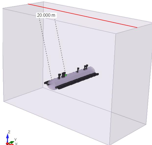
*Slika 8. Točka u kaloti tunela (zelena oznaka) za koju je prikazan razvoj vertikalnih i horizontalnih pomaka i profil na površini terena (crvena linija) za prikaz slijeganja površine terena s napredovanjem iskopa u 3D modelu*
