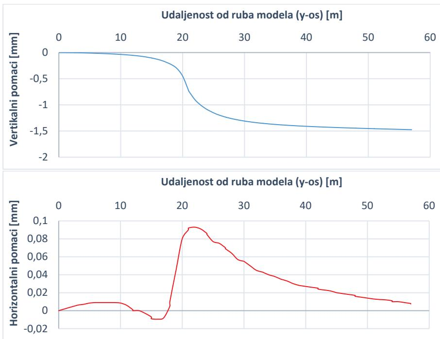
**Slika 9.** Vrijednosti vertikalnih (gore) i horizontalnih (dolje) pomaka točke u kalotni tunela s napredovanjem iskopa u 3D modelu
