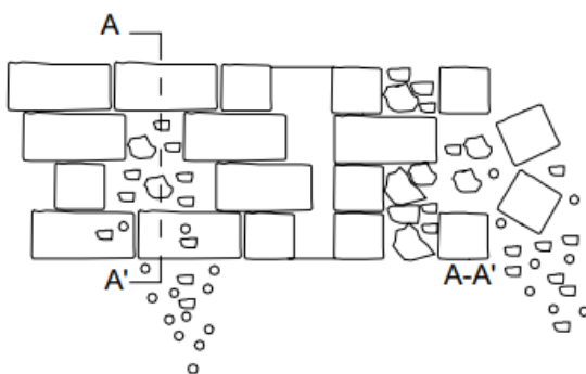
Slika 21. Lokalni slom zida: shema [2], primjer [10]
