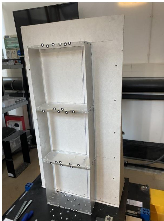
Slika 26. Uctavani pomaci na gipskartonskoj konstrukciji
